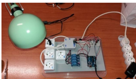
Σχήμα 4.13: Λειτουργία “off” τρίτης πρίζας με χρήση αναλογικής φωτοαντίστασης.
