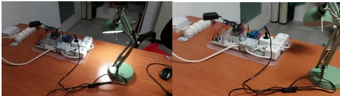
Σχήμα 4.9: Λειτουργία "on/off" πρώτης πρίζας με χρήση αισθητήρα κίνησης.
