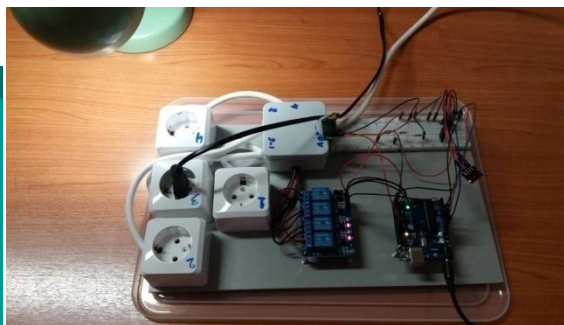
Σχήμα 4.14: Λειτουργία “on” τρίτης πρίζας με χρήση εικονικού διακόπτη.
