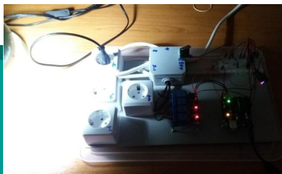
Σχήμα 4.13: Λειτουργία “on” τρίτης πρίζας με χρήση αναλογικής φωτοαντίστασης.
