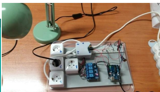
Σχήμα 4.13: Λειτουργία “off” τρίτης πρίζας με χρήση εικονικού διακόπτη.
