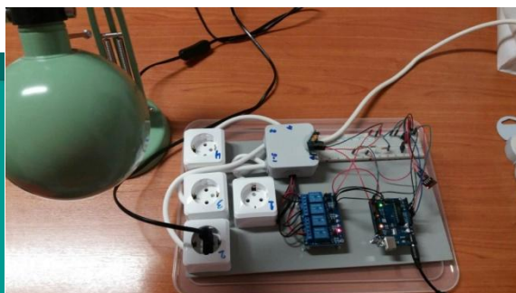
Σχήμα 4.11: Λειτουργία “off” δεύτερης πρίζας με χρήση εικονικού διακόπτη.
