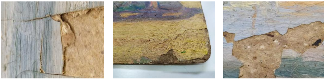
Εικόνα 26: Παραδείγματα φθορών των υποστηριγμάτων από χαρτόνι και hardboard: απώλειες, αποκολλήσεις, δίκτυα ρωγματώσεων. Πηγή: Αρχείο Γεροδημητρίου Μαρία – Καλαντζοπούλου Άννα.
