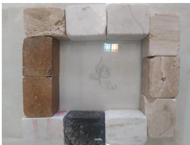
Εικ. 49 Επιπεδοποίηση του αντιγράφου του σχεδίου Λ2 με τη μέθοδο Hard-soft-sandwich
