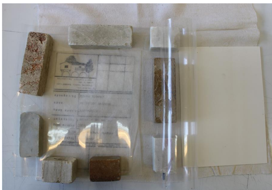
Εικ. 47 Ύγρανση του σχεδίου T1 με τη χρήση υγρασμένου στυπόχαρτου
