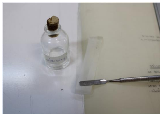
Εικ. 32 Απομάκρυνση της αυτοκόλλητης ταινίας με την χρήση σπάτουλας, σε συνδυασμό με ακετόνη
