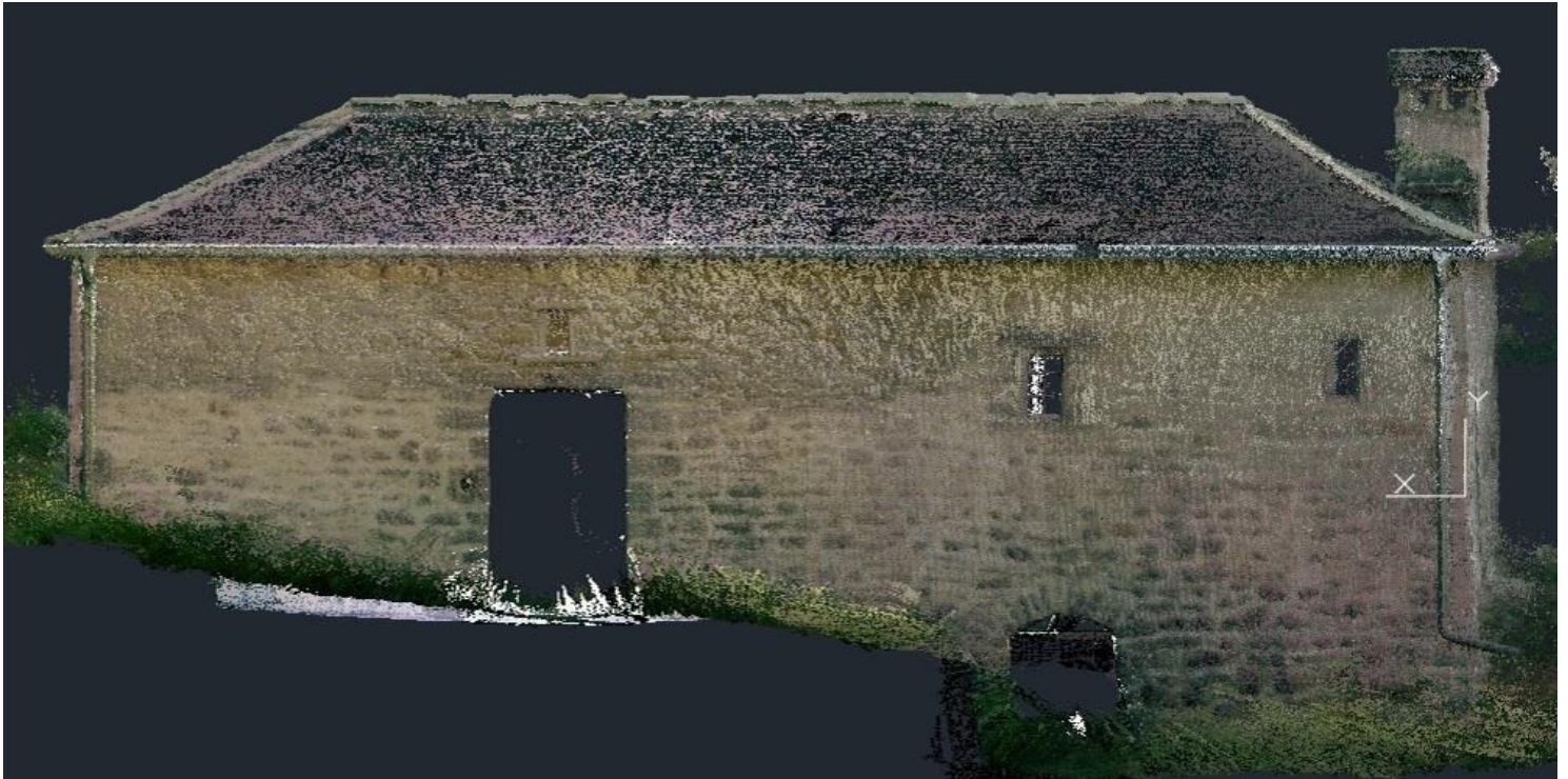
Εικόνα 8.1.3: Το κόψιμο της επιφάνειας της εικόνας 8.1.2 σε περιβάλλον όψης, με απομονωμένη πλέον την επιφάνεια ενδιαφέροντος για την σχεδίαση της δυτικής όψης του νερόμυλου
