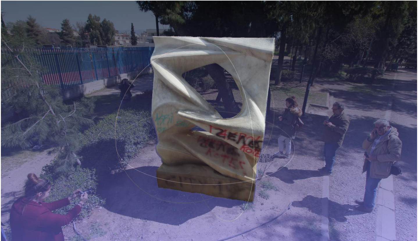
Εικόνα 4.2.4: Σαρωμένο μοντέλο με απόδοση φωτοϋφής τοποθετημένο στο περιβάλλον της φωτογραφίας (Γεωμετρική τεκμηρίωση του έργου «Εγκιβωτισμένη Έκρηξη». Αιγάλεω 2019, προσωπικό αρχείο)
