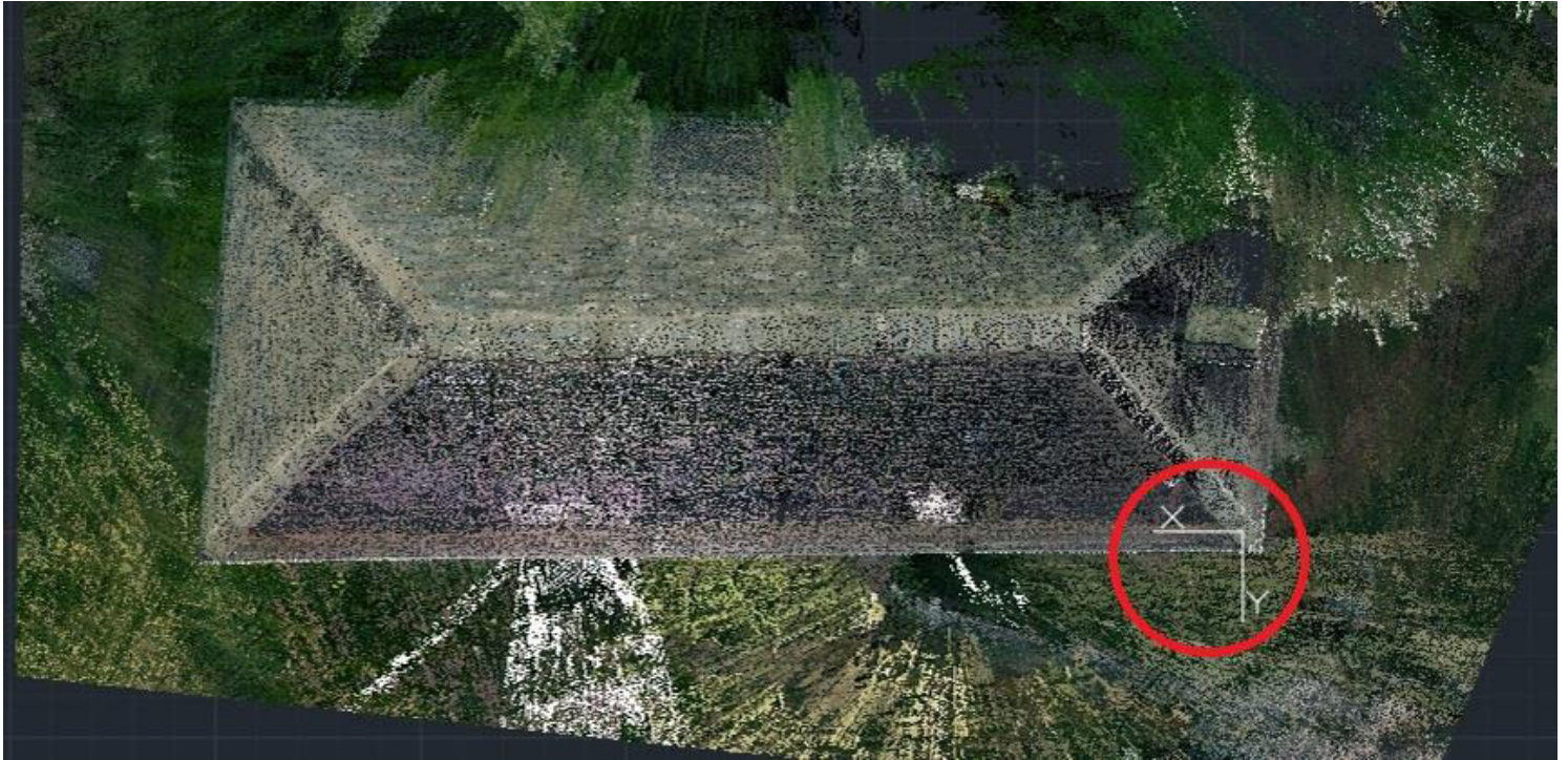
Εικόνα 8.1.1: Ορισμός αξόνων επί του δυτικού τοίχου με σκοπό την σχεδίαση της όψης του
