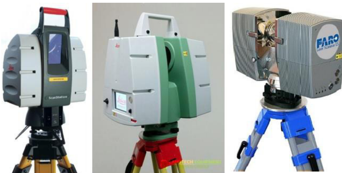
Εικόνα 3.2.1: Επίγειοι Σαρωτές Laser παλαιότερης γενιάς κυκλοφορίας 2007-2010 α) Leica ScanStation 2 β) Leica ScanStation C10 γ) FARO Photon
