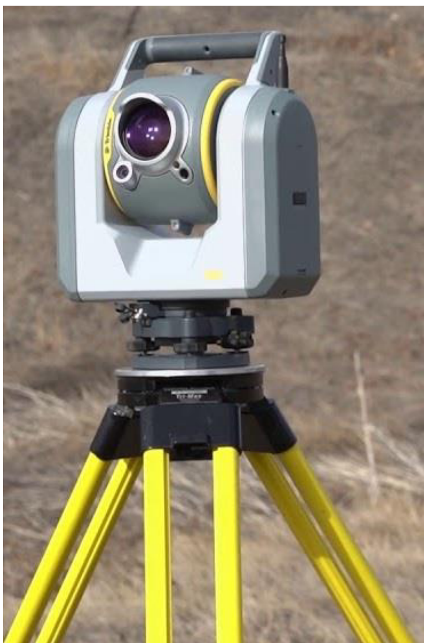
Εικόνα 4.2.5: Ο ΟΓΣ και επίγειος σαρωτής laser Trimble SX12 (πηγή: https://geospatial.trimble.com/products-and-solutions/trimble-sx12 )
