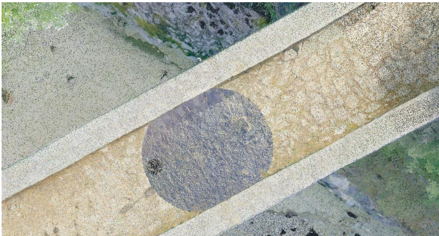
Εικόνα 7.1.2: «Τρύπα» μειωμένης πληροφορίας στο τρισδιάστατο μοντέλο του γεφυριού λόγω στάσης επί του σημείου.
