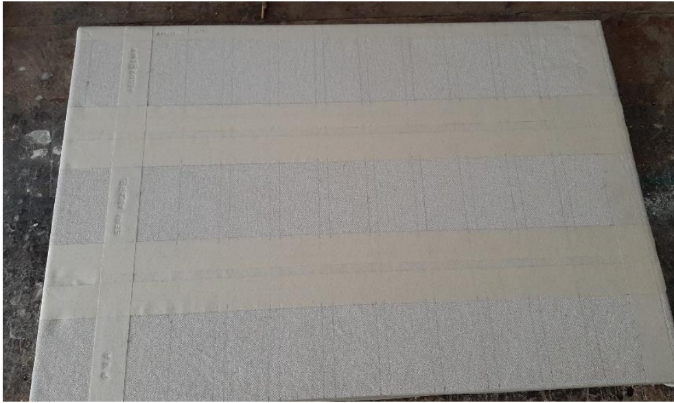
Εικόνα 12, Η προετοιμασία του δοκιμίου του καμβά με μόνωση και διαχωρισμό των περιοχών με χρήση μονωτικής αυτοκόλλητης ταινίας.
