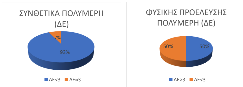
Σχήμα 13, 14 Στατιστικά διαγράμματα τιμών χρωματικής αλλοίωσης ΔE στα συνθετικά (αριστερά) και στα φυσικής προέλευσης πολυμερή (δεξιά).
