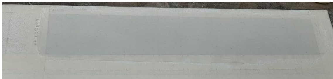
Εικόνα 15, Στρώση απορροφητικής προετοιμασίας αμέσως μετά την εφαρμογή.
