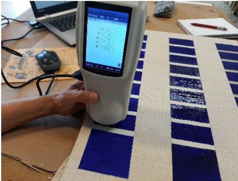
Εικόνα 43, Λήψη μετρήσεων χρωματομετρίας στο δοκίμιο του μουςαμά.
