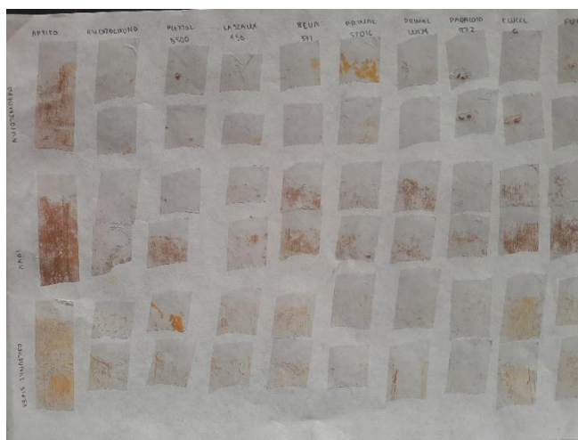
Εικόνα 56, Αποτελέσματα Scotch Tape Test στο δοκίμιο της εικόνας.
