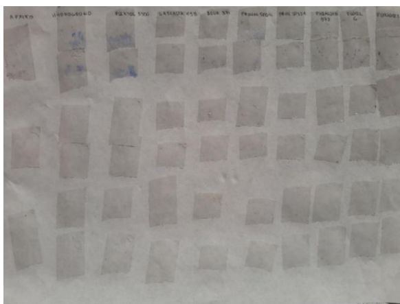
Εικόνα 52, Αποτελέσματα Scotch Tape Test στο δοκίμιο του μουσαμά.
