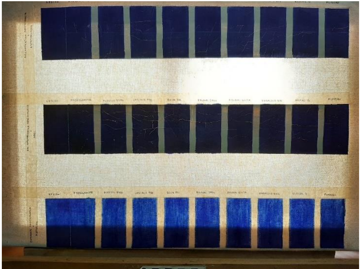
Εικόνα 29, Δοκίμιο μουςαμά μετά την δημιουργία φθορών (φωτογράφιση με διερχόμενο φωτισμό).
