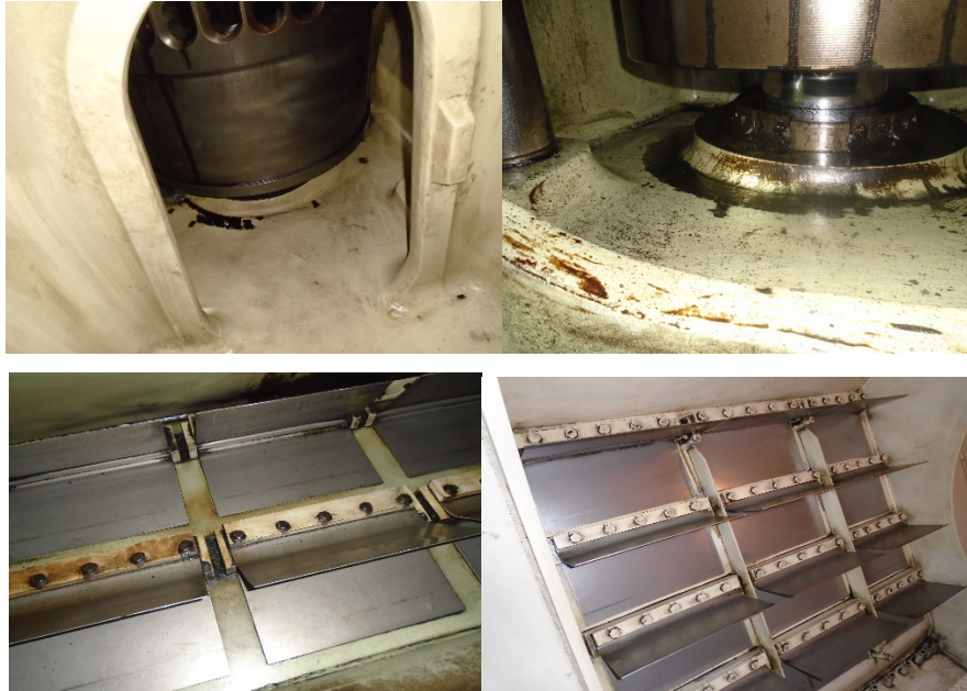
Εικόνα 21. Χώρος (οχετός) αέρα Σαρώσεως μετά τον καθαρισμό του [Πηγή: Προσωπικό αρχείο συγγραφέα]
