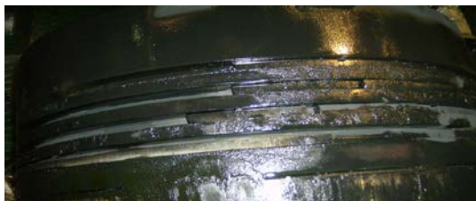
Εικόνα 36. Σπάσιμο/Κατάρρευση (Breakage/Collapse) ελατηρίων εμβόλου [Πηγή: Προσωπικό αρχείο συγγραφέα]
