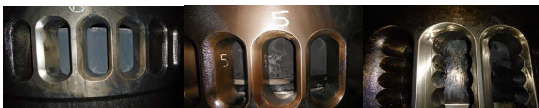
Εικόνα 38. Έλεγχος κεφαλής του εμβόλου του κυλίνδρου.
