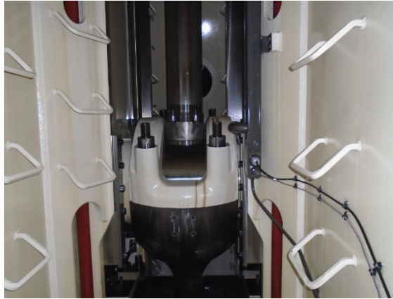
Εικόνα 49. Ζυγώμα δίχρονης αργόστροφης ναυτικής πετρελαιομηχανής [Πηγή: Προσωπικό αρχείο συγγραφέως]
