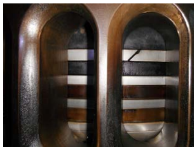
Εικόνα 31. Κατάσταση ελατηρίων εμβόλου για επιθεώρηση [Πηγή: Προσωπικό αρχείο συγγραφέα]
