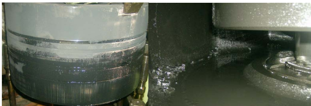
Εικόνα 37. Διαρροή αέρα/καυσαερίων (Blow-by) ελατηρίων εμβόλου [Πηγή: Προσωπικό αρχείο συγγραφέα]
