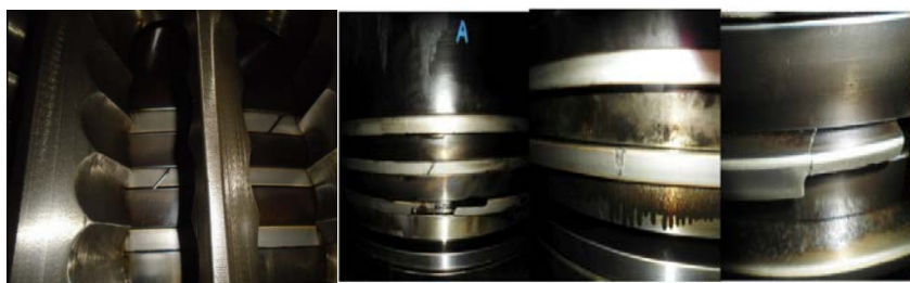
Εικόνα 43. Κατάσταση δεύτερου ελατηρίου σε νεότερες εκδόσεις μηχανών (με τρία ελατήρια εμβόλου)
