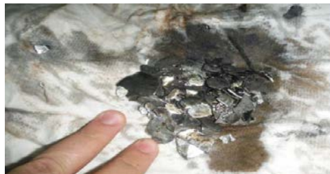
Εικόνα 50. Κομμάτια επίστρωσης λευκού μετάλλου από φθορά εδράνου ζυγώματος [Πηγή: Προσωπικό αρχείο συγγραφέως]
