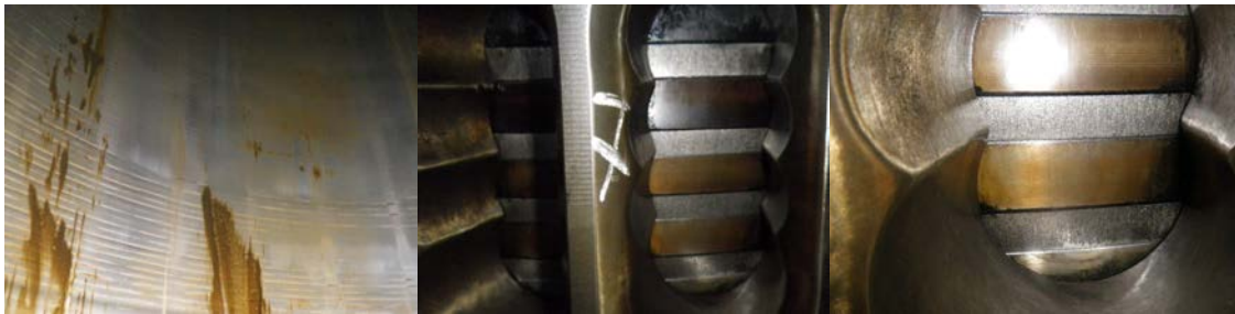
Εικόνα 28. Φαινόμενο “Scuffing” στην εσωτερική επιφάνεια του χιτωνίου του κυλίνδρου [Πηγή: Προσωπικό αρχείο συγγραφέα]
