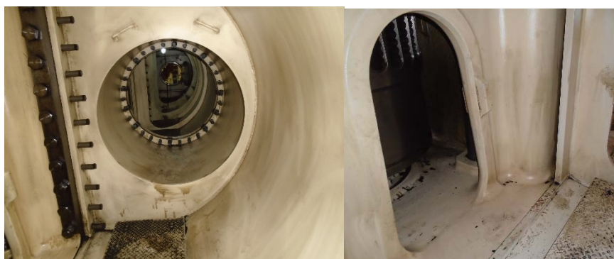
Εικόνα 20. Χώρος (οχετός) αέρα Σαρώσεως πριν τον καθαρισμό του [Πηγή: Προσωπικό αρχείο συγγραφέα]
