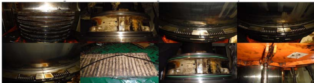
Εικόνα 45. Επιθεώρηση Stuffing Box κυλίνδρου
