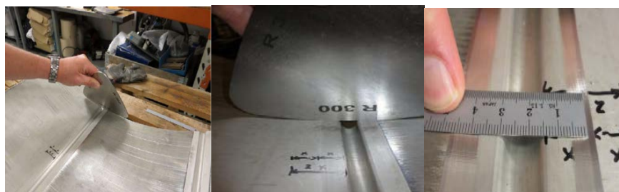
Εικόνα 52. Τροποποίηση άκρων εδράνων ζυγώματος
