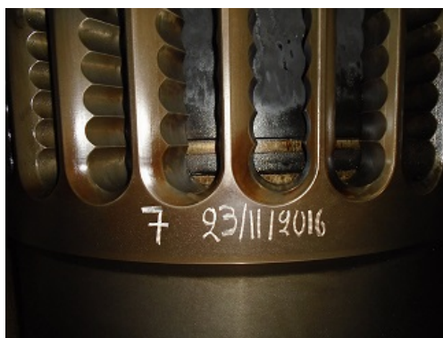
Εικόνα 23. Έμβολο κυλίνδρου στο κάτω νεκρό σημείο
