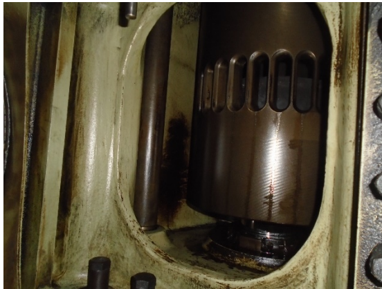
Εικόνα 25. Αποδεκτή κατάσταση εξωτερικής επιφάνειας του χιτωνίου του κυλίνδρου εντός του χώρου σαρώσεως πριν την επιθεώρηση [Πηγή: Προσωπικό αρχείο συγγραφέα]
