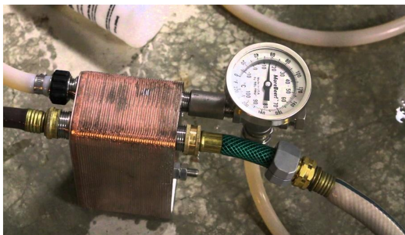
Εικόνα 9: Εναλλάκτης θερμότητας (brewhoppin.com)
