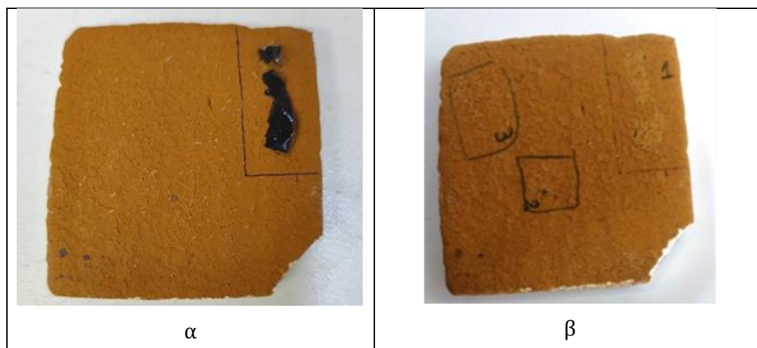
Εικόνα 4.3.5.7: Φωτογραφίες δοκιμίου ΣΤ κατά την εφαρμογή των νανομαγνητικών γελών (α) και μετά την απομάκρυνση τους απο την επιφάνεια (β) (προσωπικό αρχείο).
