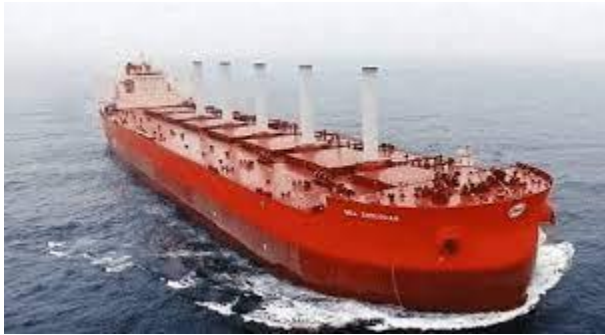
Εικόνα 19. Εφαρμογή Rotor Sails σε πλοίο Πηγή: Marine Insight
