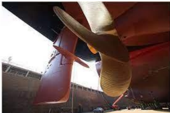
Εικόνα 14. Κατασκευή Thrust Fin
