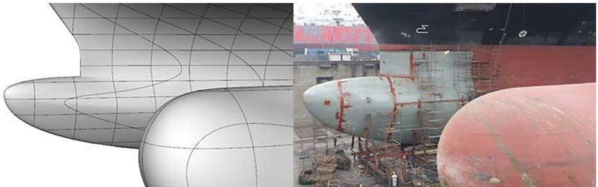
Εικόνα 8. Μετασκευή βολβού για βέλτιστη απόδοση
