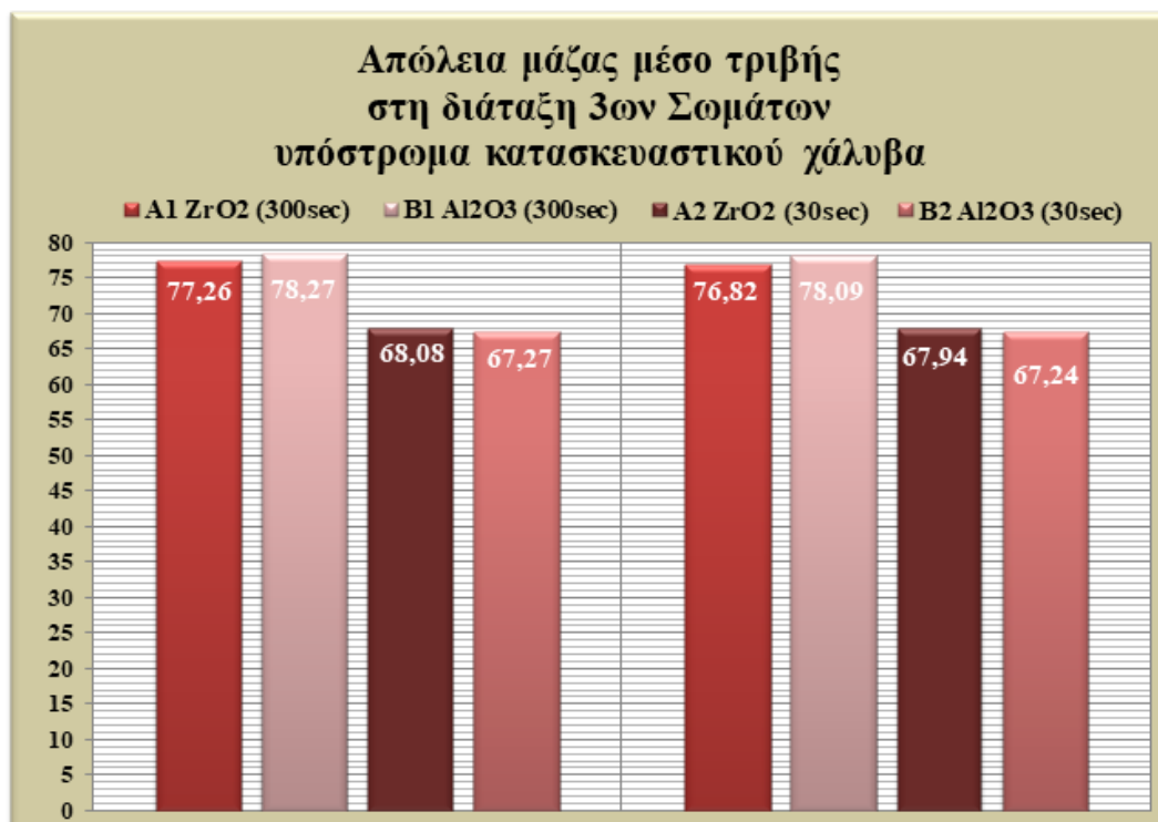
Διάγραμμα 23: Απεικόνιση διαφοράς μάζας πριν & μετά την δοκιμή τριβής για κάθε επικάλυψη.
