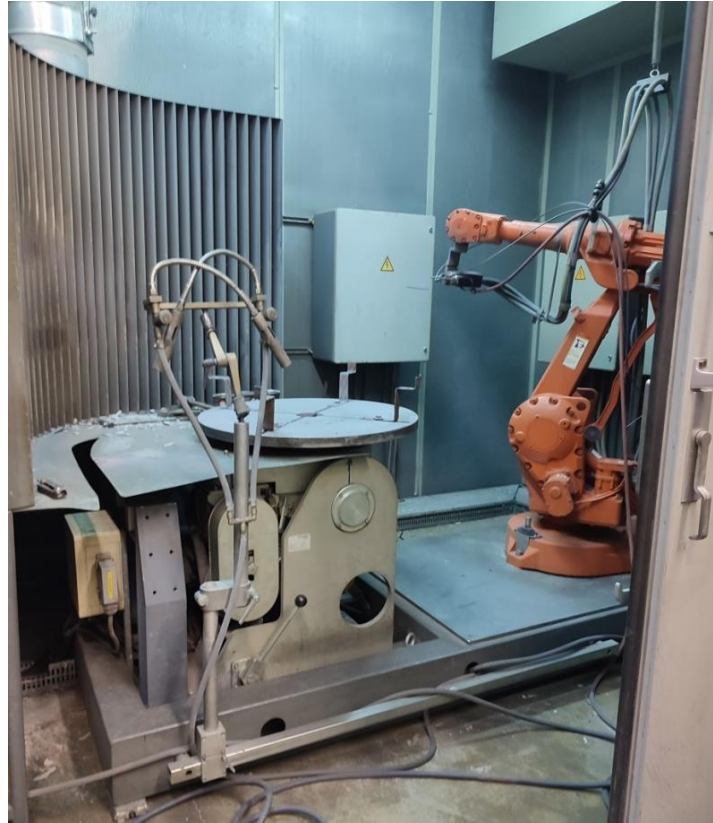
Εικόνα 8: Διάταξη Thermal Spray Machine SULZER METCO. [22]
