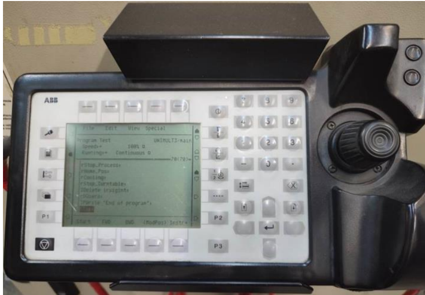
Εικόνα 12: Ηλεκτρονικό τηλεχειριστήριο του ρομποτικού βραχίονα και του Plasma Spray. [22]
