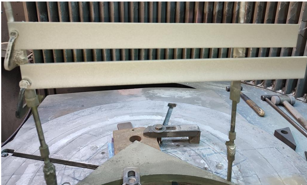
Εικόνα 16: Στήριξη βεργών κατά την προετοιμασία τους για ατμοσφαιρικό ψεκασμό πλάσματος με πούδρα Ζιρκονίας.
