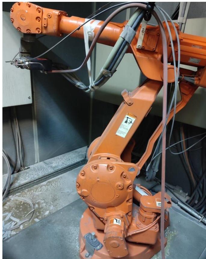
Εικόνα 9: Ρομποτικός Βραχίονας (Robot ELMO της εταιρείας ABB Robotics Sweden) για συγκράτηση και κίνηση του Injector. [22]
