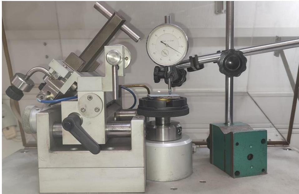
Εικόνα 20: Προετοιμασία δοκιμίων για την διαδικασία τριβής των δοκιμίων στη διάταξη (Pin-On-Disk).
