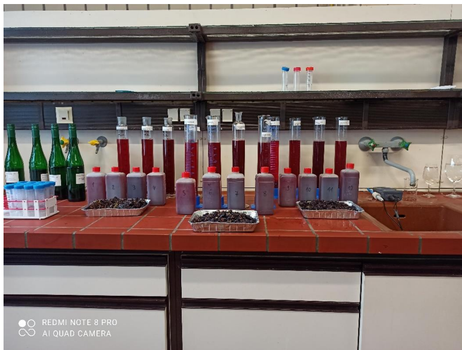
Εικόνα 8. Απεικόνιση των δειγμάτων των κλασμάτων στα δοχεία και στους κυλίνδρους και των πιεσμένων ραγών στα αλουμινένια κεσεδάκια
