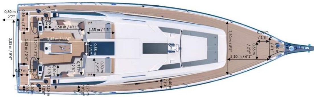
Εικόνα 60. Αποτύπωση διαστάσεων γάστρας και καταστρώματος [63]
