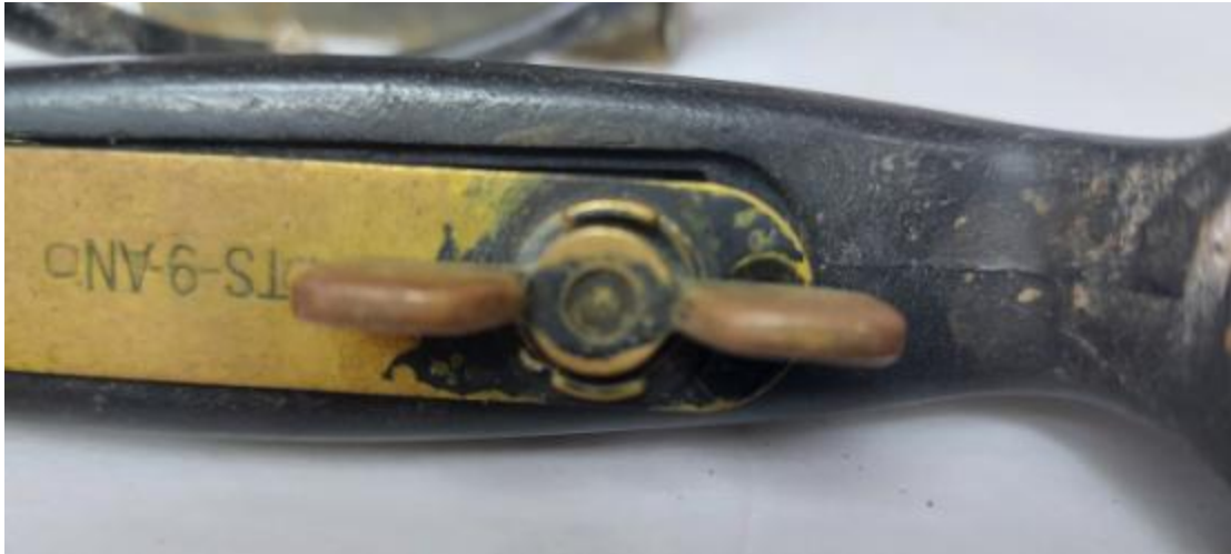
Εικ.4.18 Λεπτομέρεια από το χερούλι του ακουστικού. Ανοιχτόχρωμοι λεκέδες στην εσοχή δεξιά του μοχλοδιακόπτη, αδρή επιφάνεια ©Μουσείο ΕΥΔΑΠ, φωτογραφία Αλεξάνδρα Μπολότη
