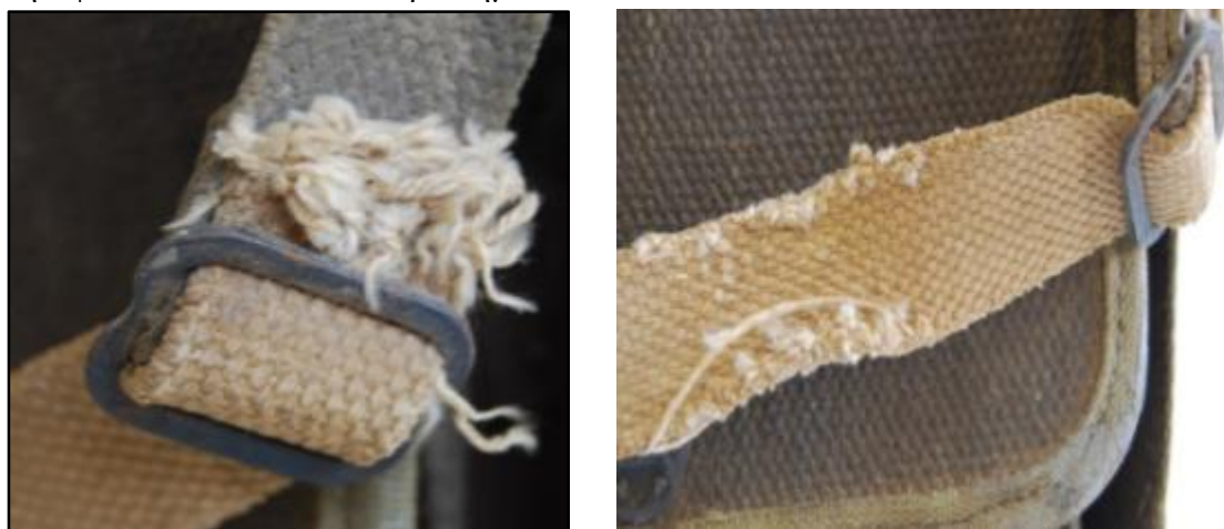
Εικ.4.15 Ιμάντας μεταφοράς, ελεύθερα υφάδια (αριστερά) και αποδυνάμωση ινών (δεξιά) ©Μουσείο ΕΥΔΑΠ, φωτογραφία Αλεξάνδρα Μπολότη
