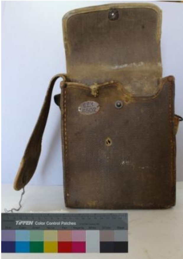
Εικ.4.9 Μπροστινή πλευρά. Στο εσωτερικό του καπακιού κάλυψης διακρίνεται σημαντική διαφοροποίηση χρώματος σε σχέση με την όψη (αριστερά) ©Μουσείο ΕΥΔΑΠ, φωτογραφία Αλεξάνδρα Μπολότη. Περίπτωση ενός τηλεφώνου πεδίου ΕΕ-8B που φέρει σχεδόν τον ίδιο βαθμό διαφοροποίησης (κάτω) © Henry Slede
