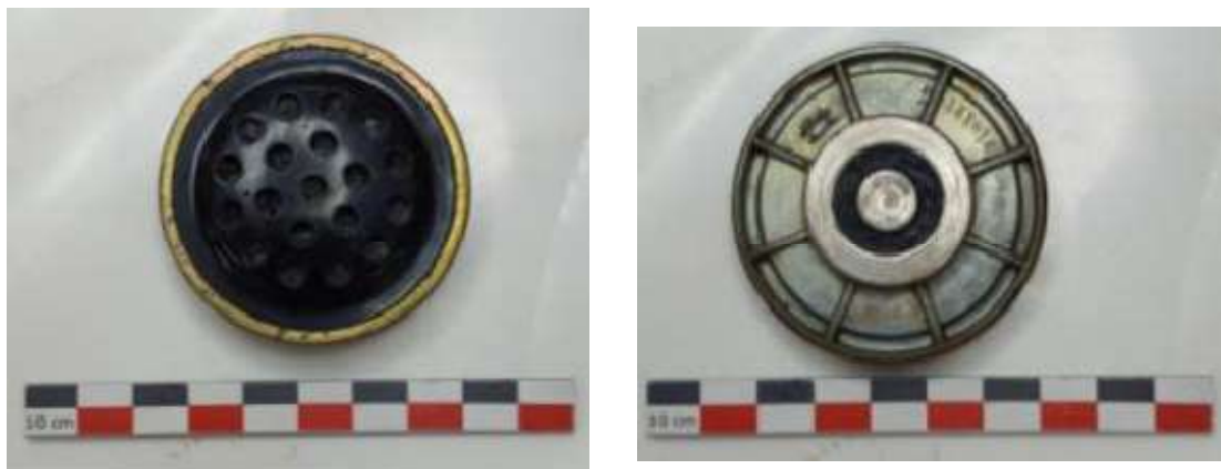
Εικ.5.15 Εσωτερικό τμήμα μικροφώνου. Εξωτερική όψη μικροφώνου (αριστερά). Εσωτερική όψη μικροφώνου (δεξιά) ©Μουσείο ΕΥΔΑΠ, φωτογραφία Αλεξάνδρα Μπολότη
