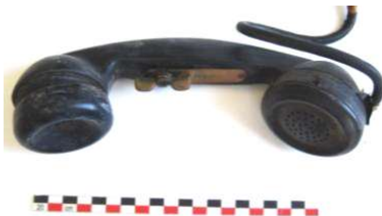
Εικ.4.3 Το ακουστικό της συσκευής. Αριστερά βρίσκεται το καπάκι κάλυψης του ακουστικού και δεξιά το καπάκι κάλυψης του μικροφώνου ©Μουσείο ΕΥΔΑΠ, φωτογραφία Αλεξάνδρα Μπολότη
