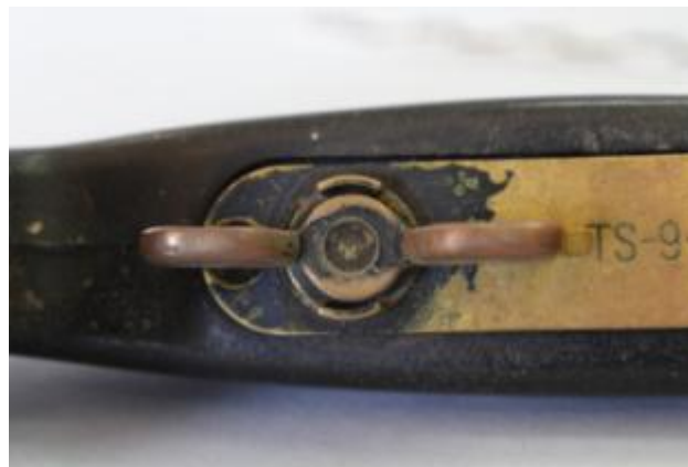
Εικ.4.21 Λεπτομέρεια από το μεταλλικό πλαίσιο και τον μοχλοδιακόπτη στο κέντρο του ακουστικού. Σχηματισμός προϊόντος διάβρωσης καφεκόκκινου χρώματος. Υπολείμματα επικαλυπτικού στρώματος μαύρης χρωστικής περιμετρικά του μοχλοδιακόπτη ©Μουσείο ΕΥΔΑΠ, φωτογραφία Αλεξάνδρα Μπολότη
