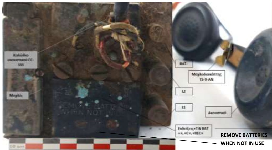
Εικ.4.6 Άνω πλευρά του μεταλλικού πλαισίου. Επισημάνση κυριότερων στοιχείων λειτουργίας Adobe Photoshop CS6 ©Μουσείο ΕΥΔΑΠ, φωτογραφία Αλεξάνδρα Μπολότη
