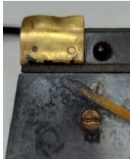
Εικ.5.22 Πριν και κατά τη διάρκεια του χημικού καθαρισμού με μηχανική υποβοήθηση των ορειχάλκινων στοιχείων της δεξιάς πλευράς ©Μουσείο ΕΥΔΑΠ, φωτογραφία Αλεξάνδρα Μπολότη
