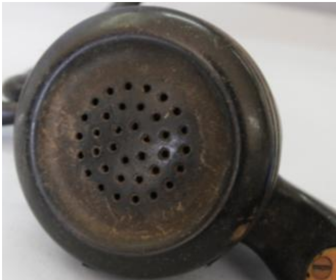
Εικ.4.18 Λεπτομέρεια από το χερούλι του ακουστικού. Ανοιχτόχρωμοι λεκέδες στην εσοχή δεξιά του μοχλοδιακόπτη, αδρή επιφάνεια ©Μουσείο ΕΥΔΑΠ, φωτογραφία Αλεξάνδρα Μπολότη
