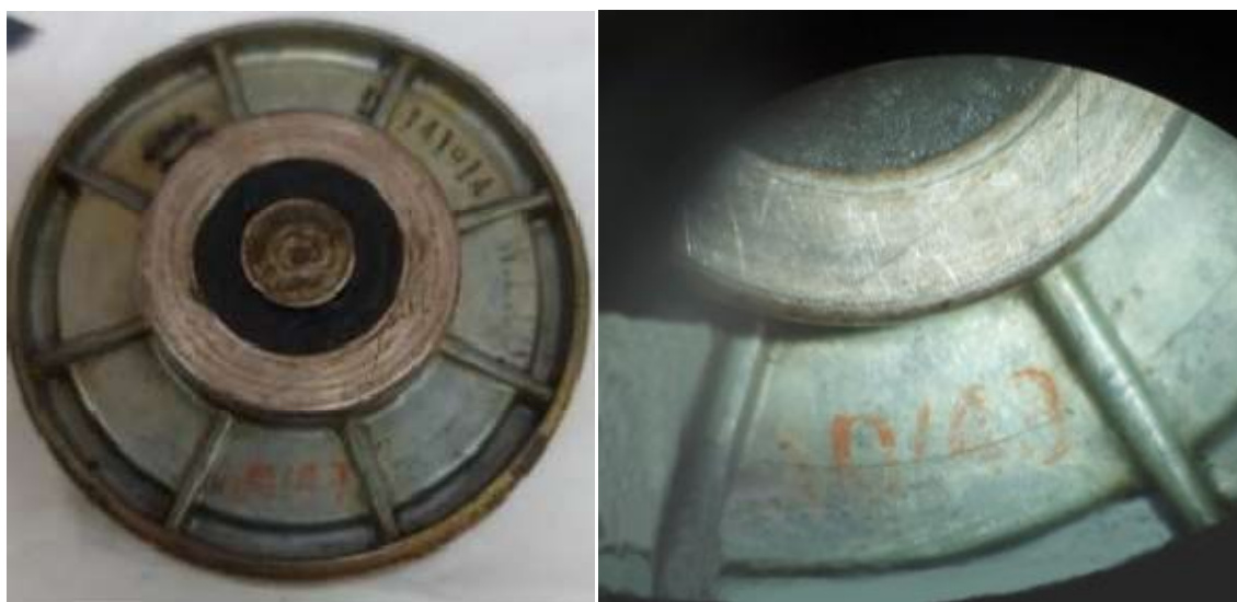
Εικ.5.16 Εσωτερική όψη μικροφώνου. Αναγράφονται σχεδόν ακέραια τα αρχικά από αριστερά προς τα δεξιά «FI», «D», «441914», «W. E. CO» (αριστερά). Εικόνα από το στερεοσκόπιο. Διακρίνονται οι αριθμοί «10/43» με κόκκινο χρώμα (δεξιά) ©Μουσείο ΕΥΔΑΠ, φωτογραφία Αλεξάνδρα Μπολότη
