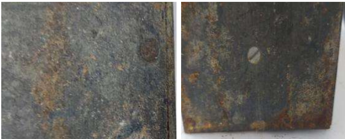
Εικ.4.35 Λεπτομέρειες από την όψη της βάσης. Διακρίνονται προϊόντα διάβρωσης καφέ χρώματος και σημειακά προϊόντα διάβρωσης λευκού χρώματος (αριστερά). Τοπικά προϊόντα διάβρωσης υπόλευκου χρώματος στην κατώτερη ζώνη της βάσης (δεξιά) ©Μουσείο ΕΥΔΑΠ, φωτογραφία Αλεξάνδρα Μπολότη
