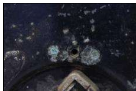
Εικ.4.37 Σχεδιαστική αποτύπωση κύριων φθορών και γενικών διαστάσεων της δεξιάς πλευράς (πάνω) Adobe Photoshop CS6. Λεπτομέρειες από την δεξιά πλευρά του μεταλλικού πλαισίου. Στο κυκλικό πλαίσιο της μανιβέλας παρατηρούνται προϊόντα διάβρωσης πράσινου χρώματος, ενώ στο εσωτερικό υπάρχουν εκτενείς απολεπίσεις χρώματος (αριστερά) ©Αλεξάνδρα Μπολότη
