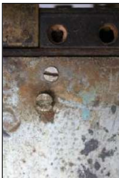
Εικ.4.32 Λεπτομέρεια από την άνω ζώνη της μπροστινής πλευράς. Υπάρχουν έντονα προϊόντα διάβρωσης καφέ χρώματος και έγχρωμες κηλίδες (αριστερά). Εκδορές, απολεπίσεις και σημειακά προϊόντα διάβρωσης λευκού χρώματος (δεξιά) ©Μουσείο ΕΥΔΑΠ, φωτογραφία Αλεξάνδρα Μπολότη
