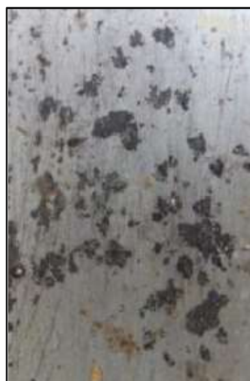
Εικ.4.32 Λεπτομέρεια από την άνω ζώνη της μπροστινής πλευράς. Υπάρχουν έντονα προϊόντα διάβρωσης καφέ χρώματος και έγχρωμες κηλίδες (αριστερά). Εκδορές, απολεπίσεις και σημειακά προϊόντα διάβρωσης λευκού χρώματος (δεξιά) ©Μουσείο ΕΥΔΑΠ, φωτογραφία Αλεξάνδρα Μπολότη
