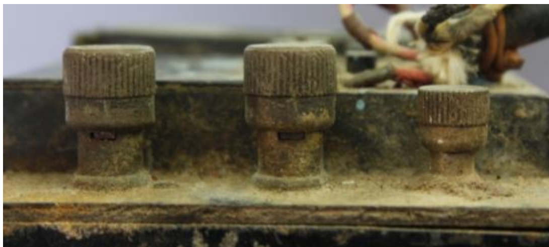
Εικ.4.28 Λεπτομέρεια από τους διακόπτες λειτουργίας στην άνω πλευρά του πλαισίου. Η βάση τους καλύπτεται από συμπαγές στρώμα επικαθίσεων, ενώ κατά τόπους παρατηρείται αμαύρωση της επιφάνειας ©Μουσείο ΕΥΔΑΠ, φωτογραφία Αλεξάνδρα Μπολότη
