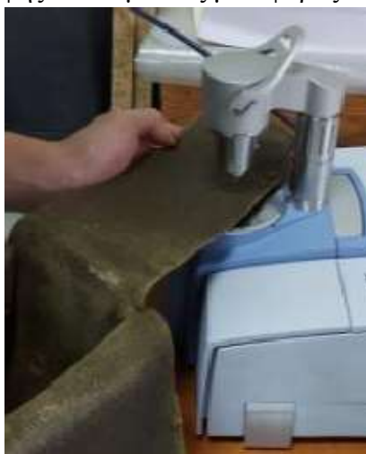
Εικ.3.1 Λήψη φάσματος ATR – FTIR στην εσωτερική όψη του πλαϊνού καπακιού κάλυψης της θήκης (αριστερά). Λήψη φάσματος ATR – FTIR από τον υφασμάτινο μάντα μεταφοράς (δεξιά) ©Μουσείο ΕΥΔΑΠ, φωτογραφία Αλεξάνδρα Μπολότη
