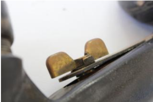
Εικ.4.22 Λεπτομέρεια από το ακουστικό. Ο διακόπτης είναι εκτός θέσης καθώς έχει αφαιρεθεί η βίδα που τον στηρίζει ©Μουσείο ΕΥΔΑΠ, φωτογραφία Αλεξάνδρα Μπολότη
