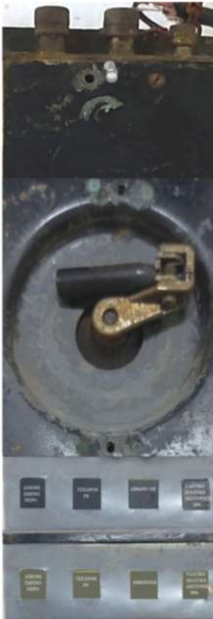
Εικ.5.20 Δοκιμές στη δεξιά όψη με απιονισμένο νερό, με υδατικό διάλυμα Τεχαρον Ν70 2%, με αιθανόλη και υδατικό διάλυμα ακετόνης 50% ©Μουσείο ΕΥΔΑΠ, φωτογραφία Αλεξάνδρα Μπολότη
