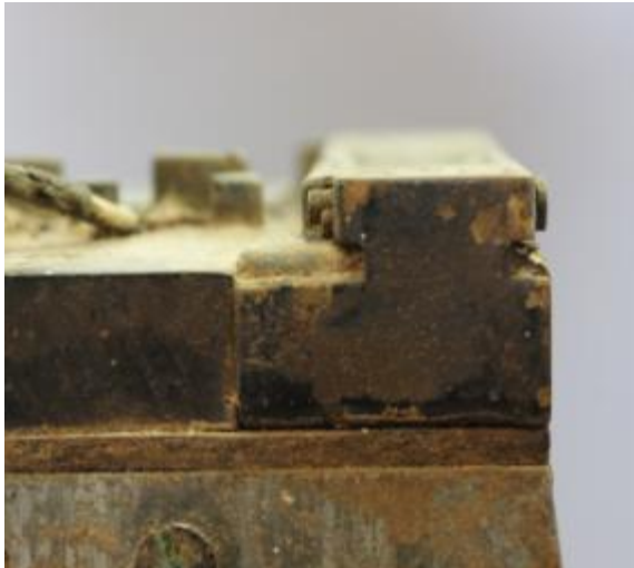
Εικ.5.22 Πριν και κατά τη διάρκεια του χημικού καθαρισμού με μηχανική υποβοήθηση των ορειχάλκινων στοιχείων της δεξιάς πλευράς ©Μουσείο ΕΥΔΑΠ, φωτογραφία Αλεξάνδρα Μπολότη
