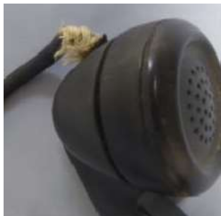
Εικ.5.13 Λεπτομέρεια από το καπάκι κάλυψης του μικροφώνου πριν την αφαίρεση της μαύρης συγκολλητικής ταινίας (αριστερά). Λεπτομέρεια από το καπάκι κάλυψης του μικροφώνου μετά την αφαίρεση της συγκολλητικής ταινίας (δεξιά). Το καπάκι στηρίζεται εξίσου καλά στην αρχική του θέση ©Μουσείο ΕΥΔΑΠ, φωτογραφία Αλεξάνδρα Μπολότη
