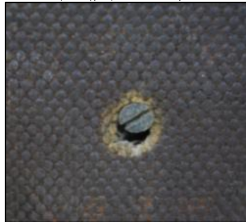
Εικ.4.12 Λεπτομέρειες από οξειδωμένα μεταλλικά στοιχεία που έρχονται σε επαφή με το ύφασμα. Κουμπώμα στο πλαϊνό καπάκι (πάνω αριστερά). Μεταλλική επιγραφή στην μπροστινή πλευρά (πάνω δεξιά). Στοιχεία στήριξης του ιμάντα (κάτω αριστερά). Στοιχείο σύνδεσης του μηχανισμού στο ύφασμα (κάτω δεξιά) ©Μουσείο ΕΥΔΑΠ, φωτογραφία Αλεξάνδρα Μπολότη
