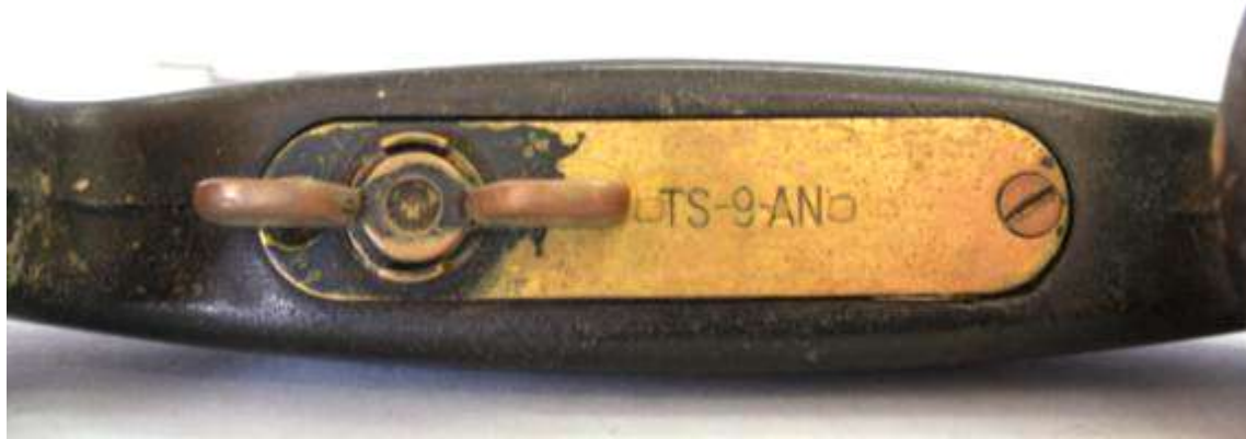
Εικ.4.4 Λεπτομέρεια από το ακουστικό. Αριστερά και δεξιά του μεταλλικού πλαισίου υπάρχουν οι χαρακτηριστικές ραφές από τη μορφοποίηση του σκελετού. Μέσα στο πλαίσιο υπάρχει ο μεταλλικός μοχλοδιακόπτης ©Μουσείο ΕΥΔΑΠ, φωτογραφία Αλεξάνδρα Μπολότη
