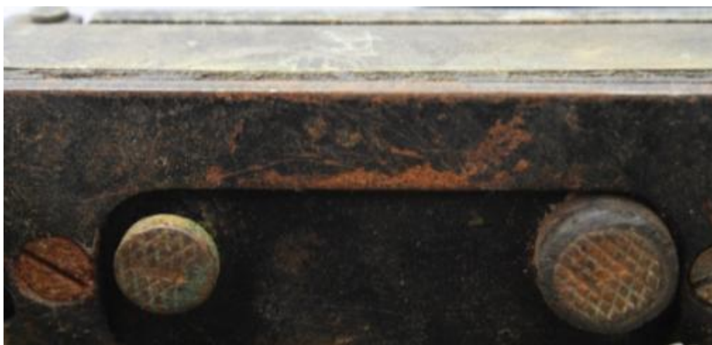
Εικ.4.27 Λεπτομέρεια από την εσωτερική επιφάνεια του μοχλού λειτουργίας στην άνω πλευρά του πλαισίου. Τόσο στην επιφάνεια των διακοπών όσο και στις βίδες είναι εμφανές το προϊόν διάβρωσης του χαλκού ©Μουσείο ΕΥΔΑΠ, φωτογραφία Αλεξάνδρα Μπολότη
