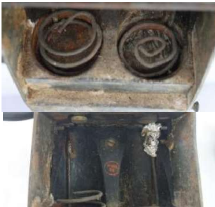
Εικ.4.38 Πλαίσιο υποδοχής μπαταριών. Στρώμα επικαθίσεων και τοπικές οξειδώσεις στη βάση, τα τοιχώματα και τους υποδοχείς (πάνω). Μεταγενέστερη επέμβαση επιδιόρθωσης (κάτω) ©Μουσείο ΕΥΔΑΠ, φωτογραφία Αλεξάνδρα Μπολότη
