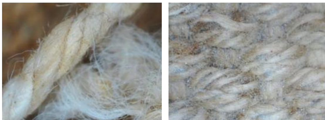
Εικ.4.41 Απεικόνιση 2- κλωνης βαμβακερής κλωστής στο Φορητό Μικροσκόπιο. Φορά
