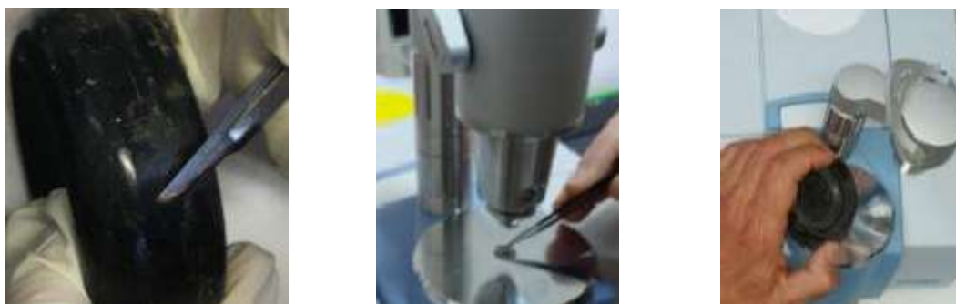
Εικ.3.2 Δείγμα A1. Περιοχή δειγματοληψίας (αριστερά), τοποθέτηση δείγματος A1 στο ATR (κέντρο), λήψη φάσματος χωρίς δειγματοληψία (δεξιά) ©Μουσείο ΕΥΔΑΠ, φωτογραφία Αλεξάνδρα Μπολότη
