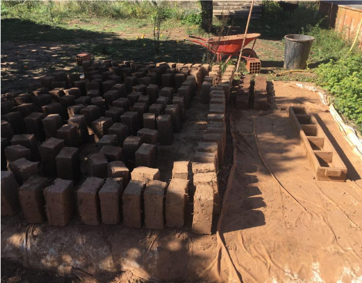
Εικ.2.12 Παραγωγή ωμόπλινθων σε εργοτάξιο στο Santiago do Cacem, Πορτογαλία ΠΗΓΗ: Προσωπικό Αρχείο
