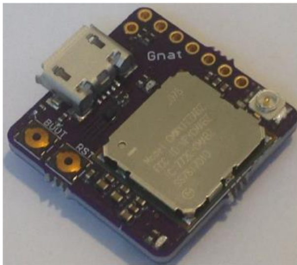
Σχήμα 24 : Μονάδα CMWX1ZZABZ LoRa που χρησιμοποιείται για τη μετάδοση δεδομένων μεταξύ των μονάδων έξυπνου μετρητή και του τοπικού κέντρου παρακολούθησης.
