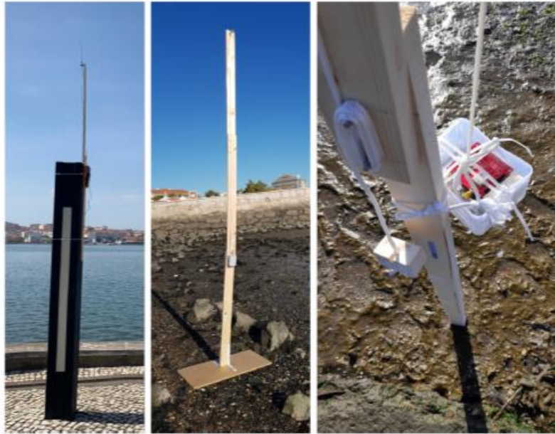
Σχήμα 31 : Πύλη και κόμβοι αισθητήρων στο πεδίο παρακολούθησης.
