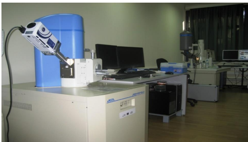
Εικ. 3.6: Ηλεκτρονικό μικροσκόπιο JEOL JSM-6510 LV - SEM, Scanning Electron Microscopy (Τμήμα Συντήρησης Αρχαιοτήτων και Έργων Τέχνης, Πανεπιστήμιο Δυτικής Αττικής) (Τσατσάλοβα 2023)..
