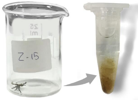
Εικ. 3.9: Αριστερά: αρχική κατάσταση του δείγματος πριν την επεξεργασία των νημάτων. Δεξιά: τελική κατάσταση δείγματος. Οι ίνες είναι διαχωρισμένες και έτοιμες για μικροσκοπική παρατήρηση με ΟΜ (Τσατσάλοβα 2023).
