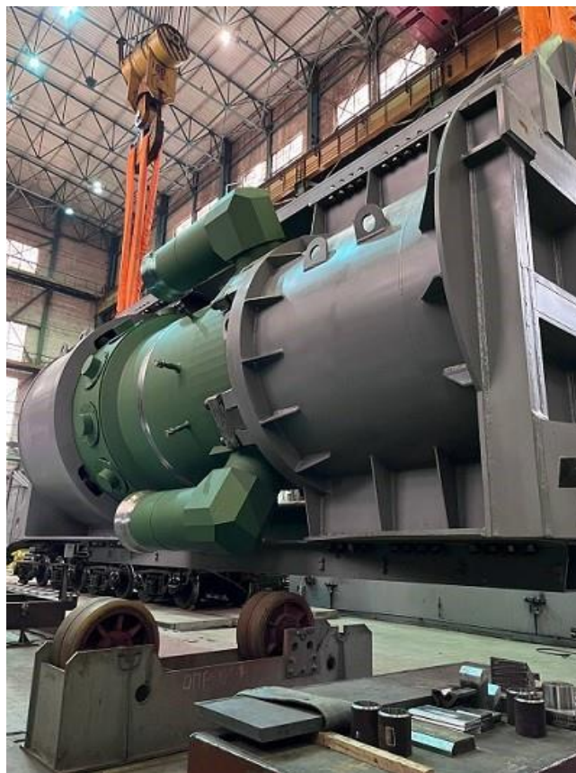
Εικόνα 44 Κέλυφος του αντιδραστήρα RITM-200, του νέου παγοθραυστικού Yakutia (ROSATOM, 2022)
