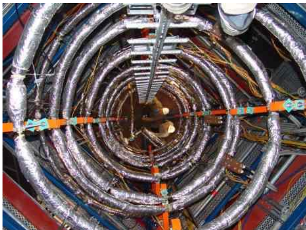
Εικόνα 30 Γεννήτρια ατμού με ελικοειδές πηνίο NuScale (world nuclear news, 2014)
