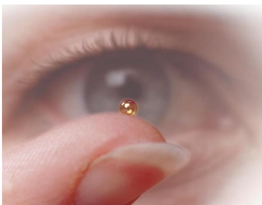
Εικόνα 24: Σφαιρίδιο καυσίμου D-T (Wikipedia, χ.χ.)
