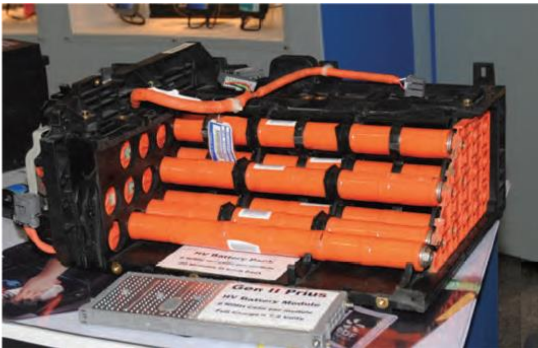
Εικόνα 10. Συστοιχία μπαταριών Ni-MH. Σε κάθε συστοιχία (πορτοκαλί σωλήνα) βρίσκονται 6 στοιχεία και συνολικά το σύστημα αποτελείται από 20 συστοιχίες. [27]
