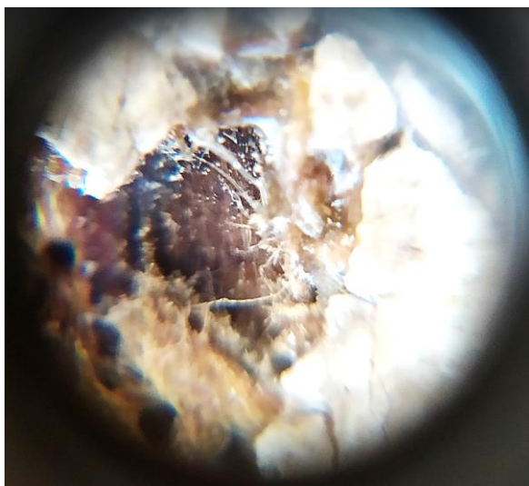
Εικόνα 4. 19 Μικροσκοπική λήψη της οξείδωσης της πρόκας η οποία έρχεται σε επαφή με τον μουσαμά
