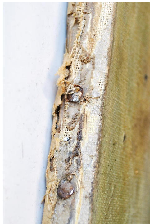
Εικόνα 4. 20 Μακροσκοπική λήψη της οξείδωσης των προκών όπου έρχονται σε επαφή με τον μουσαμά
