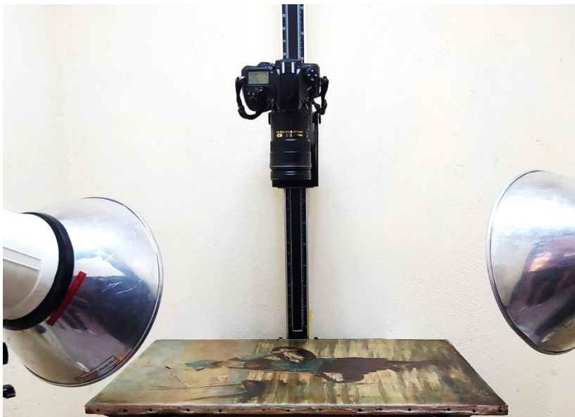
Εικόνα 2.5 Εξοπλισμός και εφαρμογή της φωτογράφισης υπεριώδους φθορισμού.
