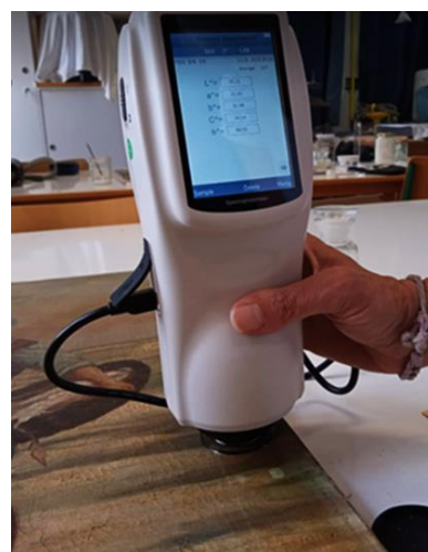
Εικόνα 2.7 Όργανο της χρωματομετρίας (Color Meter PCE-CSM 10) και η εφαρμογή της στο έργο του Α.Πρέσα.
