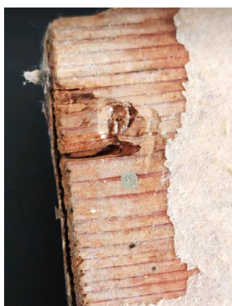
Εικόνα 4. 21α Λήψη της πίσω όψης του τελάρου όπου είναι διακριτές είναι οι μηχανικές καταπονήσεις και διανοίξεις του ξύλου.
