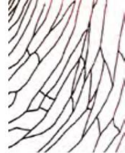
Σχ. 27: Σχεδιαστική απόδοση των στεφανιαίων ρωγμών (Πηγή σχεδίων: Alexorouliou A., Koutsouris A., Panagoroulous A., Gerakari K., 2006, κ.σ.).
