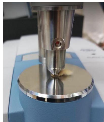
Εικόνα 2.8 Εξοπλισμός και εφαρμογή FTIR
