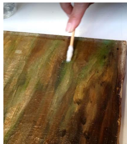
Εικόνα 2.9 Εφαρμογή δειγματοληψίας για την μέθοδο ATR-FTIR στην επιφάνεια της ζωγραφικής επιφάνειας με μπατονέτα εμποτισμένη σε αιθανόλη.
