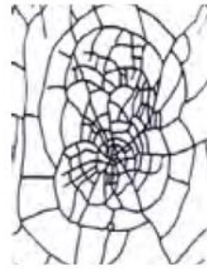
Σχ. 32: Σχεδιαστική απόδοση των αραχνοειδών ρωγμών (Πηγή σχεδίων: Alexorouliou A., Koutsouris A., Panagoroulous A., Gerakari K., 2006, κ.σ.).
