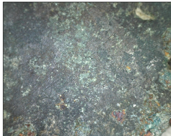
Φωτ. 6.57 Ανομοιόμορφη διάβρωση με προϊόντα διάβρωσης χαλκού (υπομεταλλικό κόκκινο, ανοιχτό, σκούρο πράσινο), (x215), (Τρουλλινού Α.©)
