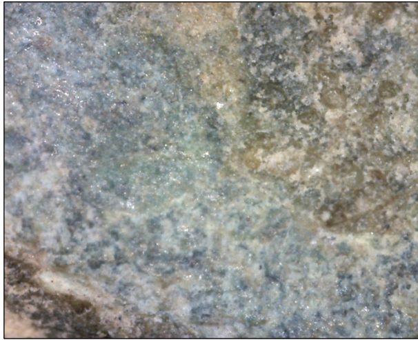
Φωτ. 6.11 Επιφάνεια με προϊόντα διάβρωσης χαλκού (ανοιχτό πράσινο, μπλε και γαλάζιο) και κρούστες αλάτων (x210), (Τρουλλινού Α.©)
