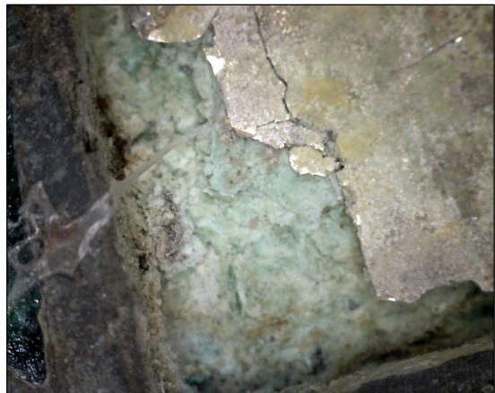
Φωτ. 6.45 Θραύσεις, ρωγμές και απώλεια υλικού. Κόλλα πιθανόν από σωστικές επεμβάσεις και προϊόντα διάβρωσης χαλκού (ανοιχτό πράσινο) (x50), (Τρουλλινού Α.©)
