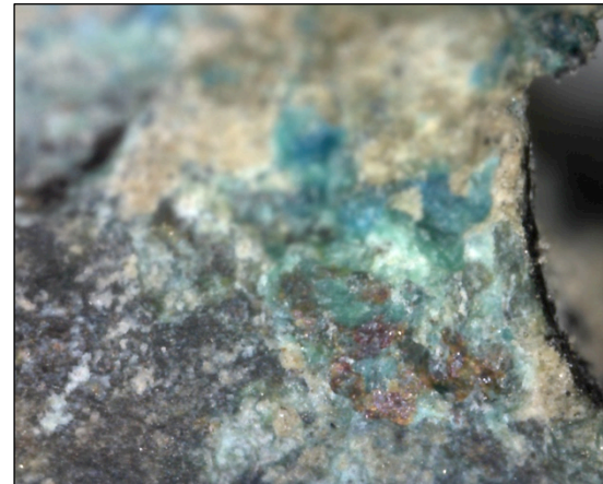
Φωτ. 6.61 Γαλαζοπράσινα, μπλε και υποκόκκινα προϊόντα διάβρωσης χαλκού (x215), (Τρουλλινού Α.©)
