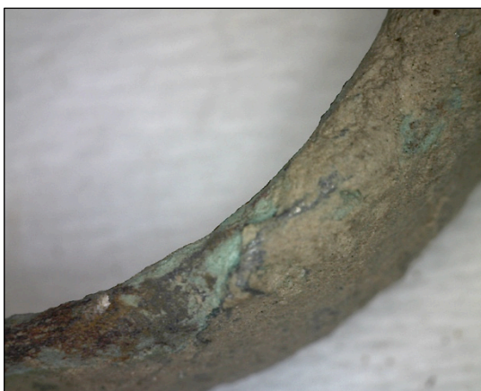
Φωτ. 6.92 Ιζηματογενείς κρούστες, μηχανικές κακώσεις, προϊόντα διάβρωσης χαλκού, (ανοιχτό πράσινο), ενεργός διάβρωση (x55), (Τρουλλινού Α.°)
