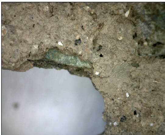
Φωτ. 6.14 Μεγάλου πάχους και σκληρότητας ιζήματα (x50), (Τρουλλινού Α.©)
