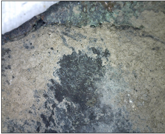
Φωτ. 6.76 Κρούστες αλάτων και βελονισμοί (x50), (Τρουλλινού Α.®)
