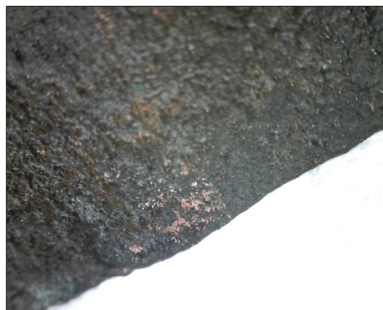
Φωτ. 7.69 Απομάκρυνση αναστολέα διάβρωσης (x45), (Τρουλλινού Α.©)
