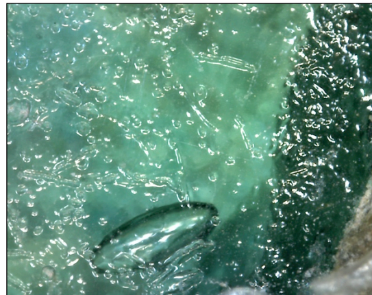
Φωτ. 6.55 Βελονισμοί και εκδορές. Λεπτομέρεια γυάλινου τμήματος (x225), (Τρουλλινού Α.©)
