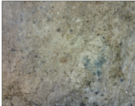
Φωτ. 6.37 Χονδρόκοκκα ιζήματα και κρούστες αλάτων (x225), (Τρουλλινού Α.®)
