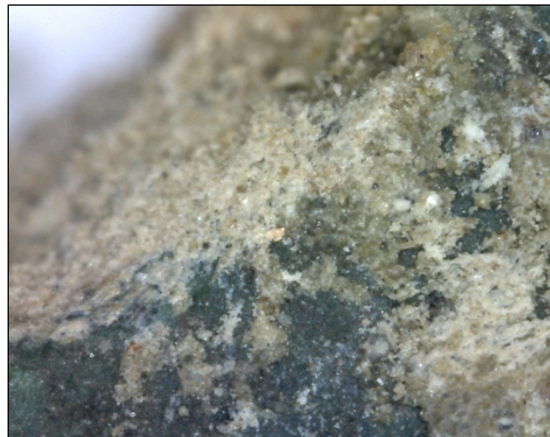
Φωτ. 6.35 Προϊόντα διάβρωσης χαλκού (σκούρο πράσινο χρώμα) και άλατα (x225), (Τρουλλινού Α.®)
