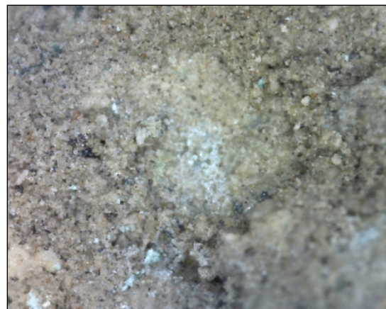
Φωτ. 6.33 Περιοχή με γαλάζια προϊόντα διάβρωσης χαλκού κάτω από ιζηματογενείς κρούστες (x225), (Τρουλλινού Α.ῆ)
