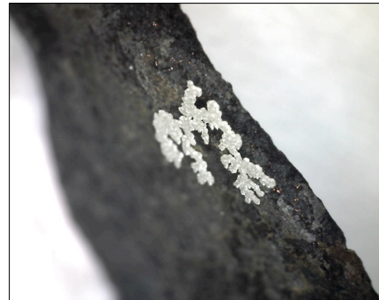
Φωτ. 7.62 Κρυστάλλοι μετά από εμβάπτιση 24h στον αναστολέα διάβρωσης (x50) (Τρουλλινού Α.©)
