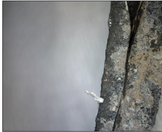
Φωτ. 7.65 Κρύσταλλοι, κρυσταλλική σκόνη (x50) (Τρουλλινού Α.©)
