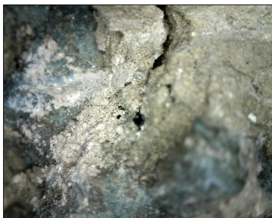
Φωτ. 6.3 Σκληρά και μεγάλου πάχους ιζήματα (x50), (Τρουλλινού Α.®)
