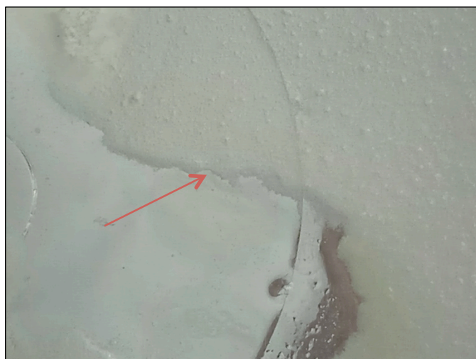
Φωτ. 7.56 Σχηματισμός κρυστάλλων μετά από 24h εμφύτισης του αντικειμένου στον αναστολέα διάβρωσης (Τρουλλινού Α. ο )
