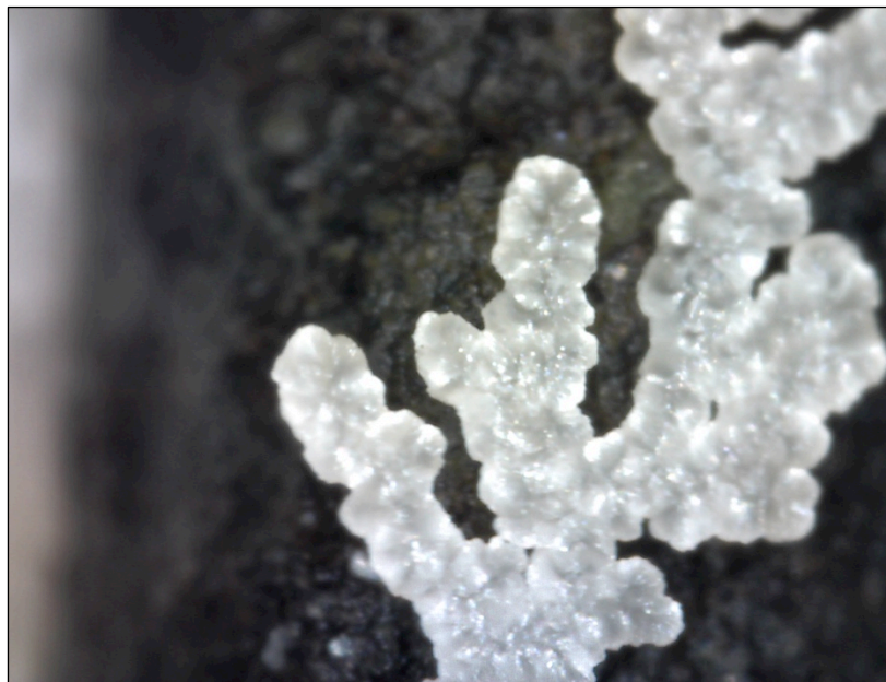
Φωτ. 7.63 Σχηματισμός κρυστάλλων μετά από 24h εμβάπτισης του αντικειμένου στον αναστολέα διάβρωσης (x230), (Τρουλλινού Α.©)
