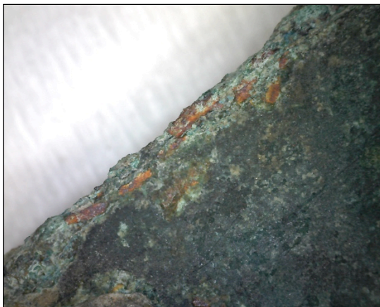
Φωτ. 6.56 Αποσάθρωση, μηχανικές κακώσεις και προϊόντα διάβρωσης χαλκού (ανοιχτό, σκούρο πράσινο), (x50), (Τρουλλινού Α.©)
