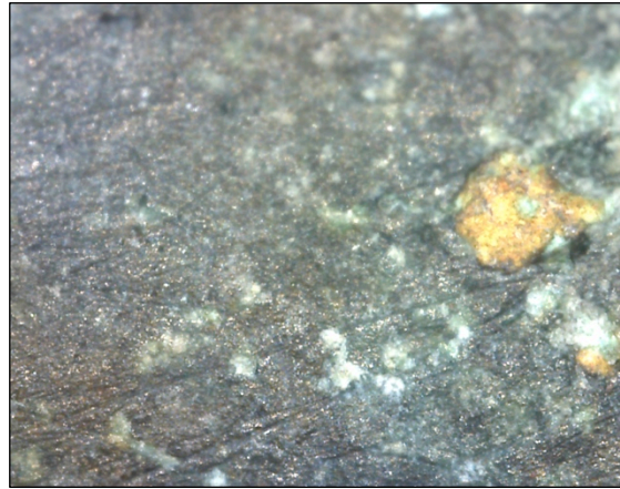
Φωτ. 6.65 Εκδορές και οπές με προϊόντα διάβρωσης χαλκού, (ανοιχτά πράσινα και κιτρινωπά), (x215), (Τρουλλινού Α.©)
