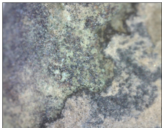
Φωτ. 6.69 Απολεπίσεις και προϊόντα διάβρωσης (ανοιχτό πράσινο και γαλαζοπράσινο), (x230), (Τρουλλινού Α.©)
