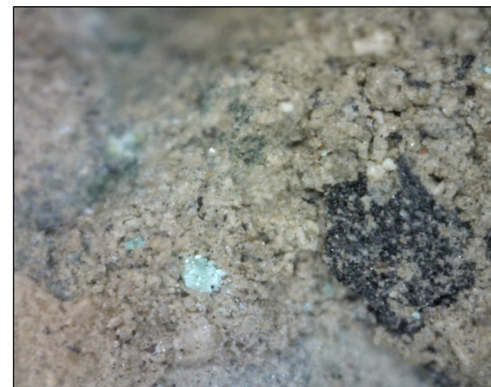
Φωτ. 6.27 Γαλάζια προϊόντα διάβρωσης χαλκού, σημειακά (x225), (Τρουλλινού Α.©)
