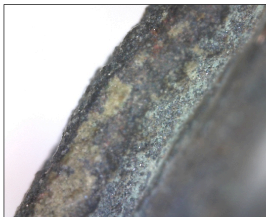
Φωτ. 6.103 Κρούστες αλάτων, προϊόντα διάρρωσης χαλκού (πράσινο ανοιχτό, κοκκινωπό) και μηχανικές κακώσεις (x210), (Τρουλλινού Α.®)
