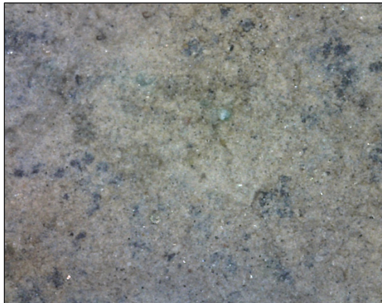
Φωτ. 6.67 Ανομοιόμορφου πάχους ιζηματογενείς κρούστες (x240), (Τρουλλινού Α.©)
