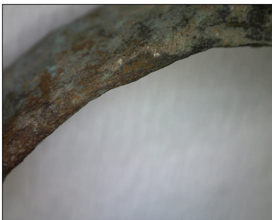
Φωτ. 6.98 Εκτεταμένα προϊόντα διάβρωσης χαλκού ανοιχτό πράσινο και νησίδες ιζημάτων (x55), (Τρουλλινού Α.©)
