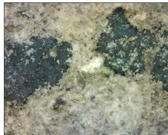
Φωτ. 6.39 Σκληρές και μεγάλου πάχους κρούστες αλάτων (x225), (Τρουλλινού Α.®)
