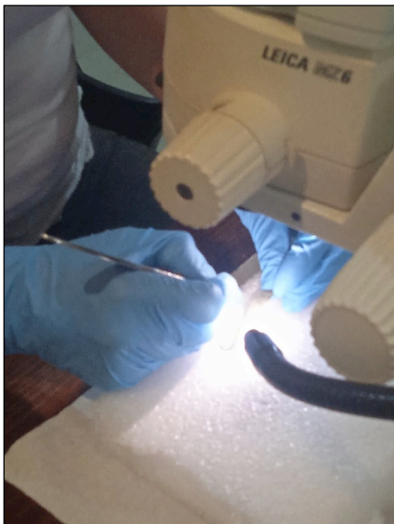
Φωτ. 7.12 Μηχανικός καθαρισμός αντικειμένου με την βοήθεια μικροσκοπίου (Τρουλλινού Α.©)
