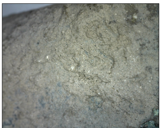
Φωτ. 6.85 Μεγάλου πάχους ιζηματογενείς κρούστες (x60), (Τρουλλινού Α.ᶜ)
