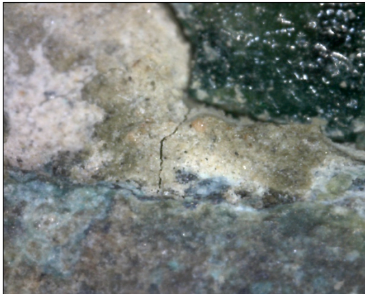
Φωτ. 6.48 Μικρορηγματώσεις, λεπτομέρεια (x270), (Τρουλλινού Α.©)
