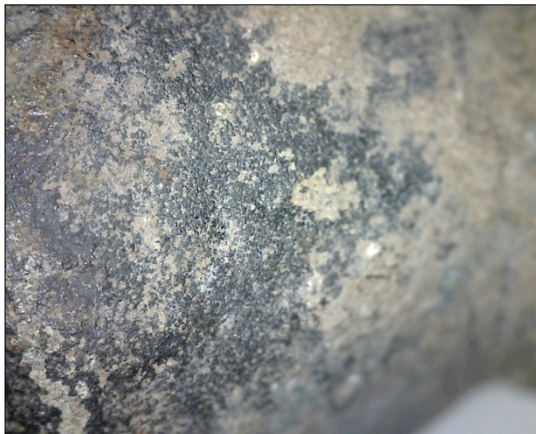
Φωτ. 6.86 Μαύρη, τραχιά επιφάνεια με βελονισμούς (x55), (Τρουλλινού Α.ᶜ)
