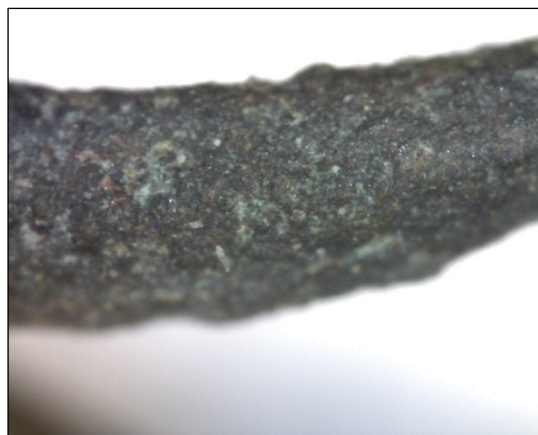
Φωτ. 6.101 Λεπτομέρεια διάβρωσης με οπές, spots (x200), (Τρουλλινού Α.®)
