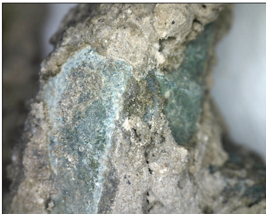
Φωτ. 6.9 Προϊόντα διάβρωσης χαλκού (σκούρο πράσινο, γαλάζιο) και ιζήματα (x50), (Τρουλλινού Α. © )
