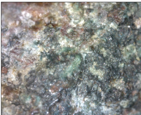
Φωτ. 7.17 Συγκέντρωση κρυσταλλικής σκόνης μετά την εμβάπτιση του αντικειμένου στον αναστολέα διάβρωσης (x220), (Τρουλλινού Α.©)
