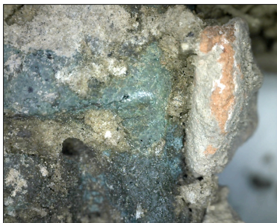
Φωτ. 6.1 Τραχιά επιφάνεια, με πράσινα (σκούρο, μεγάλου πάχους ανοιχτό) προϊόντα διάβρωσης χαλκού. Ιζήματα με ενσωματωμένους μεγάλους λίθους (x50), (Τρουλλινού Α.®)
