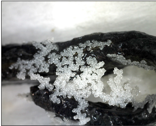
Φωτ. 7.59 Κρύσταλλοι στην επιφάνεια του αντικειμένου, μετά από παραμονή 24h στο υδατικό διάλυμα αναστολέα διάβρωσης (x50), (Τρουλλινού Α.©)
