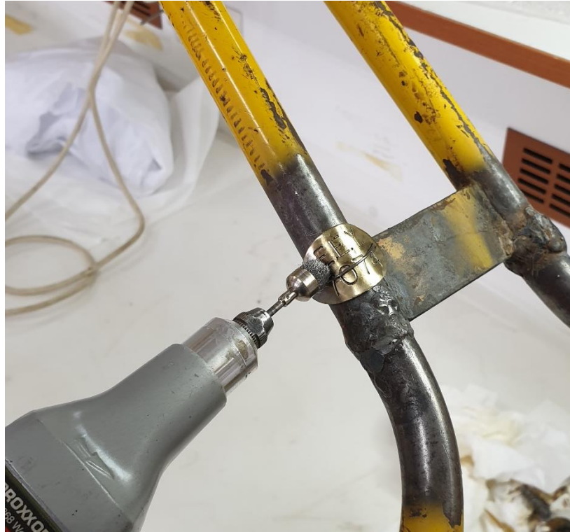
Εικόνα 8.19 Καθαρισμός ένδειξης με τροχό. © Μουσείο Νερού Μαραθώνα, Εργαστήριο Συντήρησης Μετάλλου Πα.ΔΑ/Μαρίνα Ρώσσιου.
