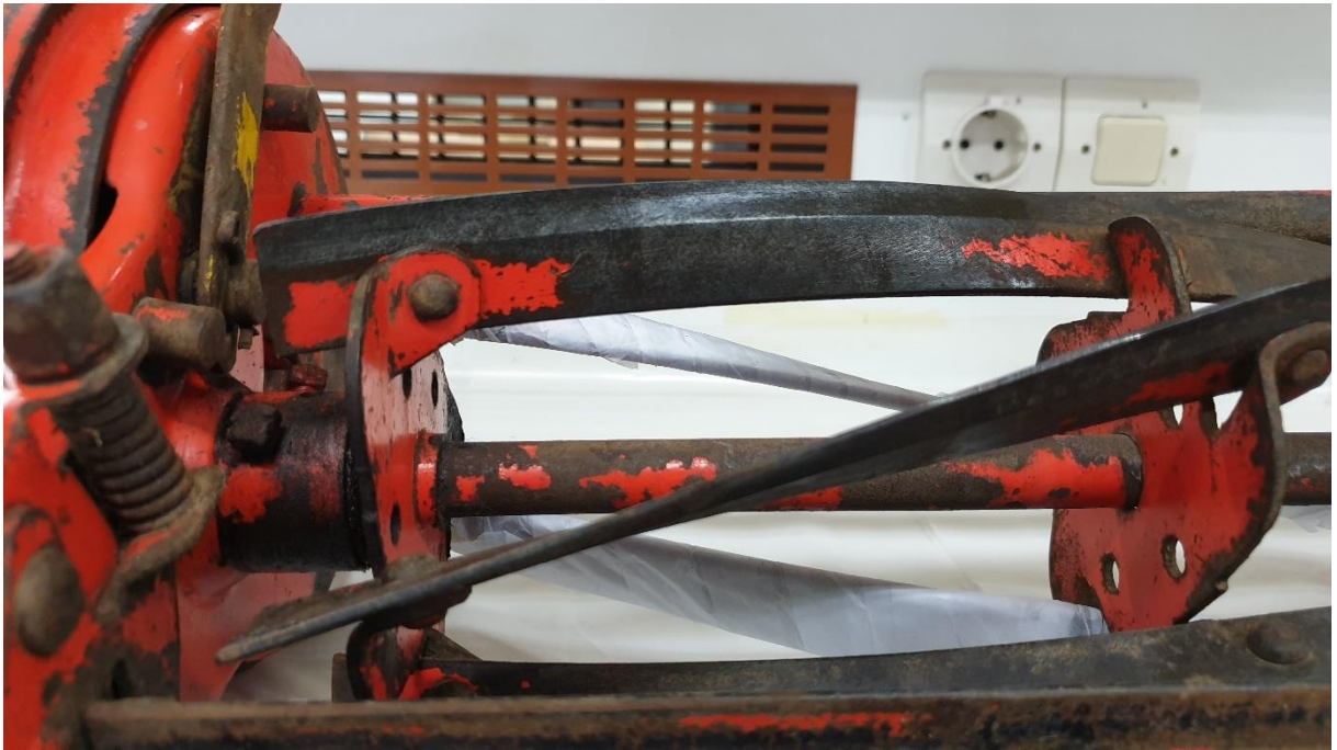
Εικόνα 8.18 Καθαρισμός προϊόντων διάβρωσης με καυστικό νάτριο 5%. © Μουσείο Νερού Μαραθώνα, Εργαστήριο Συντήρησης Μετάλλου Πα.ΔΑ/Μαρίνα Ρώσσιου.
