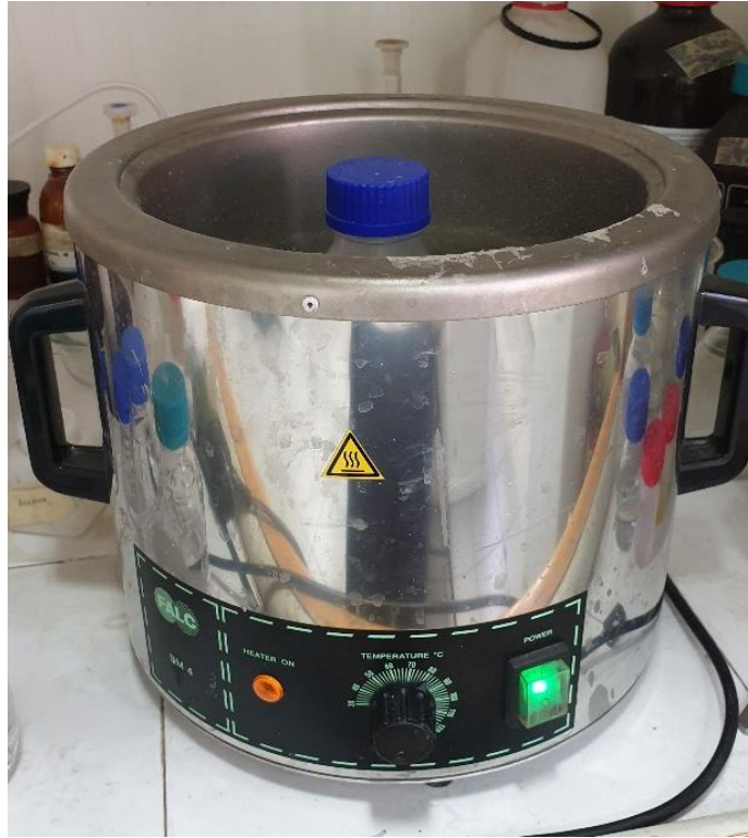
Εικόνα 8.22 Χρήση υδατόλουτρου για την θέρμανση του κεριού. © Εργαστήριο Συντήρησης Μετάλλου Πα.ΔΑ/Μαρίνα Ρώσσιου.
