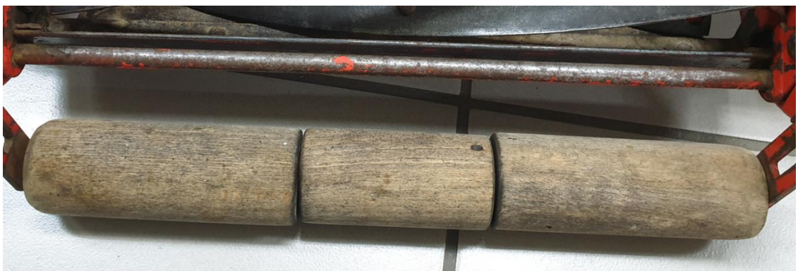
Εικόνα 8.37 Ξύλινες κυλινδρικές ρόδες μετά τον καθαρισμό. © Εργαστήριο Συντήρησης Μετάλλου Πα.ΔΑ/Μαρίνα Ρώσσιου.
