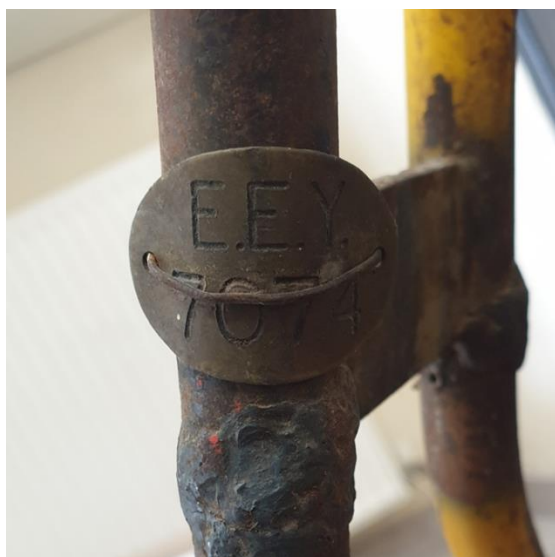
Εικόνα 8.42 Μεταλλικό ταμπελάκι πριν τον καθαρισμό με τον τροχό. © Εργαστήριο Συντήρησης Μετάλλου Πα.ΔΑ/Μαρίνα Ρώσσιου.
