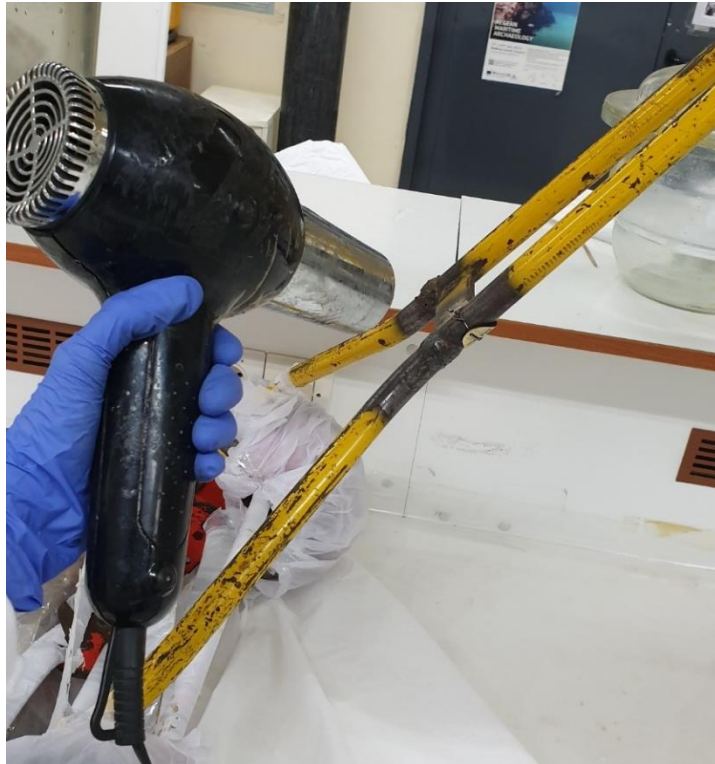
Εικόνα 8.24 Θέρμανση του σημείου εφαρμογής του κεριού στο χλοοκοπτικό. © Εργαστήριο Συντήρησης Μετάλλου Πα.ΔΑ/Μαρίνα Ρώσσιου.
