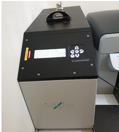
Εικόνα 5.3 XRD-XRF «inXitu BTX262». © Εργαστήριο Συντήρησης Μετάλλου Πα.ΔΑ/Μαρίνα Ρώσσιου.
