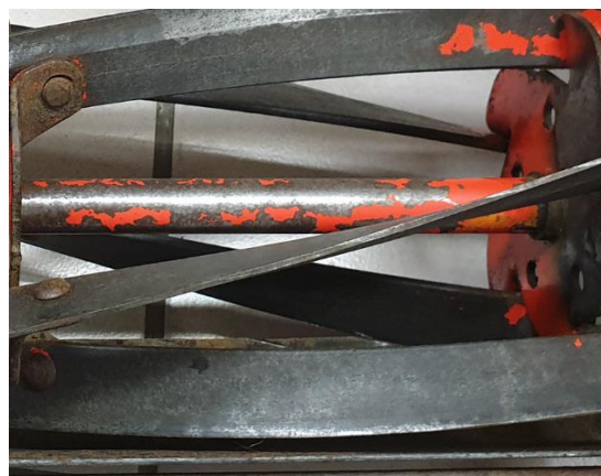
Εικόνα 8.27 Μεταλλικές λεπίδες μετά τον καθαρισμό με καυστικό νάτριο 5%. © Εργαστήριο Συντήρησης Μετάλλου Πα.ΔΑ/Μαρίνα Ρώσσιου.
