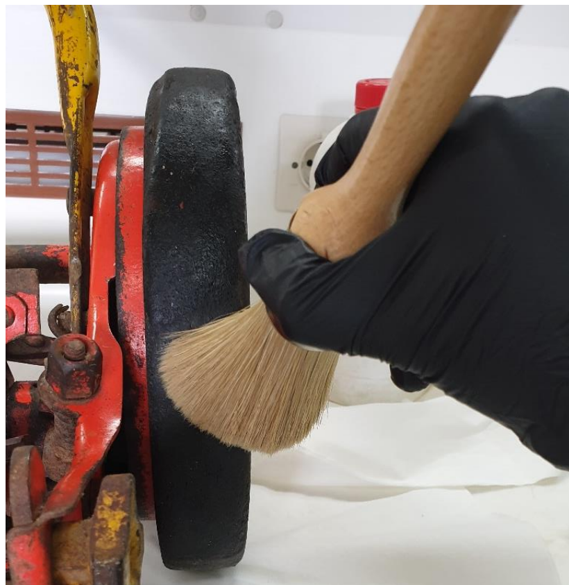
Εικόνα 8.14 Καθαρισμός ελαστικού με πινέλο για απομάκρυνση χνουδιών βαμβακιού. © Μουσείο Νερού Μαραθώνα, Εργαστήριο Συντήρησης Μετάλλου Πα.ΔΑ/Μαρίνα Ρώσσιου.
