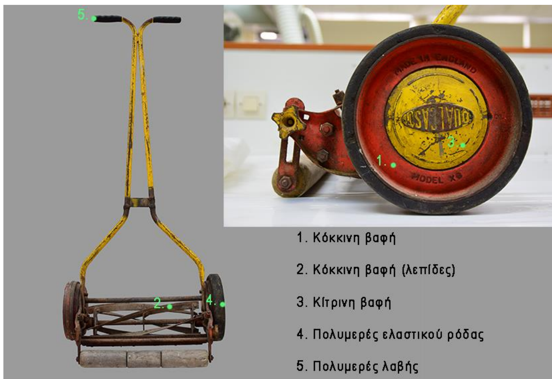
Εικόνα 5.7 Σημεία δειγματοληψίας για FTIR. © Μουσείο Νερού Μαραθώνα, Εργαστήριο Συντήρησης Μετάλλου Πα.ΔΑ/Μαρίνα Ρώσσιου.
