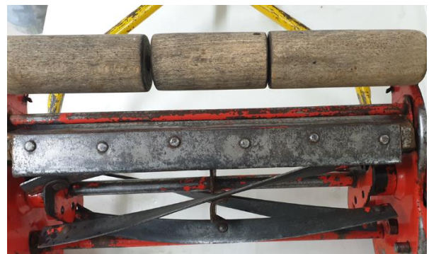
Εικόνα 8.39 Σταθερή μεταλλική λεπίδα μετά τον καθαρισμό με καυστικό νάτριο. © Εργαστήριο Συντήρησης Μετάλλου Πα.ΔΑ/Μαρίνα Ρώσσιου.
