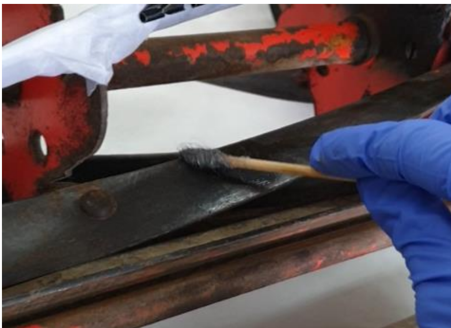
Εικόνα 8.17 Καυστικό νάτριο 5%. Εφαρμογή με συρμάτινη μπατονέτα. © Μουσείο Νερού Μαραθώνα, Εργαστήριο Συντήρησης Μετάλλου Πα.ΔΑ/Μαρίνα Ρώσσιου.
