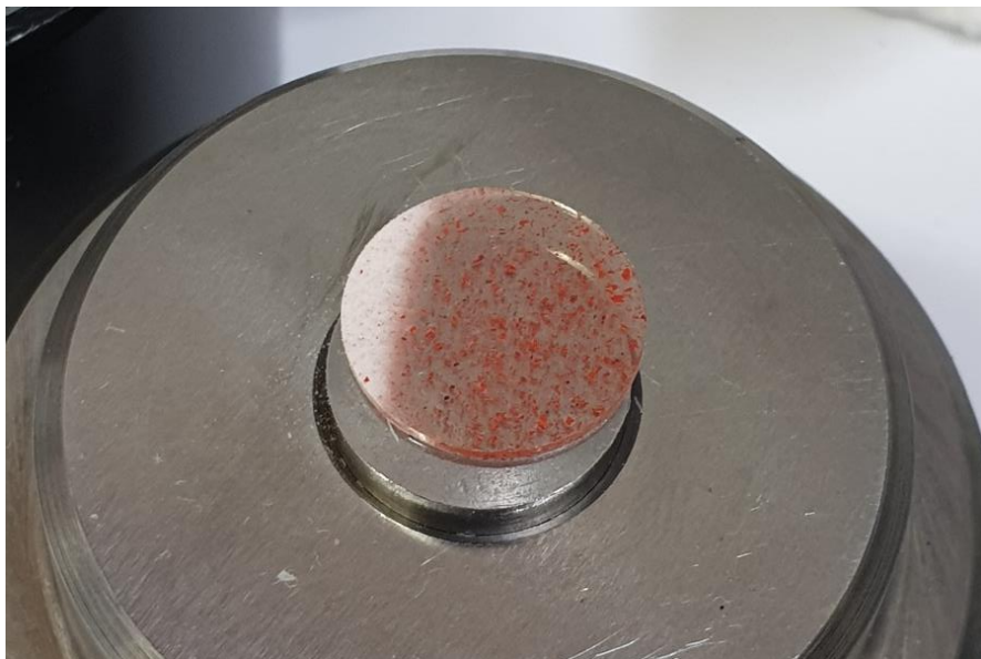
Εικόνα 6.7 Δείγμα κόκκινης βαφής σε μορφή παστίλιας με την τεχνική KBr. © Πα.ΔΑ/Μαρίνα Ρώσσιου.
