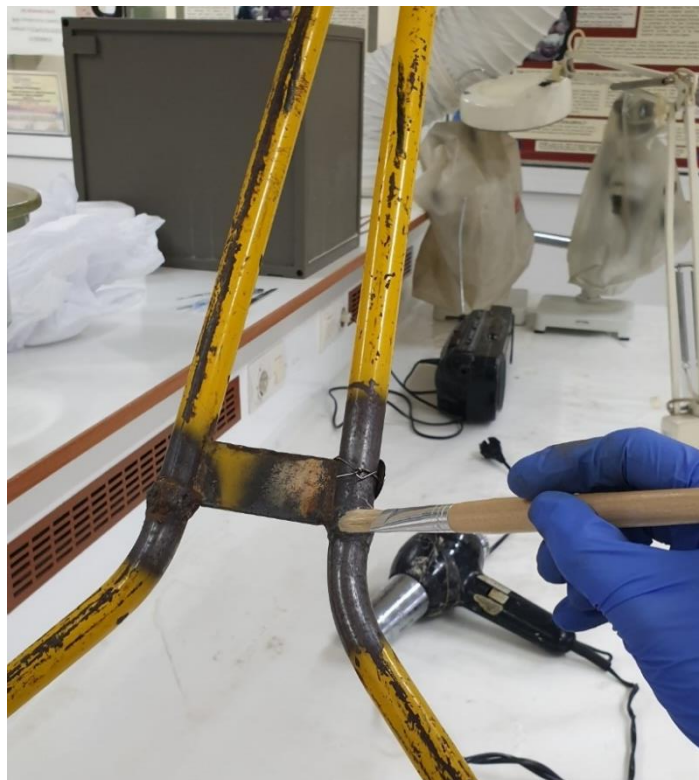
Εικόνα 8.25 Εφαρμογή κεριού με πινέλο. © Εργαστήριο Συντήρησης Μετάλλου Πα.ΔΑ/Μαρίνα Ρώσσιου.
