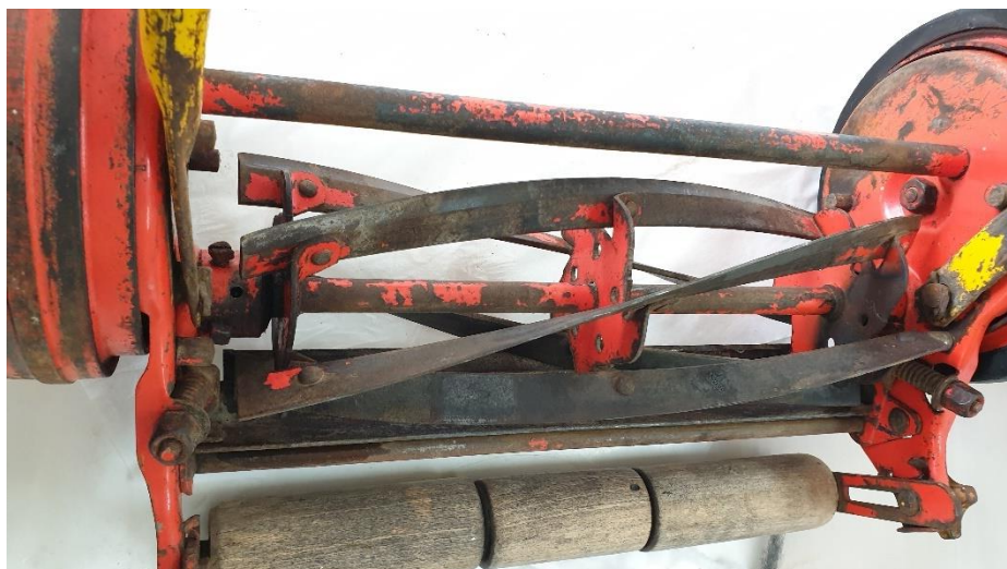
Εικόνα 8.16 Πριν την χρήση καυστικού νατρίου για την απομάκρυνση προϊόντων διάβρωσης. © Μουσείο Νερού Μαραθώνα, Εργαστήριο Συντήρησης Μετάλλου Πα.ΔΑ/Μαρίνα Ρώσσιου.
