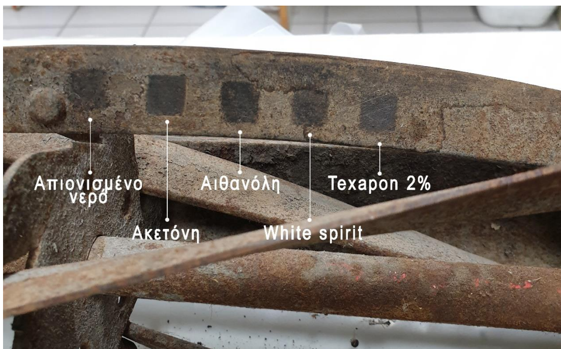
Εικ. 1 Spot tests για καθαρισμό μεταλλικών τμημάτων. © Μουσείο Νερού Μαραθώνα, Εργαστήριο Συντήρησης Μετάλλου Πα.ΔΑ/Μαρίνα Ρώσσιου.
