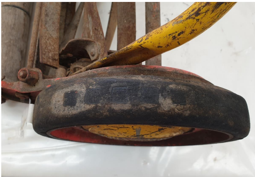
Εικόνα 7.8 Αποτελέσματα δοκιμών καθαρισμού στο ελαστικό ρόδας με αιθανόλη 10%, 20% και 30%, απιονισμένο νερό και Texaropn 2% v/v. © Μουσείο Νερού Μαραθώνα, Εργαστήριο Συντήρησης Μετάλλου Πα.ΔΑ/Μαρίνα Ρώσσιου.
