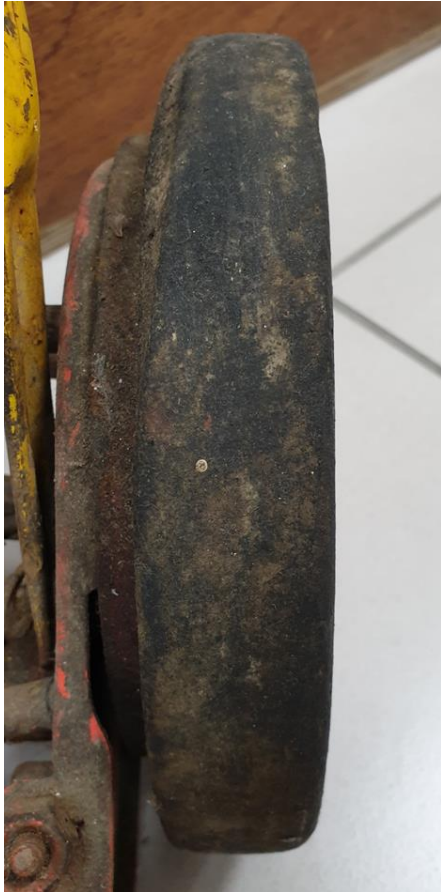
Εικόνα 8.34 Καουτσούκ ρόδας πριν το silicone oil. © Εργαστήριο Συντήρησης Μετάλλου Πα.ΔΑ/Μαρίνα Ρώσσιου.
