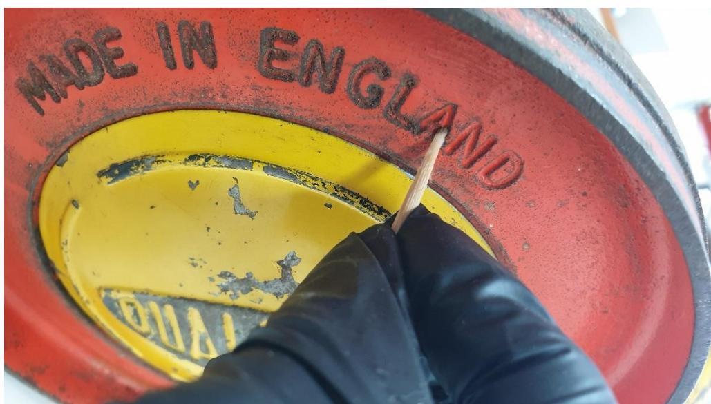
Εικόνα 8.9 Καθαρισμός γραμμάτων στις ρόδες του χλοοκοπτικού. © Μουσείο Νερού Μαραθώνα, Εργαστήριο Συντήρησης Μετάλλου Πα.ΔΑ/Μαρίνα Ρώσσιου.
