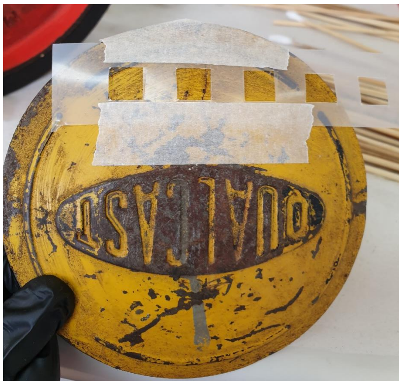
Εικόνα 7.2 Σημεία δοκιμών καθαρισμού και την κίτρινη βαφή. © Μουσείο Νερού Μαραθώνα, Εργαστήριο Συντήρησης Μετάλλου Πα.ΔΑ/Μαρίνα Ρώσσιου.
