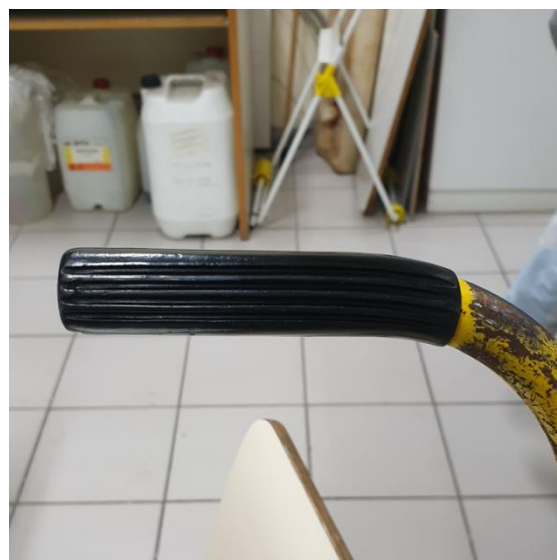
Εικόνα 8.33 Λαβή PVC μετά τον καθαρισμό. © Εργαστήριο Συντήρησης Μετάλλου Πα.ΔΑ/Μαρίνα Ρώσσιου.
