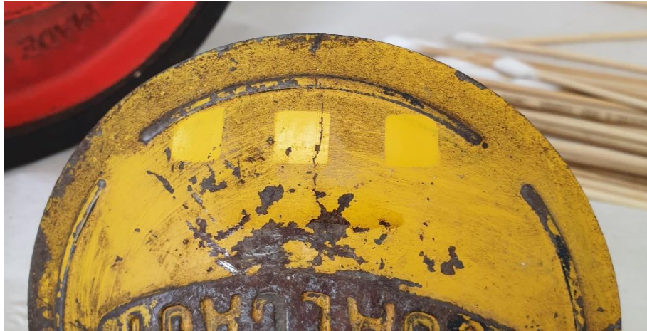
Εικόνα 7.3 Δοκιμές καθαρισμού με ακετόνη 10% 20% και 30% σε κίτρινη βαφή. © Μουσείο Νερού Μαραθώνα, Εργαστήριο Συντήρησης Μετάλλου Πα.ΔΑ/Μαρίνα Ρώσσιου.
