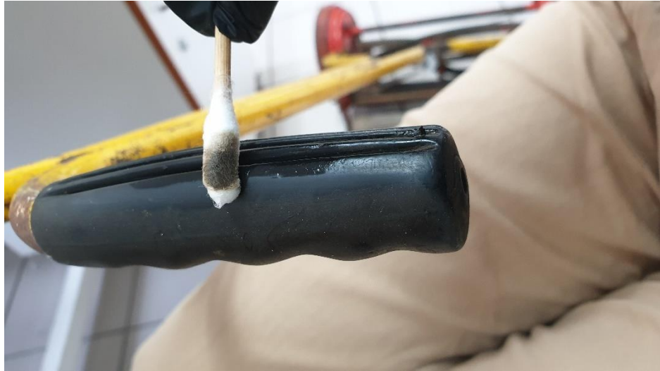
Εικόνα 7.10 Δοκιμή καθαρισμού με Τεχαρον 2%. © Μουσείο Νερού Μαραθώνα, Εργαστήριο Συντήρησης Μετάλλου Πα.ΔΑ/Μαρίνα Ρώσσιου
