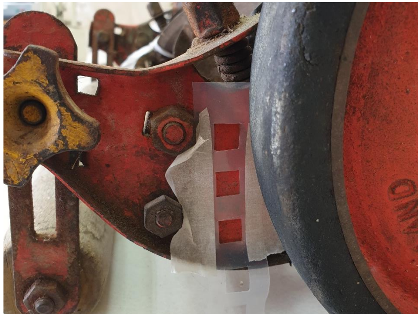
Εικόνα 7.4 Δοκιμές καθαρισμού σε κόκκινη βαφή. © Μουσείο Νερού Μαραθώνα, Εργαστήριο Συντήρησης Μετάλλου Πα.ΔΑ/Μαρίνα Ρώσσιου.
