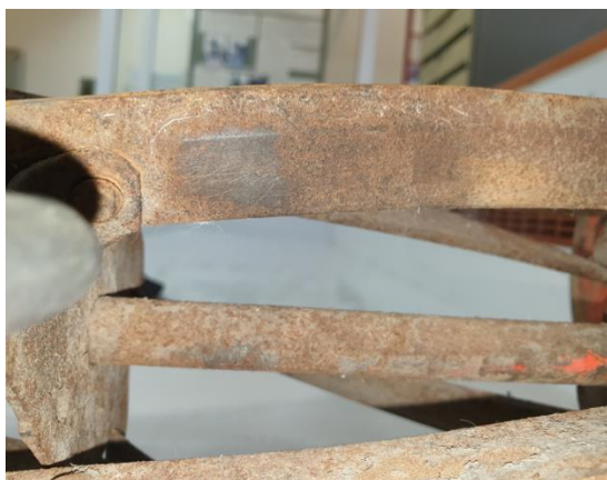
Εικόνα 8.26 Μεταλλικές λεπίδες πριν τον καθαρισμό. © Εργαστήριο Συντήρησης Μετάλλου Πα.ΔΑ/Μαρίνα Ρώσσιου.
