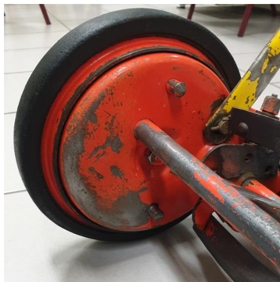
Εικόνα 8.29 Εσωτερικό τροχού μετά τον καθαρισμό. © Εργαστήριο Συντήρησης Μετάλλου Πα.ΔΑ/Μαρίνα Ρώσσιου.
