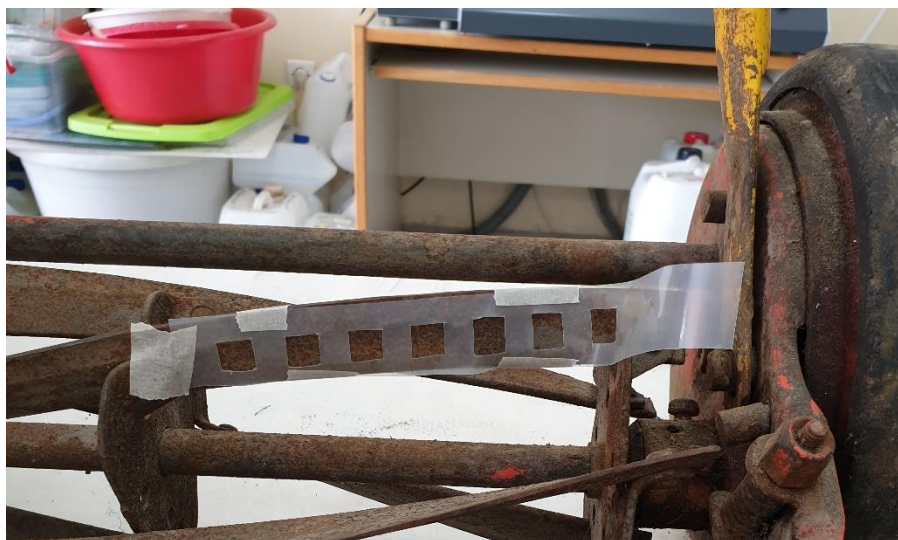
Εικόνα 7.1 Στερέωση φύλλου πολυαιθυλενίου για δοκιμές καθαρισμού. © Μουσείο Νερού Μαραθώνα, Εργαστήριο Συντήρησης Μετάλλου Πα.ΔΑ/Μαρίνα Ρώσσιου.
