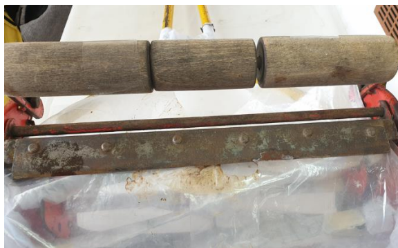
Εικόνα 8.38 Σταθερή μεταλλική λεπίδα πριν τον καθαρισμό με το καυστικό νάτριο. © Εργαστήριο Συντήρησης Μετάλλου Πα.ΔΑ/Μαρίνα Ρώσσιου.
