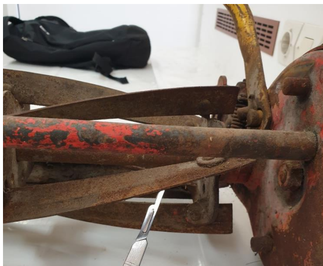
Εικόνα 5.4 Σημείο δειγματοληψία για ανάλυση XRD-XRF. ©Μουσείο Νερού Μαραθώνα, Εργαστήριο Συντήρησης Μετάλλου Πα.ΔΑ/Μαρίνα Ρώσσιου.
