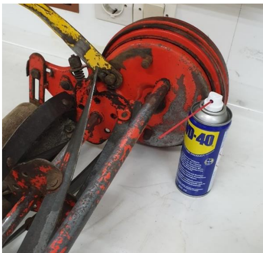
Εικόνα 8.1 Λίπανση σημείων με WD-40. © Μουσείο Νερού Μαραθώνα, Εργαστήριο Συντήρησης Μετάλλου Πα.ΔΑ/Μαρίνα Ρώσσιου.
