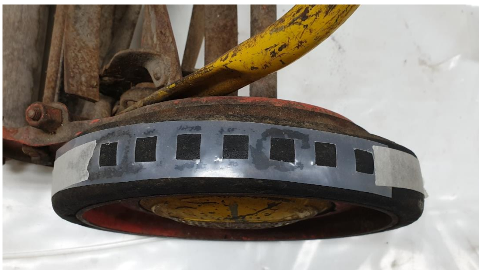
Εικόνα 7.7 Δοκιμές καθαρισμού στο ελαστικό της ρόδας με αιθανόλη 10%, 20% και 30%, απιονισμένο νερό και Texarop 2% v/v. © Μουσείο Νερού Μαραθώνα, Εργαστήριο Συντήρησης Μετάλλου Πα.ΔΑ/Μαρίνα Ρώσσιου.
