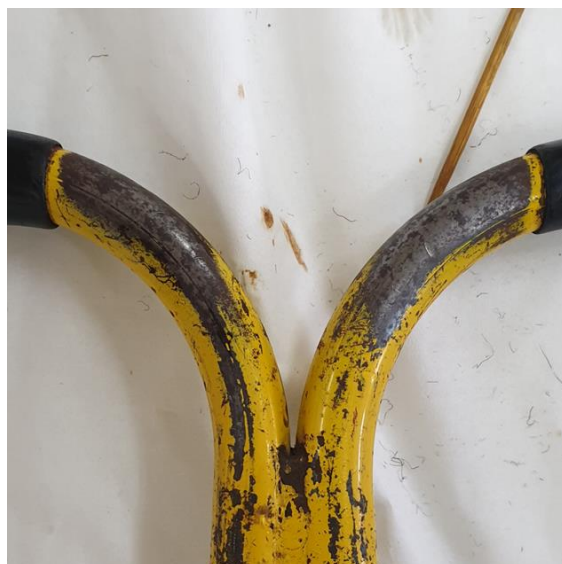
Εικόνα 8.41 Λεπτομέρεια λαβών μετά τον καθαρισμό με καυστικό νάτριο. © Εργαστήριο Συντήρησης Μετάλλου Πα.ΔΑ/Μαρίνα Ρώσσιου.
