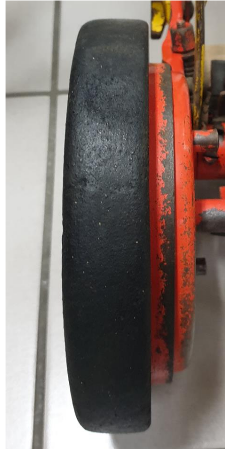
Εικόνα 8.35 Καουτσούκ ρόδας μετά το silicone oil. © Εργαστήριο Συντήρησης Μετάλλου Πα.ΔΑ/Μαρίνα Ρώσσιου.
