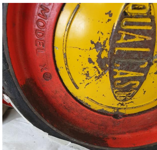
Εικόνα 8.8 Καθαρισμός βαμμένων επιφανειών στην ρόδα. © Μουσείο Νερού Μαραθώνα, Εργαστήριο Συντήρησης Μετάλλου Πα.ΔΑ/Μαρίνα Ρώσσιου.
