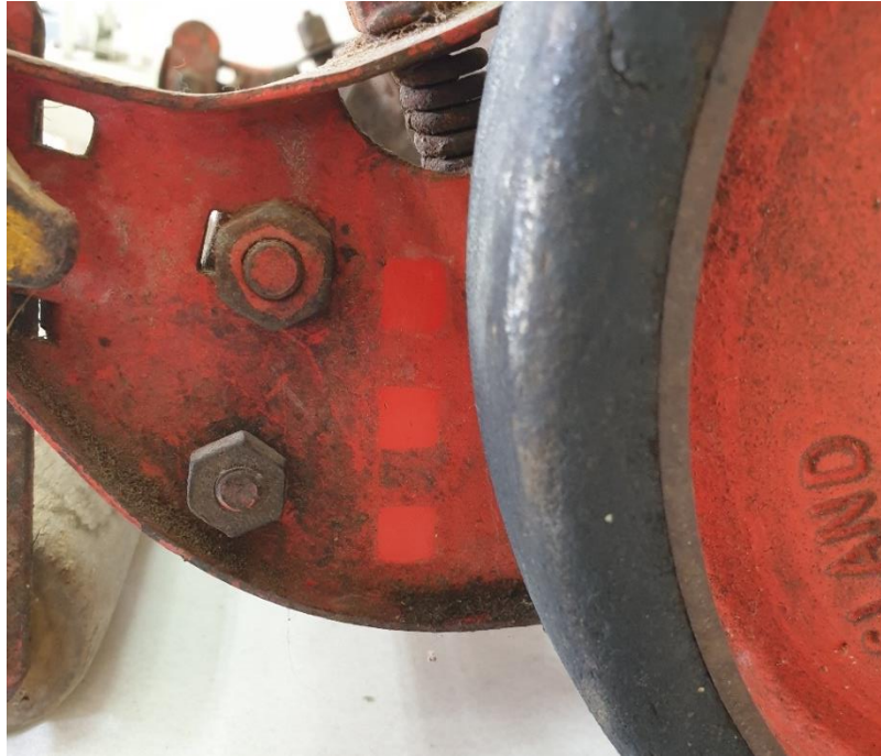
Εικόνα 7.5 Δοκιμή καθαρισμού με ακετόνη 10%, 20% και 30% σε κόκκινη βαφή. © Μουσείο Νερού Μαραθώνα, Εργαστήριο Συντήρησης Μετάλλου Πα.ΔΑ/Μαρίνα Ρώσσιου.
