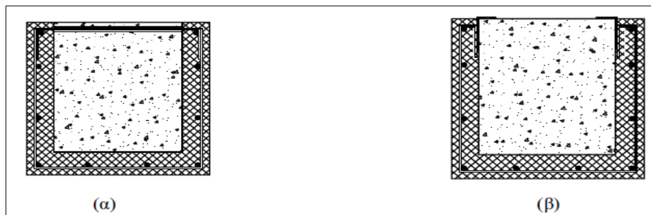
Σχήμα 4.3 Ενίσχυση υποστυλώματος με ανοιχτού τύπου μανδύα ΟΣ. α) αγκύρωση συνδετήρων με διαμπερή οπή και συγκόλληση β) αγκύρωση των συνδετήρων με συγκόλληση σε δύο γωνιακά βλητρωμένα (Σπυράκος 2005)
