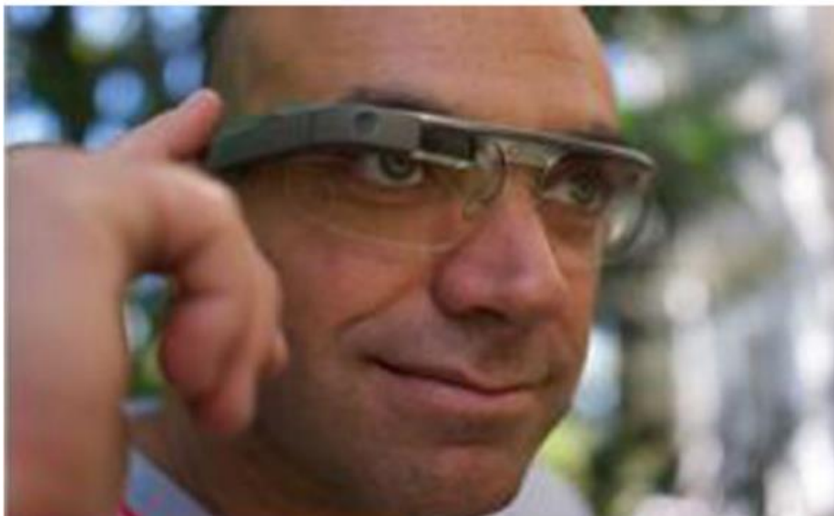
Εικόνα 12 Η συσκευή Google Glass διαθέτει ενσωματωμένη κάμερα, μικρόφωνο, ηχεία, επιφάνεια αφής και πολλούς αισθητήρες (Πηγή: Alkhalifa and Al-Razgan, 2018)
