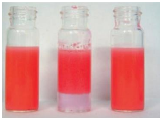
Εικόνα 19: Αριστερά σε ουδέτερο pH, σταθερό γαλάκτωμα – Μέση σε όξινο pH, αφρώδες γαλάκτωμα – Δεξιά μετά από εξουδετέρωση, σταθερό γαλάκτωμα [Cerqueira 2022].
