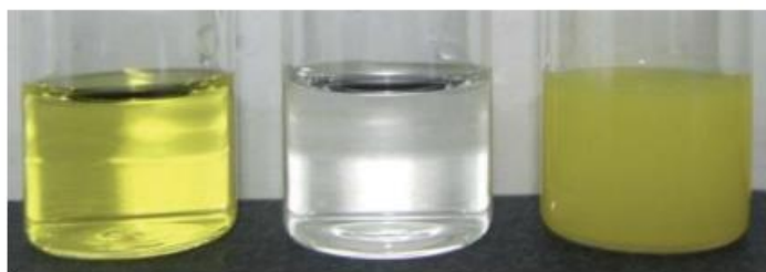
Εικόνα 15: Αναπαράσταση αυθόρμητης συμπλοκοποίησης, αριστερά αλκαλοειδής βερβερίνη, μέση διάλυμα EGCG (επιγαλοκατεχίνη), δεξιά κολλοειδές σύμπλοκο [Patel 2012].
