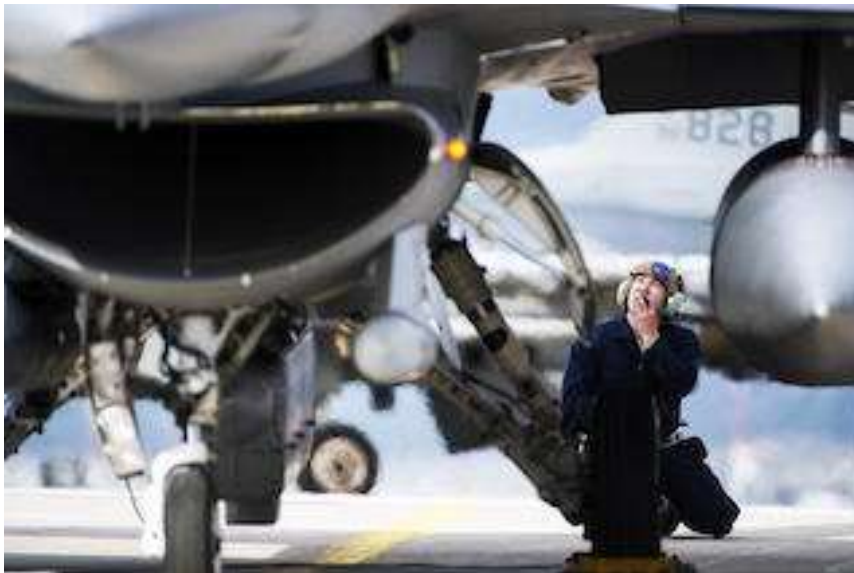
Εικόνα 2.62: Τεχνικός που επιθεωρεί μαχητικό αεροσκάφος F-16 πριν την απογείωσή του
