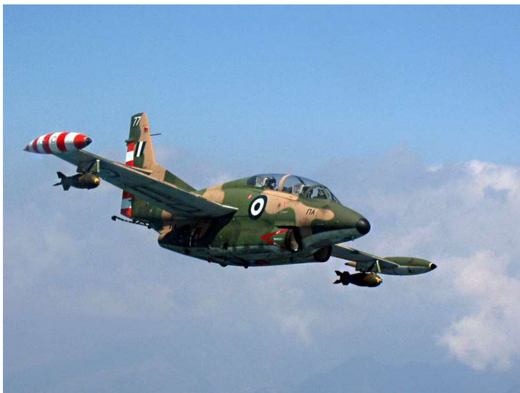
Εικόνα 2.56: Το δικινητήριο αεριοθούμενο αεροσκάφος T-2E buckeye, που χρησιμοποιείται για το προχωρημένο στάδιο πτητικής εκπαίδευσης
