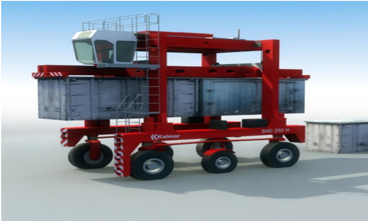
Εικόνα 18 - Shuttle Carrier (SHC)
