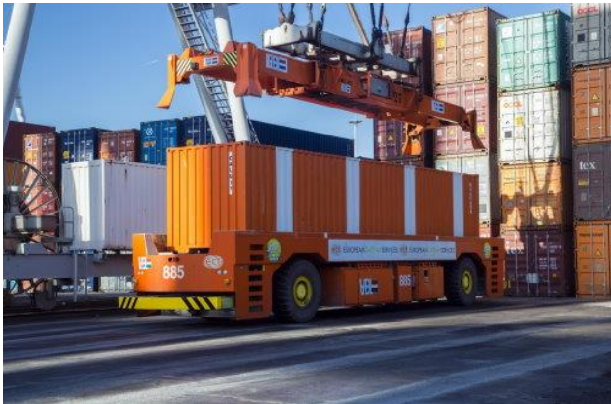
Εικόνα 22 - Automated Guided Vehicles (AGV)
