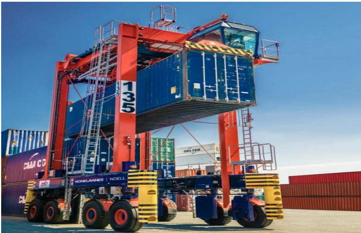
Εικόνα 19 – Straddle Carrier for horizontal transport
