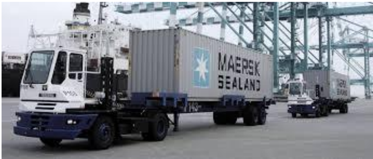
Εικόνα 7 - Νταλικά με συρόμενο - Terminal Tractor w/ chassis (Πηγή: https://portxgroup.com/insights/terberg-terminal-tractors/ )
