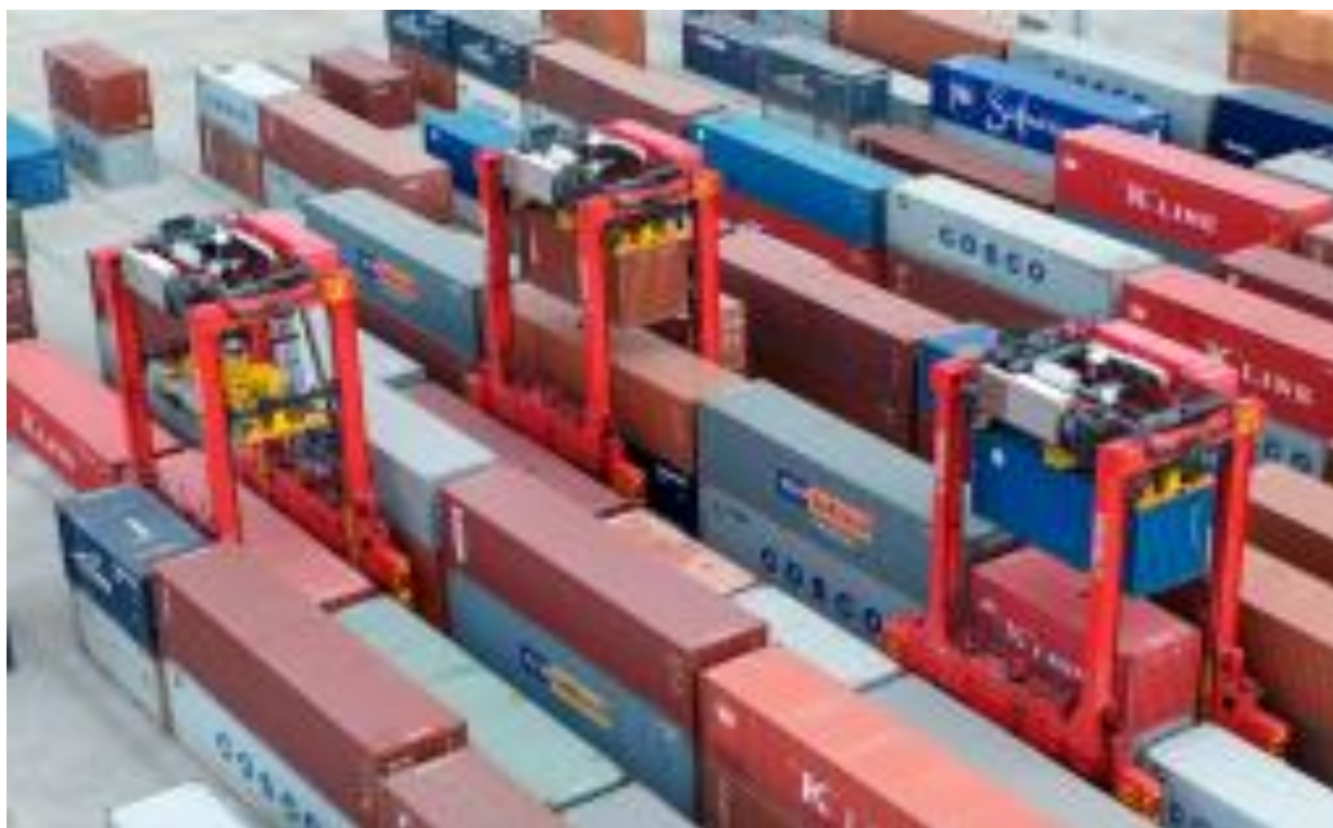
Εικόνα 23 - Straddle Carrier for stacking
