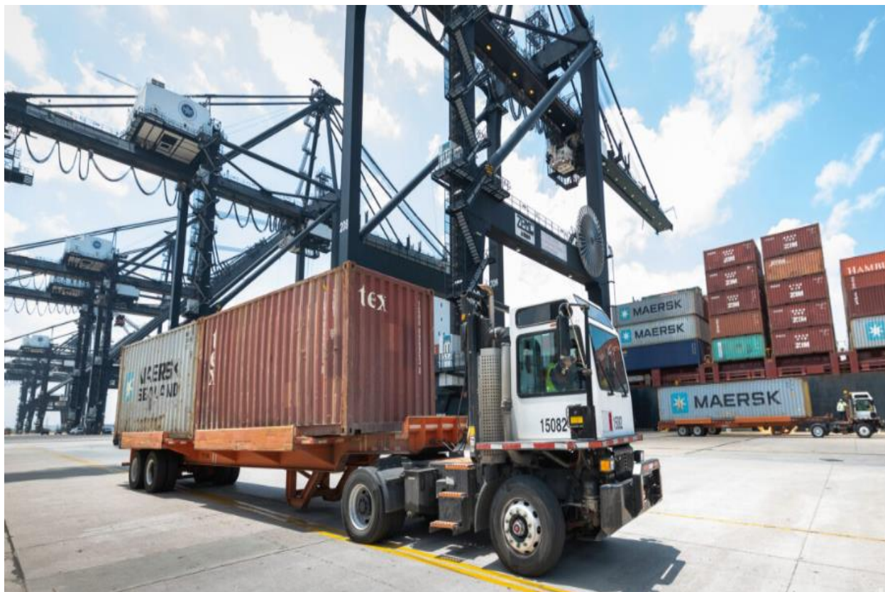
Εικόνα 20 - Terminal Tractor (TTU)
