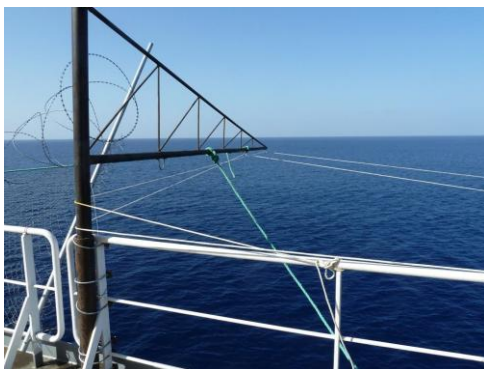
Εικόνα 9: Στηρίγματα και προέκταση για τις παγίδες προπέλας
