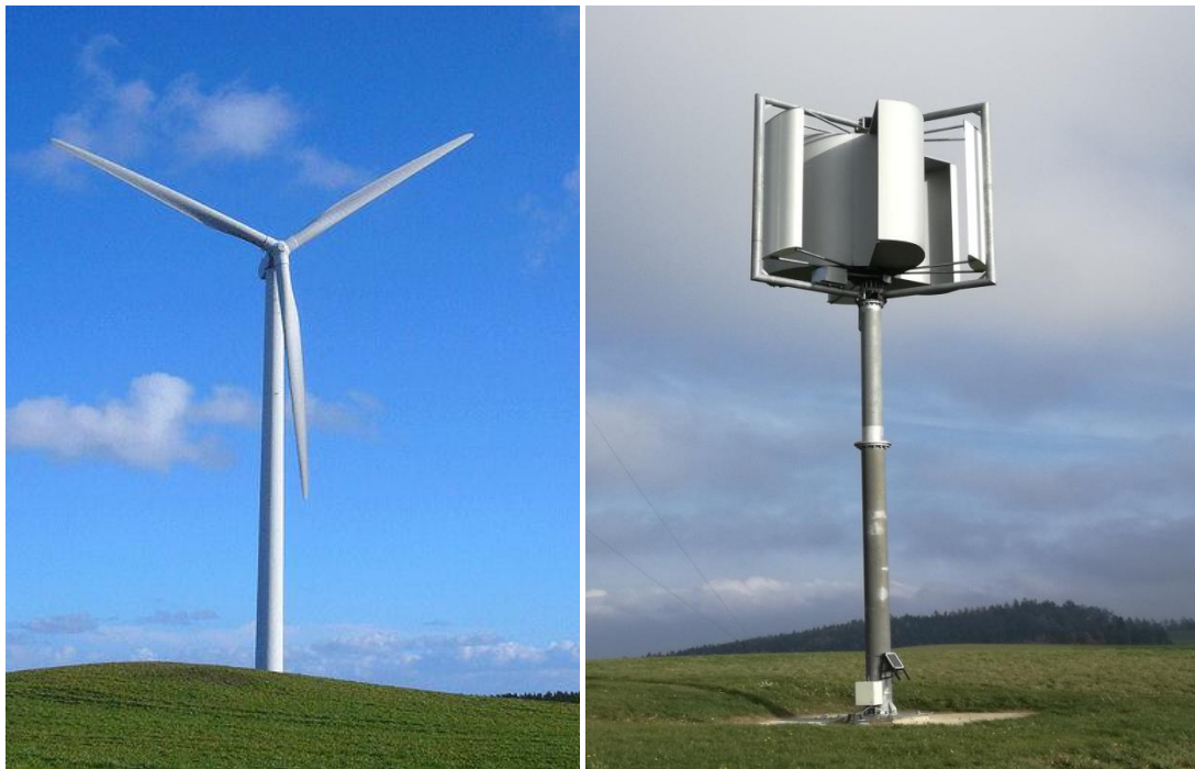
Εικόνα 12: Ανεμογεννήτριες Οριζόντιου Και Κάθετου Άξονα, Πηγή: WordPress.com
