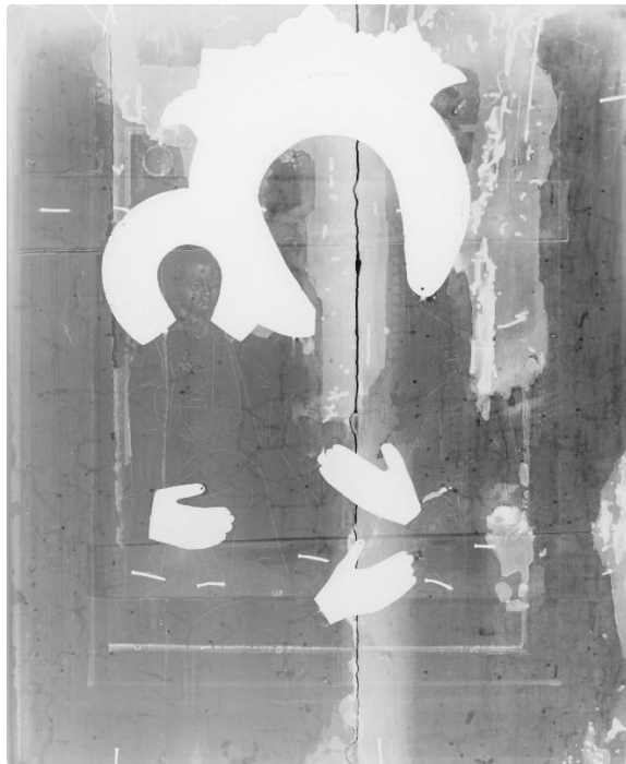
Εικόνα 3-27: Ακτινογραφία (X-ray) σε συσκευή CPI CMP200 (55kVp, 5mAs)
