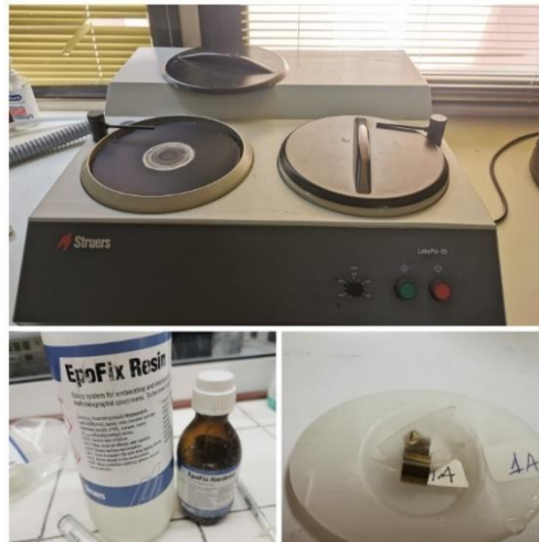
Εικόνα 2-9: Πάνω: Συσκευή λείανσης Struers Κάτω: Η ρητίνη (αριστερά) και σταγόνα στο κλιπ (δεξιά)
