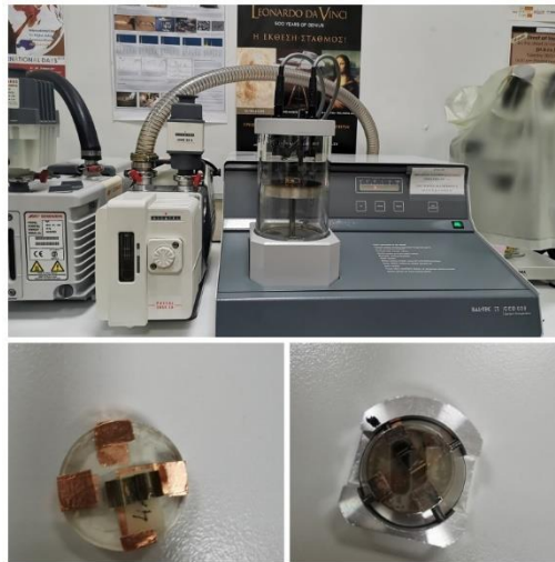
Εικόνα 2-10: Πάνω: η συσκευή επιγραφίτωσης Bal-tec. Κάτω: το δείγμα με την ταινία χαλκού (αριστερά) και στο ειδικό stub (δεξιά)
