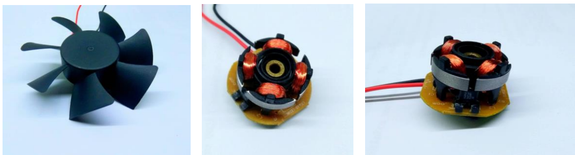
Εικόνα 42 : Ένας κλασσικός BLDC κινητήρας, που χρησιμεύει για την κίνηση σε μικρό ανεμιστήρα από ηλεκτρονικό υπολογιστή. Αποτελείται από δυο φάσεις, ένα ζεύγος πόλων και η ταυτοποίηση της θέσης γίνεται από έναν αισθητήρα Hall. Στην τρίτη εικόνα, φαίνεται ένα ολοκληρωμένο κύκλωμα με 4 ακροδέκτες, τον AH 276 (θα δοθεί και το φυλλάδιο προδιαγραφών). Ο 276 μπορεί να οδηγήσει έναν BLDC μέχρι δυο φάσεις με μέγιστο ρεύμα εξόδου 350 mA.
