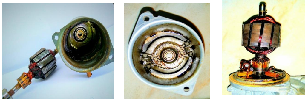
Εικόνα 8: Ένας “καμένος” DC κινητήρας από υψηλή ένταση ρεύματος (γι’ αυτό είναι και λίγο μαύρα τα τυλίγματα). Είναι γερμανικός κινητήρας υψηλής ποιότητας στα 12V. Αριστερά: τα τυλίγματα με τα ελάσματα και η σύνδεσή τους με τον συλλέκτη. Κέντρο: ο στάτης με τον μαγνήτη (βόρειο και νότιο πόλο). Δεξιά: η βάση στην οποία εγκαθίσταται ο ρότορας και εφάπτονται οι ψήκτρες (βρίσκονται εσωτερικά των ψυκτροφορέων).
