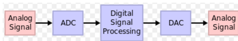
Εικόνα 46 : Άνω: εξωτερική εμφάνιση DSP. Κάτω: η βασική διαδικασία που επιτελούν οι DSPs προκειμένου να γίνει η ψηφιοποίηση και η επεξεργασία δεδομένων, π.χ. φωνής.
