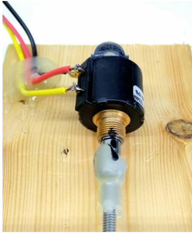
Εικόνα 36 : Το ποτενσιόμετρο που χρησιμοποιήθηκε για αναγνώριση της θέσης του κινητήρα. Την μαύρη γραμμή την σχεδιάσαμε για να ελέγχουμε πότε ολοκληρώνει μια πλήρη περιστροφή ο κινητήρας και να την συγκρίνουμε με τα δεδομένα που παίρνουμε από τον μικροελεγκτή.
