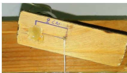
Εικόνα 15: Το 'μπράτσο' των 2cm που χρησιμοποιήθηκε για την υλοποίηση του πειράματος.
