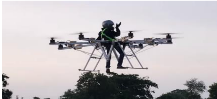
Εικόνα 45 : Μη εργοστασιακός μηχανισμός τύπου drone για την μεταφορά του ανθρώπου, από Ινδό κατασκευαστή.
