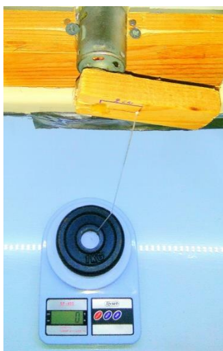
Εικόνα 16: Μηδενισμός της ζυγαριάς με το βάρος πάνω.
