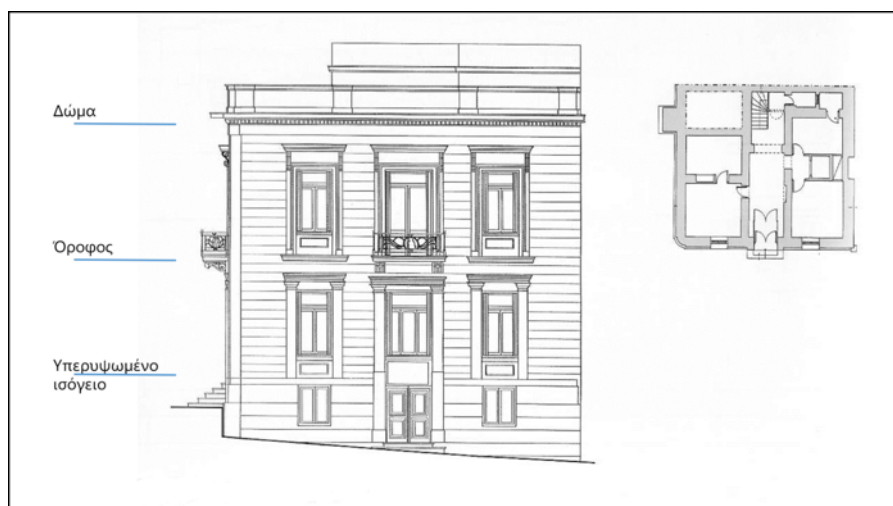
Εικόνα 9. δομή κτηρίου (πηγή: Μπίρης, 2003)
