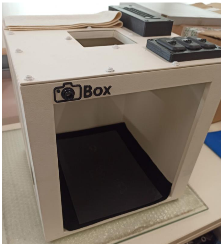
Εικόνα 10: κουτί τοποθέτησης δοκιμίων προς μέτρηση
