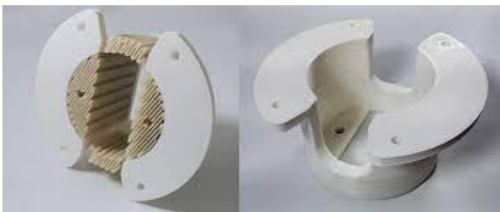
Εικόνα 4: Τεμάχιο εκτυπωμένο με δύο υλικά
