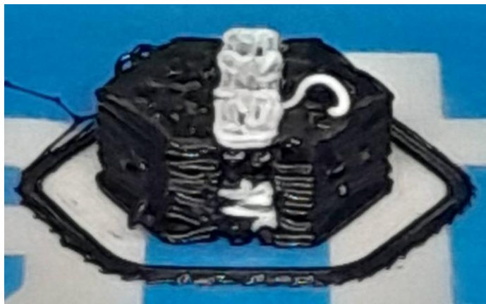
Εικόνα 64: πειραματική εκτύπωση σε όρθια θέση
