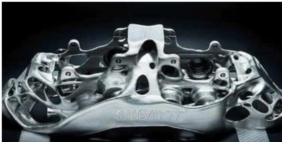
Εικόνα 2: Εκτυπωμένη δαγκάνα φρένου από την Bugatti, κατασκευασμένη από τιτάνιο, (Colombo-Pulgarín, 2022).
