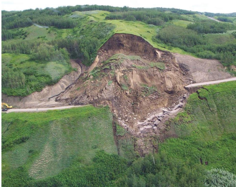
Εικόνα 2.6 - Επίπεδη μεταθετική ολίσθηση που σημειώθηκε το 2001 στην κοιλάδα του ποταμού Beaton, Καναδάς (Highland L. 2008)
