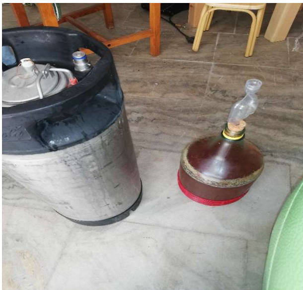
Εικ. 7: 15 Con. Keg ενανθράκωσης - δοχείο ζύμωσης
