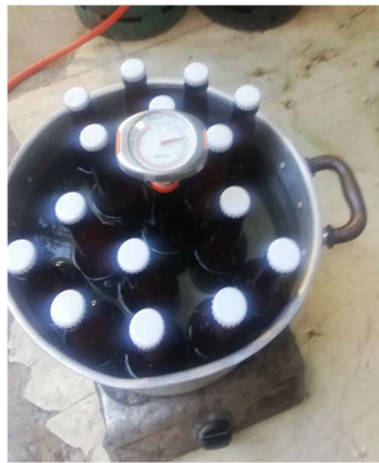
Εικ. 7: 17 Διαδικασία παστερίωσης σε 3 φάσεις με σταδιακή μεταβολή της θερμοκρασίας
