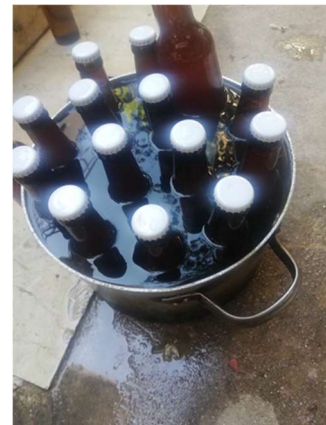
Εικ. 7: 17 Διαδικασία παστερίωσης σε 3 φάσεις με σταδιακή μεταβολή της θερμοκρασίας
