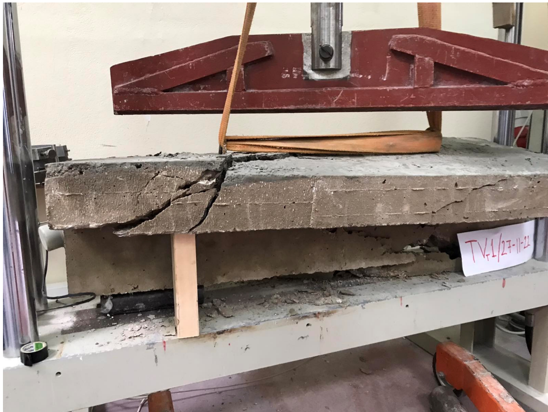
Εικόνα 30-31 : Εμφάνιση διατμητικών ρωγμών (εμπρόσθια όψη)
