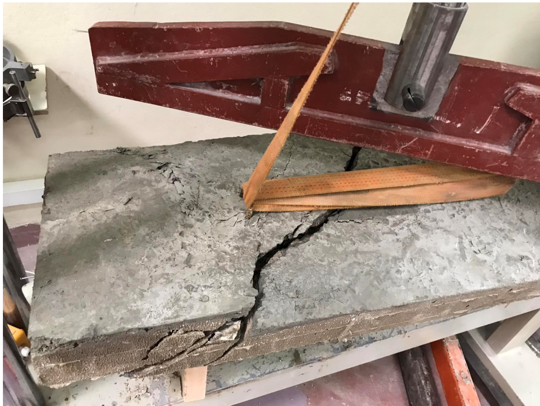
Εικόνα 28-29 : Πλακοδοκός αμέσως μετά την θραύση
