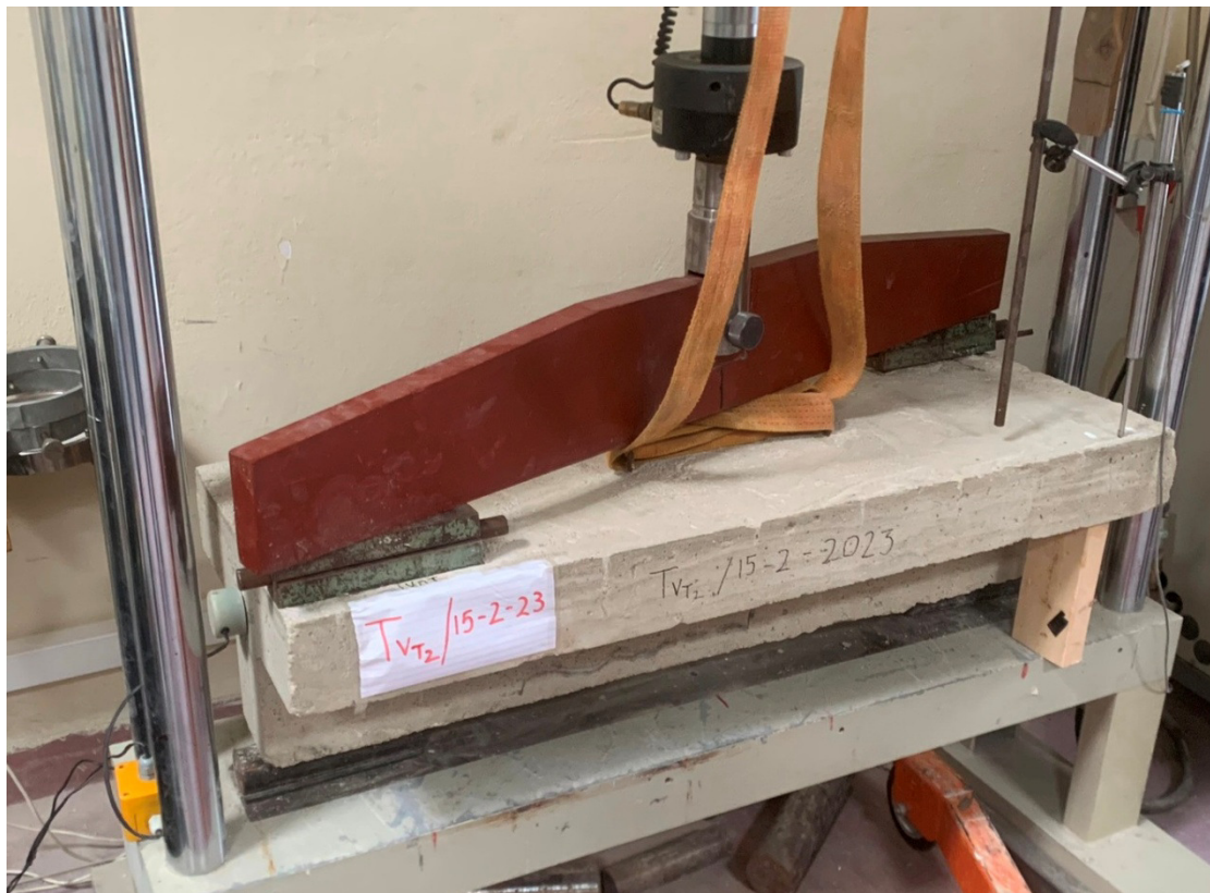
Εικόνα 41-42 : Τοποθέτηση δεύτερου πειράματος στρέψης στην πρέσα και τοποθέτηση μετρητών στις αντίστοιχες θέσεις τους.
