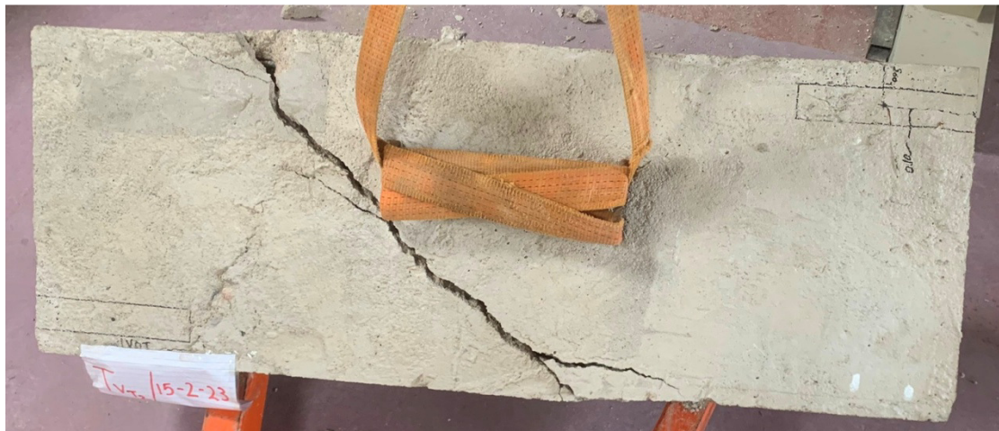
Εικόνα 43-44 : Δοκός TV T2 /15-02-2023 αμέσως μετά την επιβολή φορτίου μέχρι το σημείο διαρροής της.
