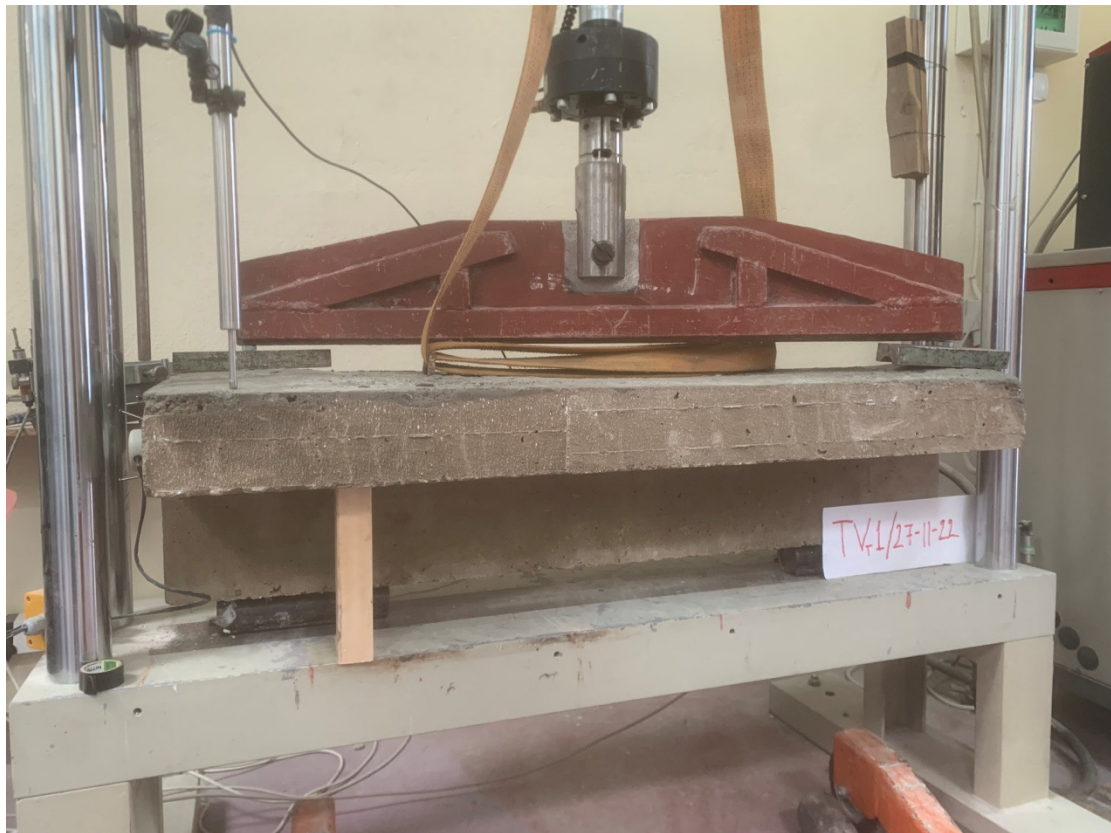
Εικόνα 26-27 : Τοποθέτηση πλακοδοκού στο τραπέζι φόρτισης (2)
