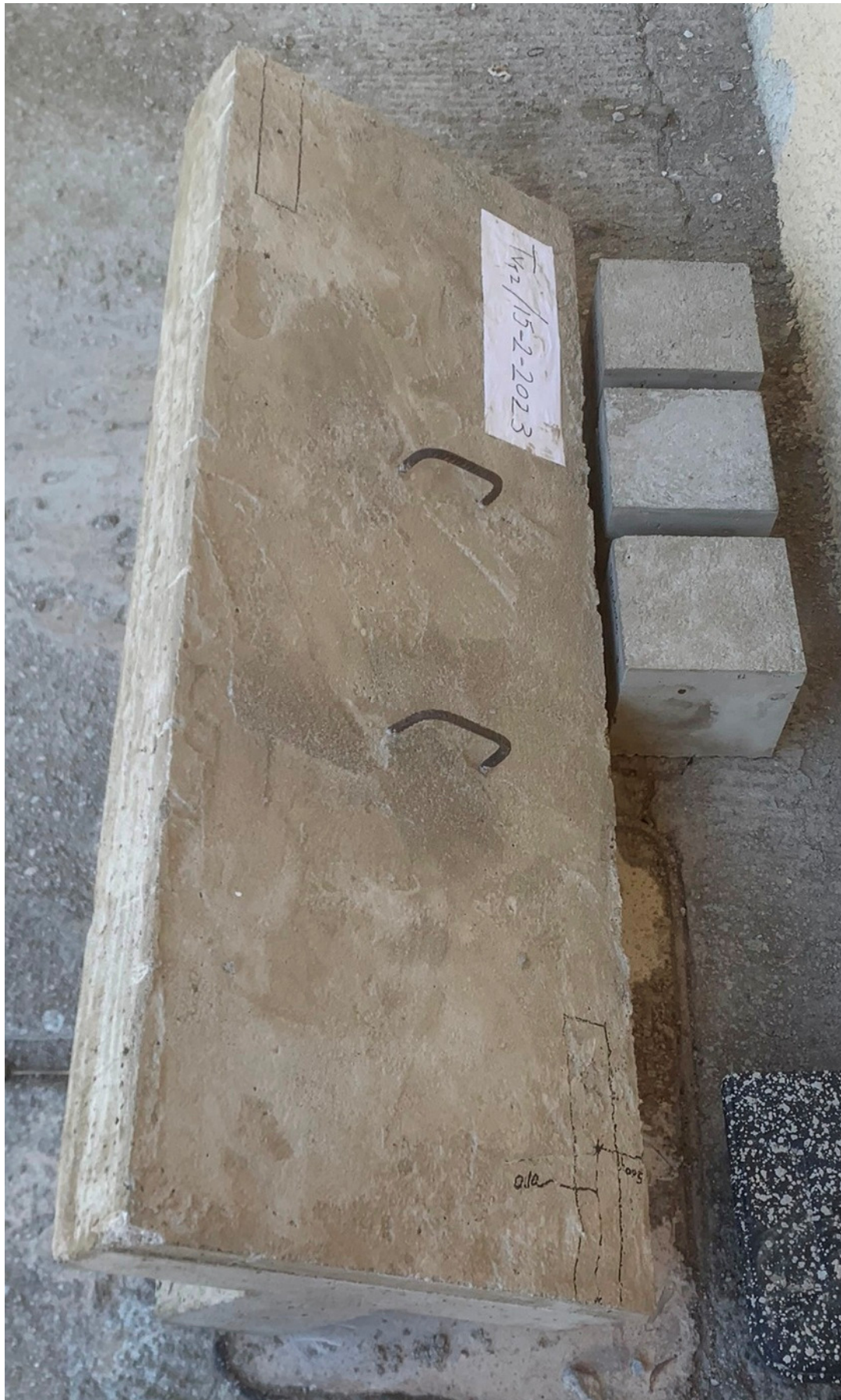
Εικόνα 40 : Ένδειξη θέσεων επιβολής φορτίων πάνω στη πλακοδοκό
