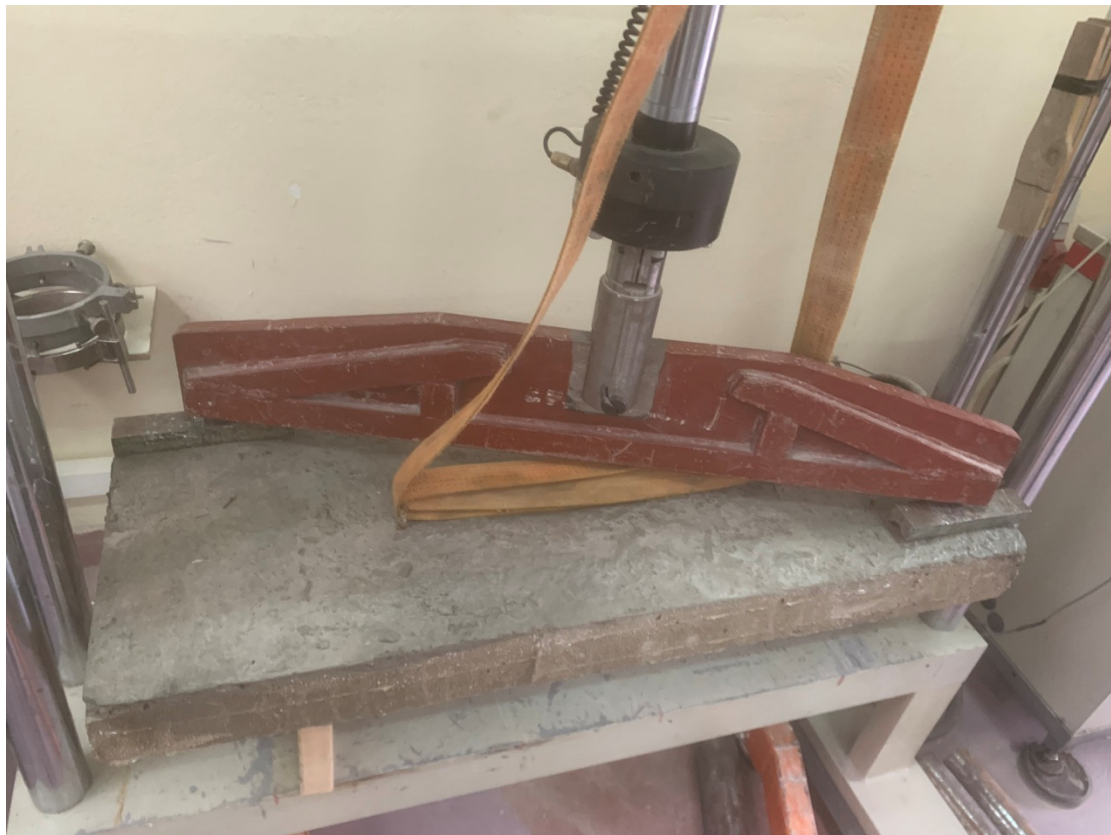
Εικόνα 24-25 : Τοποθέτηση πλακοδοκού στο τραπέζι φόρτισης (1)
