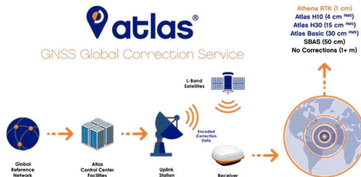
Εικόνα 7 Απλοποιημένη αναπαράσταση της λειτουργίας του συστήματος Atlas
