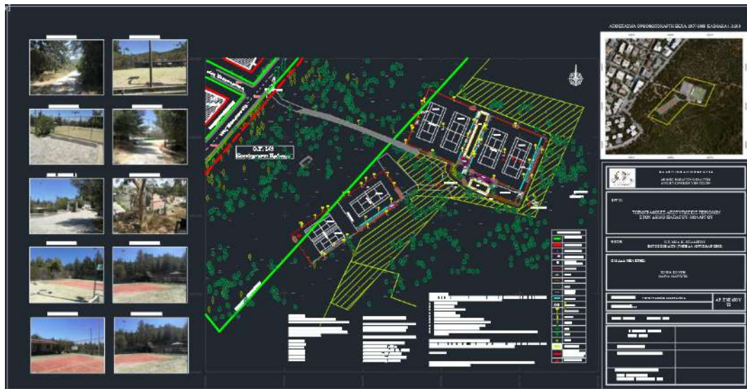
Εικόνα 106 Τοπογραφικό διάγραμμα τένις Ο.Τ.143 σε λογισμικό AutoCAD
