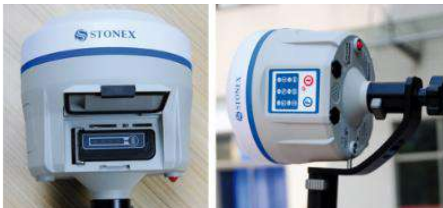
Εικόνα 10 Δέκτης GNSS Stonex S10A Atlas
