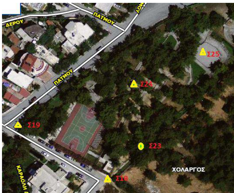
Εικόνα 31 Απεικόνιση των κορυφών της όδευσης του Ο.Τ.190α σε υπόβαθρο ορθοφωτοχάρτη Κτηματολόγιο ΑΕ.
