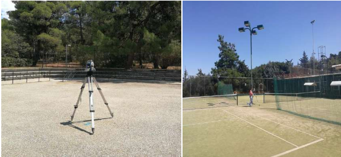
Εικόνα 46 Μετρήσεις στο πεδίο με γεωδαιτικό σταθμό
