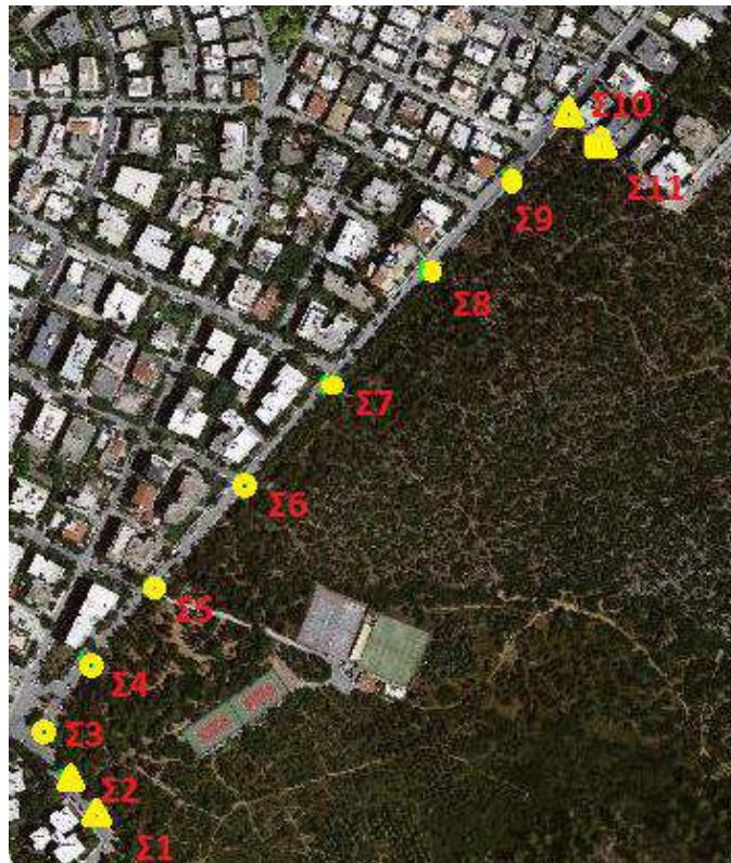
Εικόνα 22 Απεικόνιση των κορυφών της όδευσης του Ο.Τ.142α - 143 σε υπόβαθρο ορθοφωτοχάρτη Κτηματολόγιο ΑΕ.
