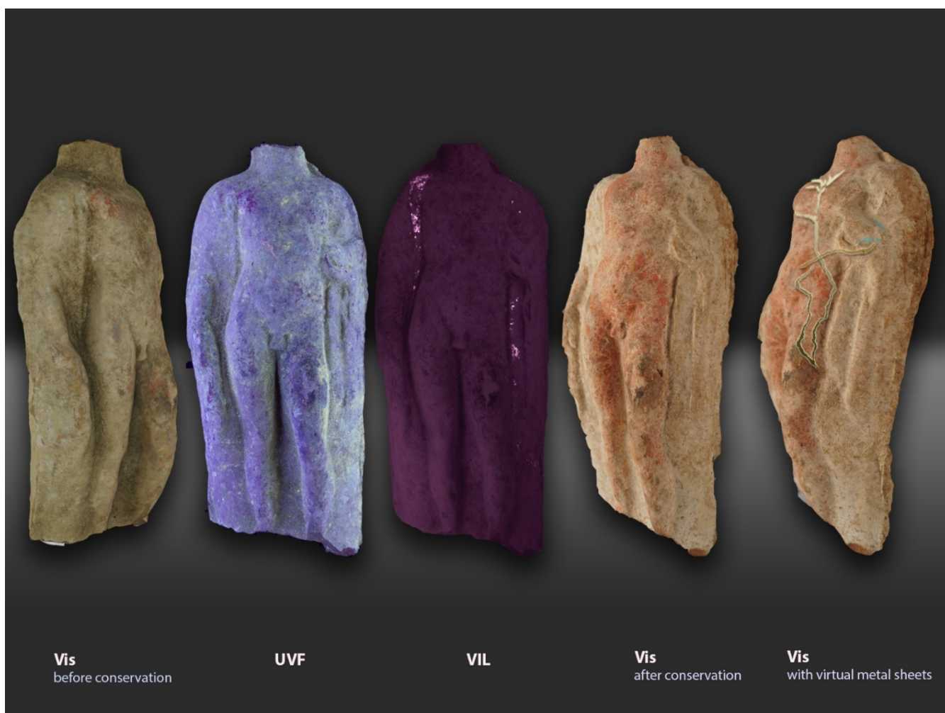
Εικόνα 82 Απεικόνιση Vis, UVF και VIL πριν και Vis μετά τη συντήρηση μαζί με μέρος ένθετων μεταλλικών στοιχείων που ολοκληρώνουν το τελικό αποτέλεσμα.
