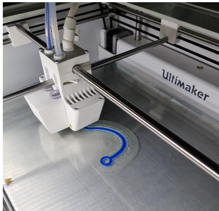
Εικόνα 49 Ενδιάμεσο στάδιο εκτύπωσης του hook του 1 ου μοντέλου
