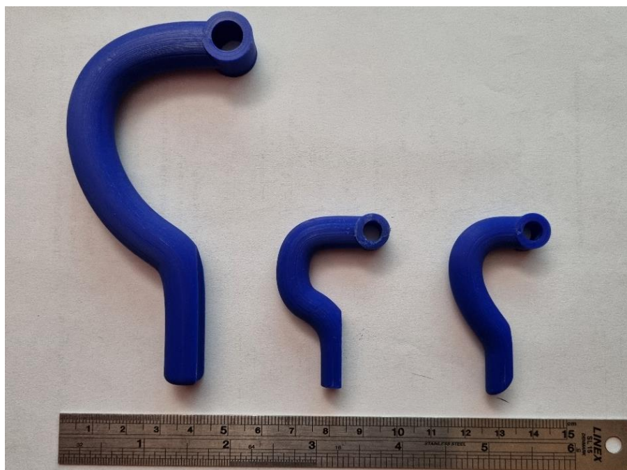
Εικόνα 97 Σύγκριση εκτυπωμένων γάντζων (hook) 1 ου , 2 ου , 3 ου μοντέλου
