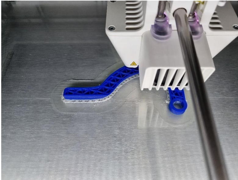
Εικόνα 50 Απεικόνιση του μοτίβου του hook του 1 ου μοντέλου
