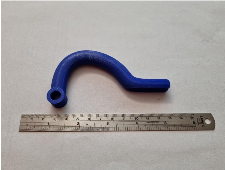
Εικόνα 54 Τελικό αποτέλεσμα εκτυπωμένου hook του 1 ου μοντέλου
