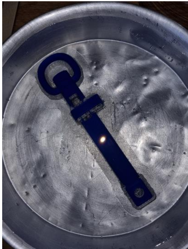
Εικόνα 45 Εμβάπτιση σε νερό για τη διάλυση του υποστηρικτικού υλικού
