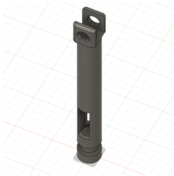
Εικόνα 19 Σχεδιασμός κορμού (rod) 1 ου μοντέλου
