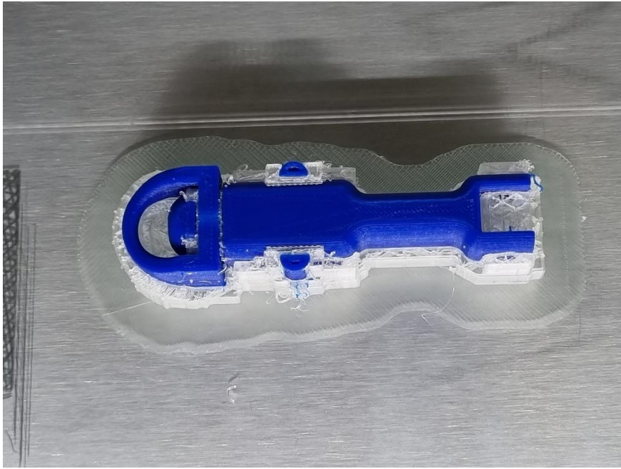
Εικόνα 87 Ενδιάμεσο στάδιο εκτύπωσης
