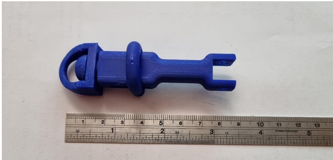
Εικόνα 89 Τελικό αποτέλεσμα εκτυπωμένου rod-release-swivel 3 ov μοντέλου 1 η όψη
