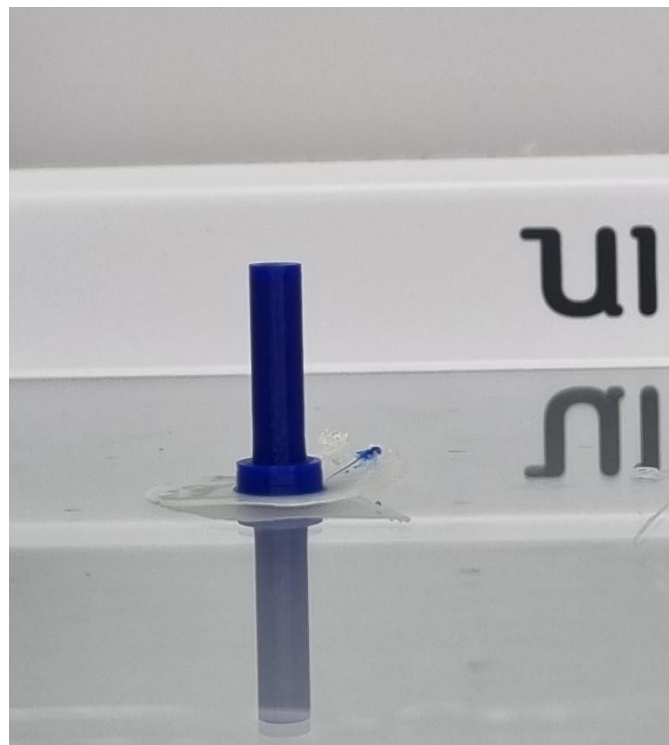
Εικόνα 72 Ενδιάμεσο στάδιο εκτύπωσης βίδας (bolt) 2 ου μοντέλου
