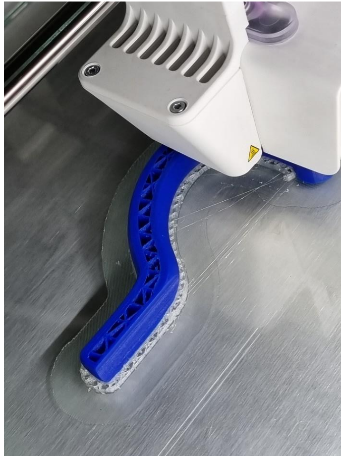
Εικόνα 51 Απεικόνιση των εξωτερικών τοιχωμάτων του hook του 1 ου μοντέλου
