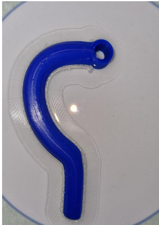
Εικόνα 53 Εμβάπτιση σε νερό για τη διάλυση του υποστηρικτικού υλικού
