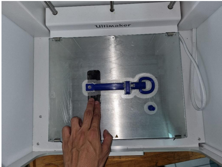
Εικόνα 44 Προσεκτική αφαίρεση εκτυπωμένου μοντέλου από το τραπέζι του εκτυπωτή
