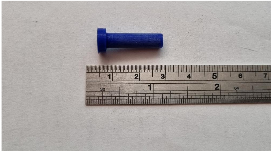
Εικόνα 73 Τελικό αποτέλεσμα εκτυπωμένης βίδας (bolt) 2 ο μοντέλου
