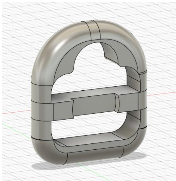
Εικόνα 78 Βελτιστοποίηση σχεδιασμού εξαρτήματος απελευθέρωσης (release) 3 ο μοντέλου
