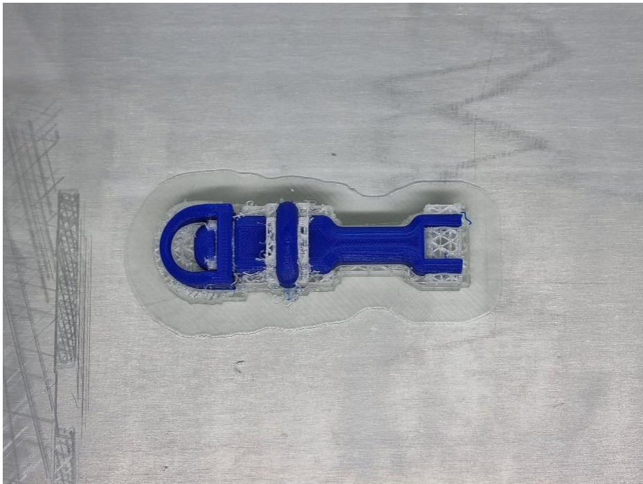
Εικόνα 88 Τελικό στάδιο εκτύπωσης
