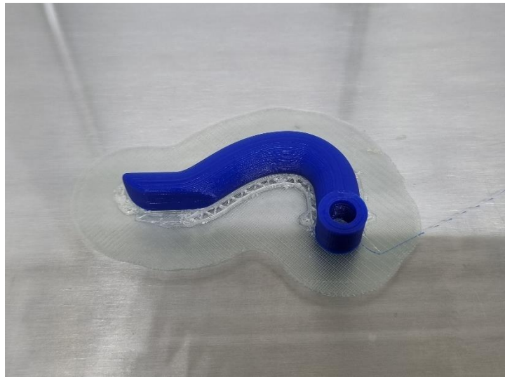
Εικόνα 92 Τελικό στάδιο εκτύπωσης hook του 3 ου μοντέλου
