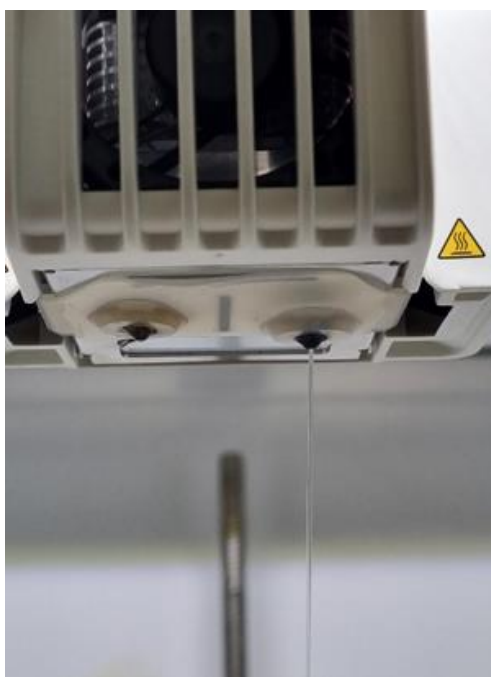
Εικόνα 35 Ομοιόμορφη έκχυση νήματος PVA natural
