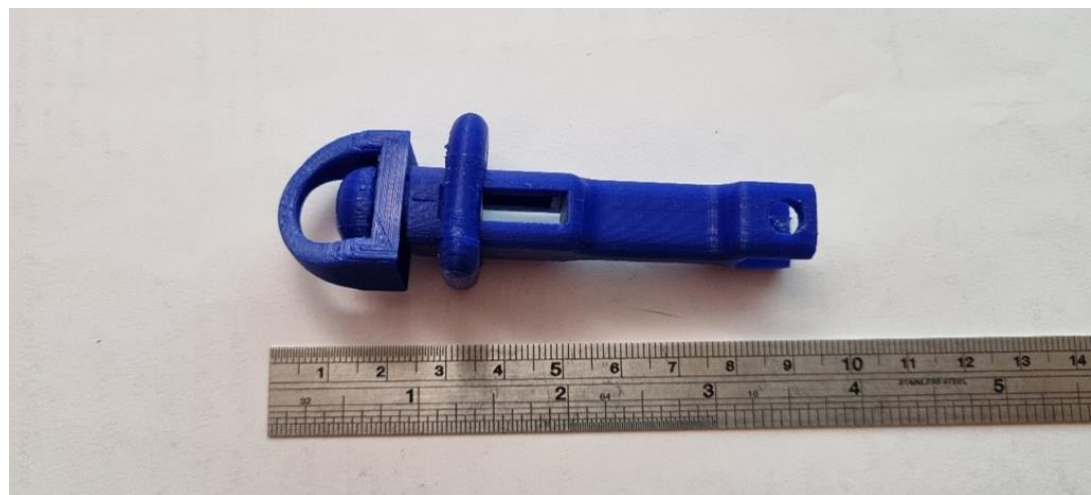
Εικόνα 90 Τελικό αποτέλεσμα εκτυπωμένου rod-release-swivel 3 ov μοντέλου 2 η όψη
