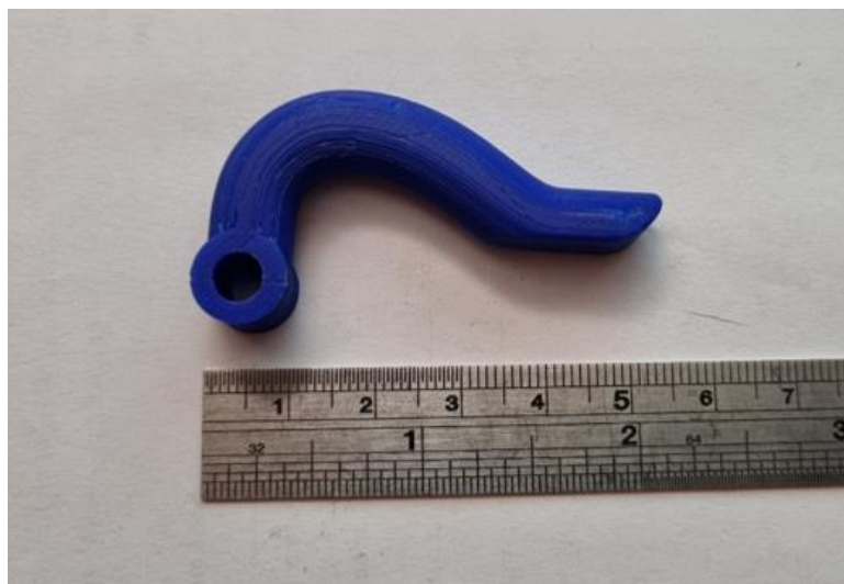
Εικόνα 92 Τελικό στάδιο εκτύπωσης hook του 3 ου μοντέλου
