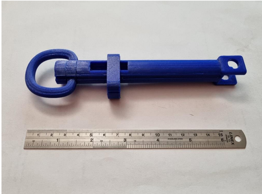
Εικόνα 46 Τελικό αποτέλεσμα εκτυπωμένου rod-release-swivel 1 ου μοντέλου
