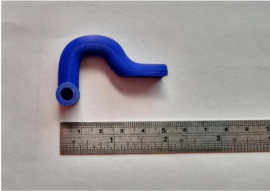
Εικόνα 71 Τελικό αποτέλεσμα εκτυπωμένου hook του 2 ου μοντέλου
