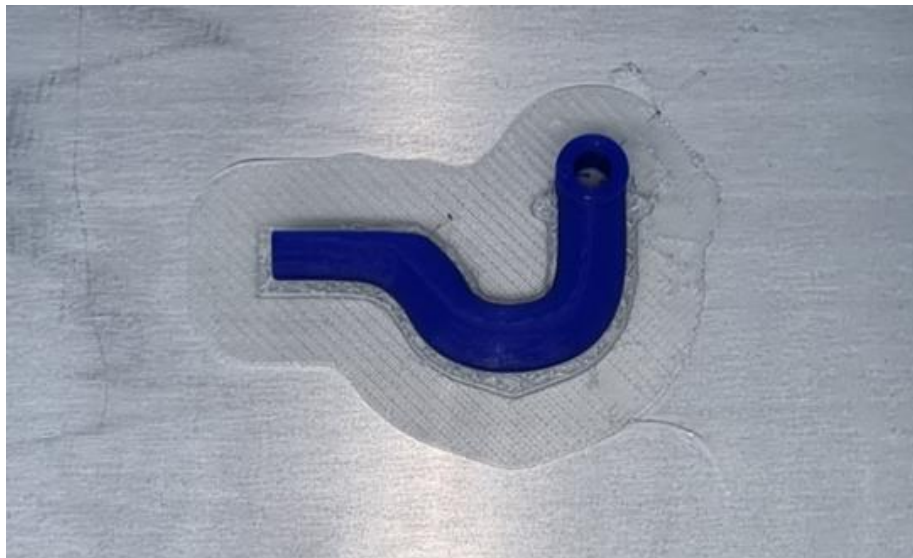
Εικόνα 70 Τελικό στάδιο εκτύπωσης hook του 2 ου μοντέλου
