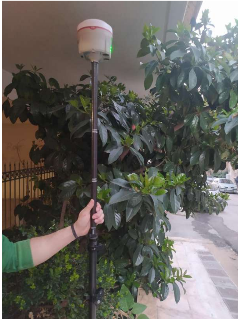
Εικόνα 29 Μετρήσεις με δέκτη RTK στο πεδίο
