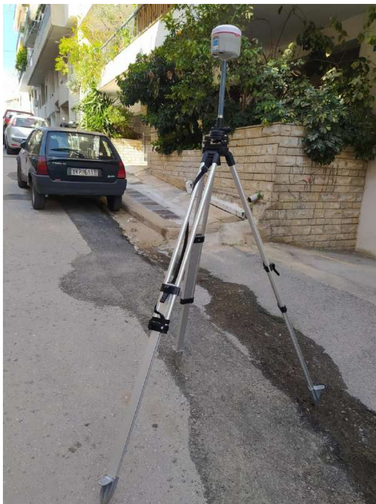
Εικόνα 27 Στατικές μετρήσεις στο πεδίο
