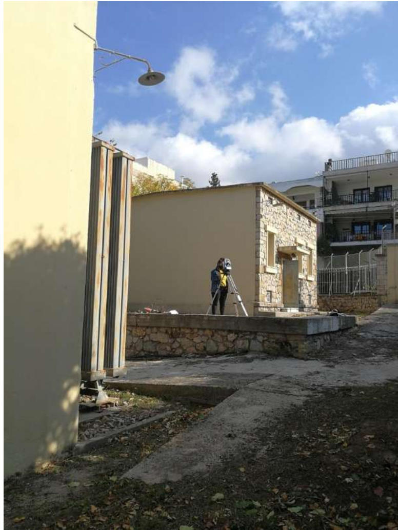
Εικόνα 31 Μετρήσεις από τη «τυφλή» στάση στο προαύλιο της ΔΕΗ
