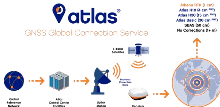
Εικόνα 7 Απλοποιημένη αναπαράσταση της λειτουργίας του συστήματος Atlas
