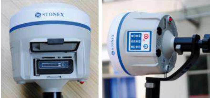
Εικόνα 10 Δέκτης GNSS Stonex S10A Atlas
