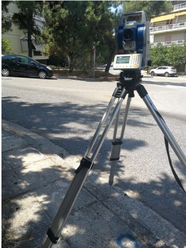
Εικόνα 30 Μετρήσεις στο πεδίο με γεωδαιτικό σταθμό
