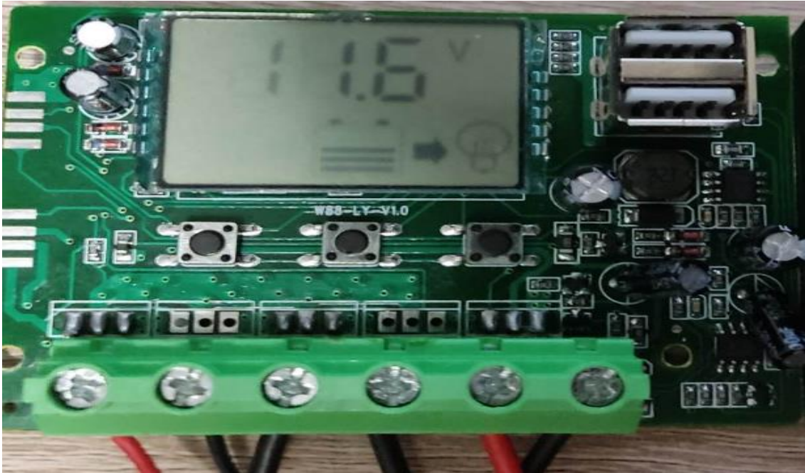
Εικόνα 3.19: Τάση προστασίας μπαταρίας από under voltage μέσω του MPPT
