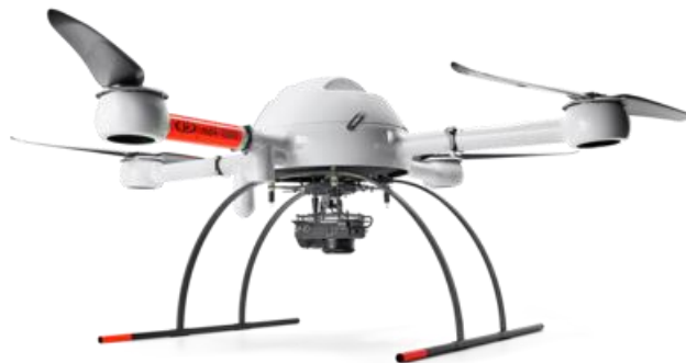
Εικόνα 2.6: Microdrones τετρακόπτερο σχεδιασμένο για ερευνητικούς σκοπούς
