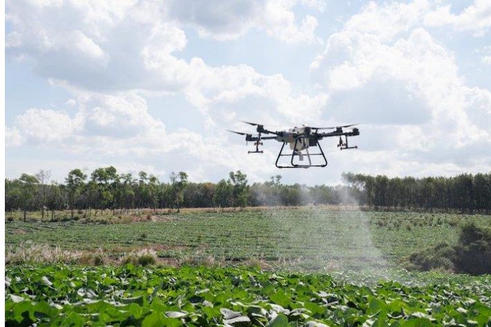
Εικόνα 2.2: Drone της DJI Agras T30 για χρήση στην γεωργία
