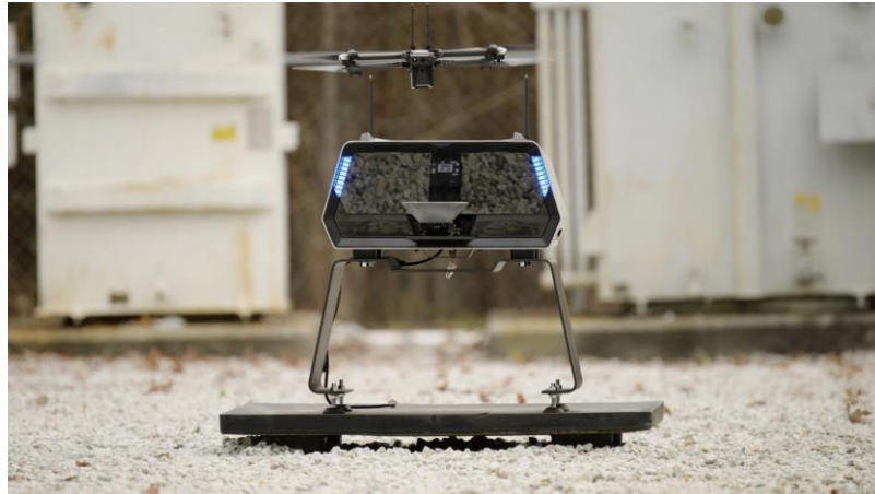
Εικόνα 2.4: Drone-in-a-box solutions της SKYDIO για χρήση στην επιθεώρηση υποδομών
