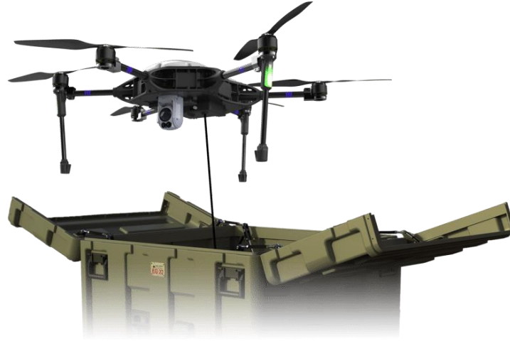
Εικόνα 2.5: Raptor SAM'S-Hybrid drone σχεδιασμένο για στρατιωτικές επιχειρήσεις επίβλεψης
