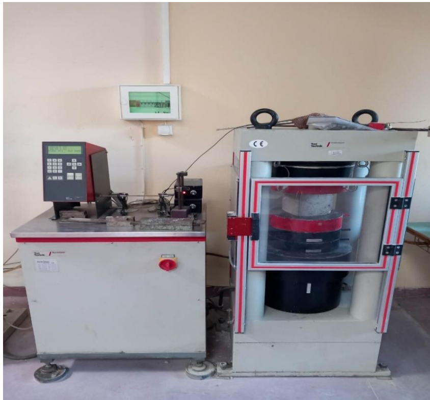
Εικόνα 3.1 Η μηχανή κεντρικής θλίψης για τον υπολογισμό της θλιπτικής αντοχής σκυροδέματος, Εργαστήριο Σκυροδέματος ΠΑΔΑ.
