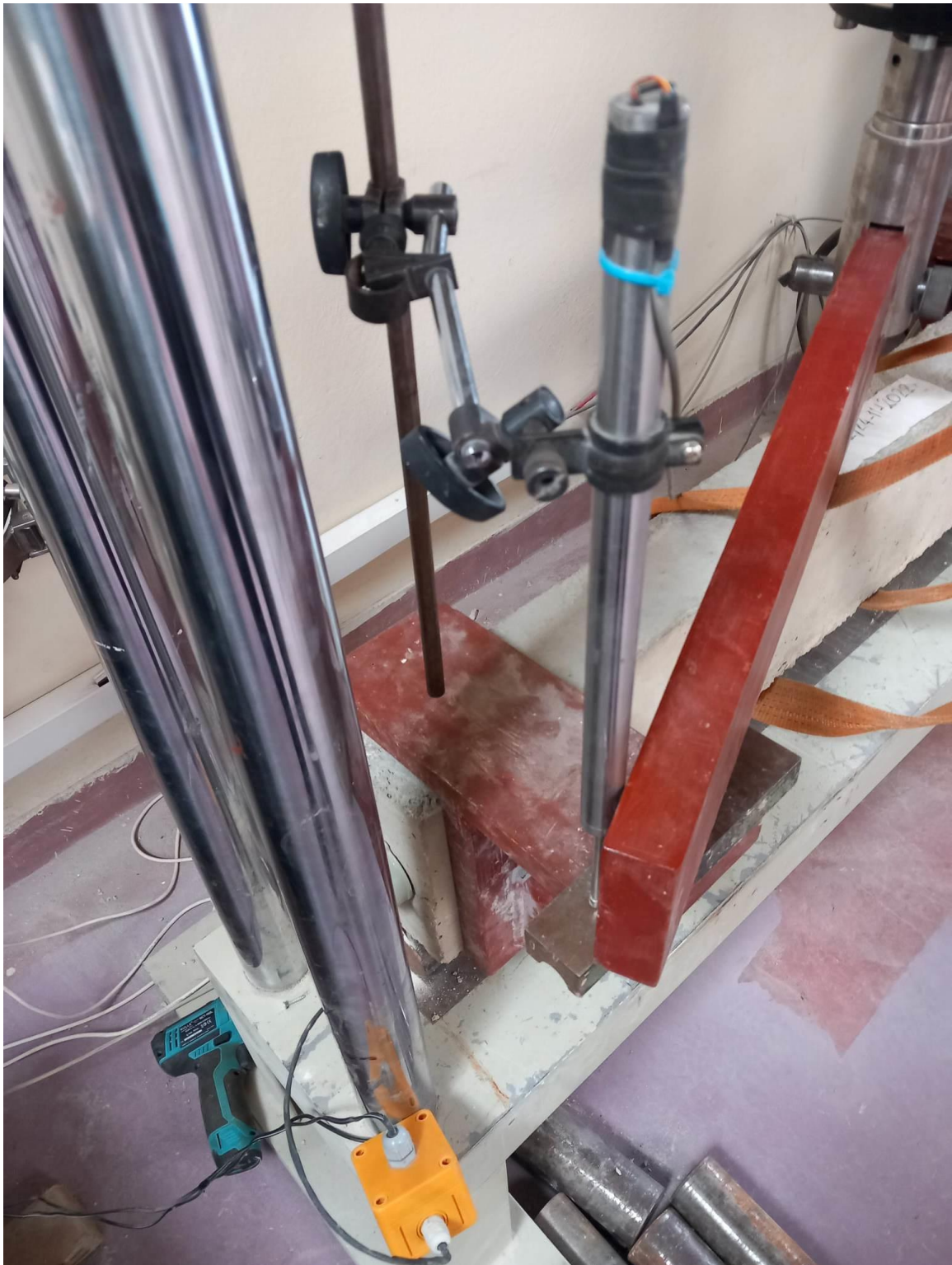
Εικόνα 3.6 Λεπτομέρεια της πειραματικής διάταξης. Διακρίνονται το μπράτσο, το πλακάκι, ο ένας κλάδος του εμβόλου και ο αισθητήρας LVDT.
