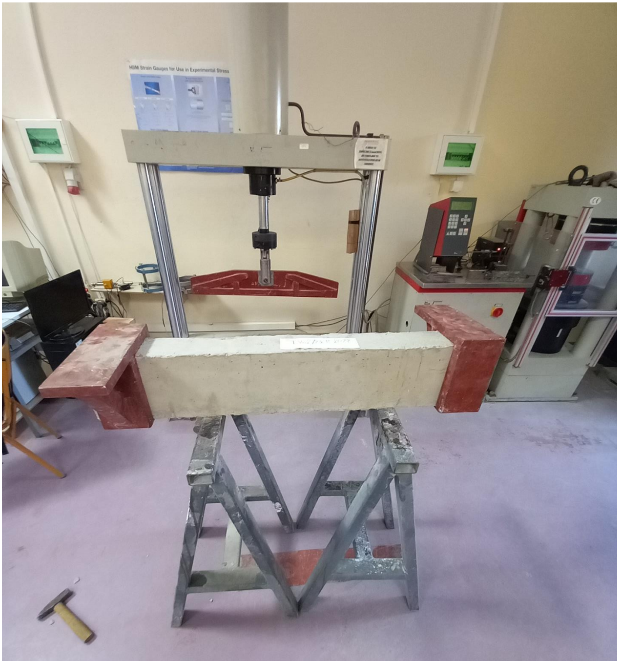
Εικόνα 3.4 Η τοποθέτηση των 2 μπράτσων στις δοκούς. Στο βάθος διακρίνεται και το έμβολο που χρησιμοποιείται στη διάταξη της στρέψης.
