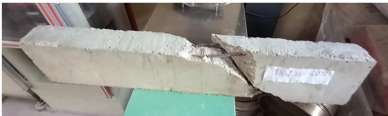
Εικόνα 4.7 Η δοκός μετά την αστοχία της. Διακρίνεται η επιφάνεια θραύσης και οι διαμήκεις οπλισμοί της.
