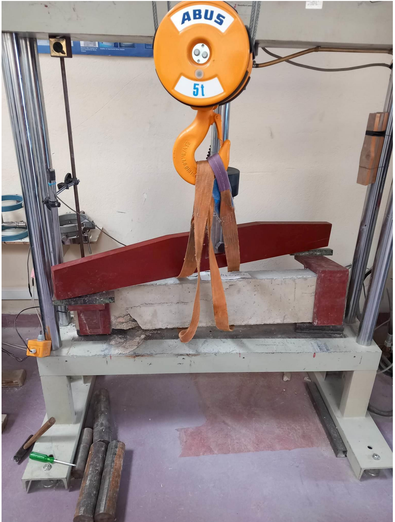
Εικόνα 3.9 Αστοχία της δοκού με θραύση του σκυροδέματος κοντά στο αριστερό άκρο της.
