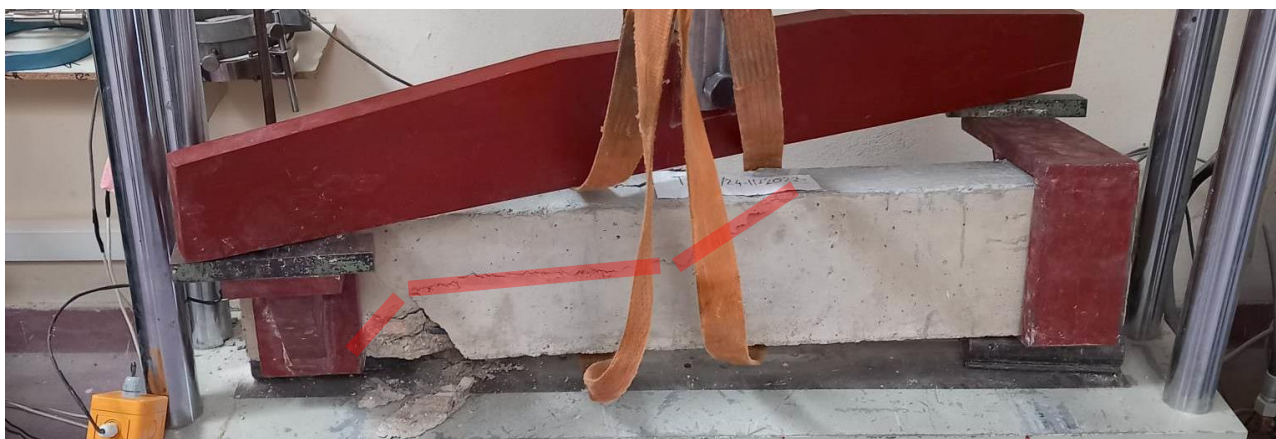
Εικόνα 4.6 Θραύση του σκυροδέματος κοντά στο αριστερό άκρο της δοκού λόγω λοξής θλίψης.
