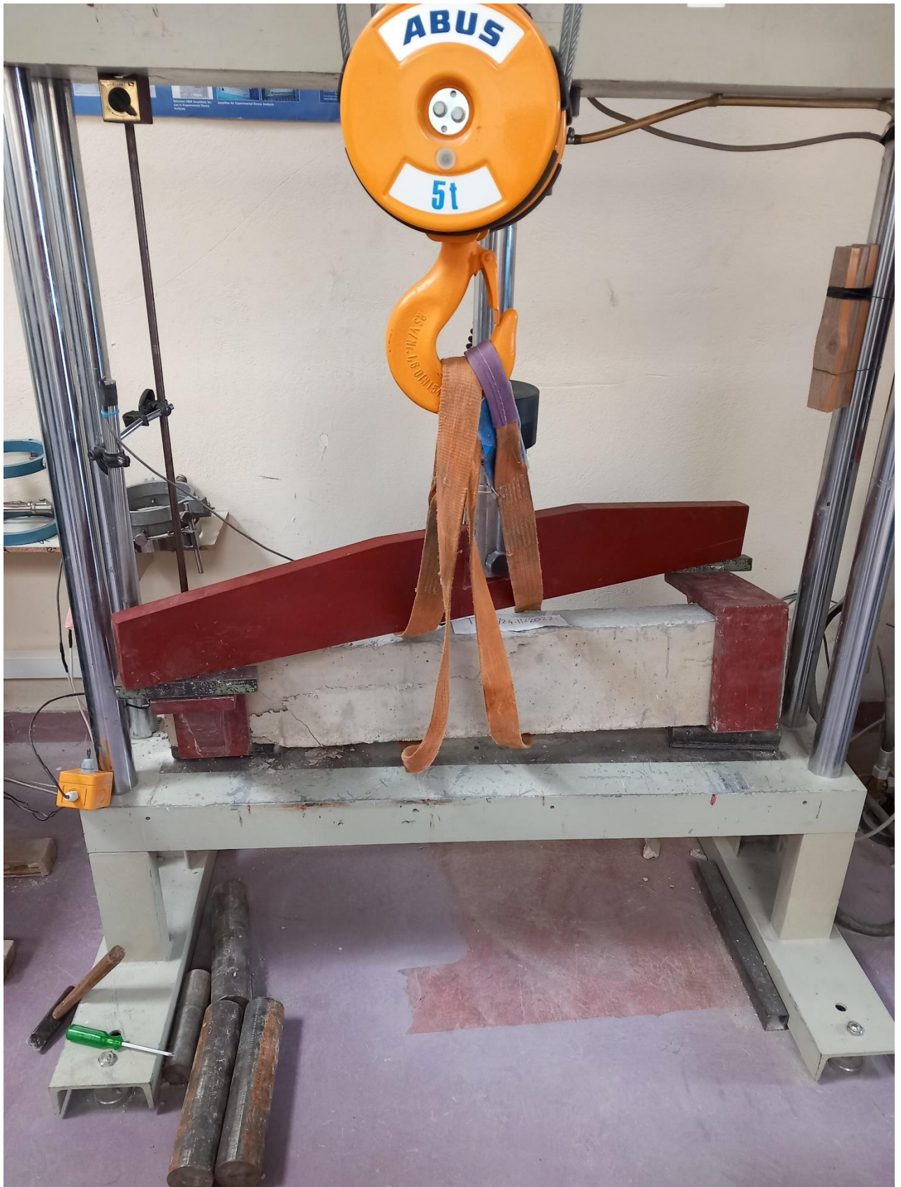
Εικόνα 3.8 Εμφάνιση ρωγμών κοντά στο αριστερό άκρο της δοκού κατά τη διάρκεια της φόρτισης.
