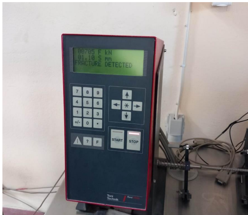
Εικόνα 3.2 Αποτελέσματα θραύσης κυβικού δοκιμίου 200x200x200mm, F 00705 KN, S 01.10mm, Εργαστήριο Σκυροδέματος ΠΑΔΑ.
