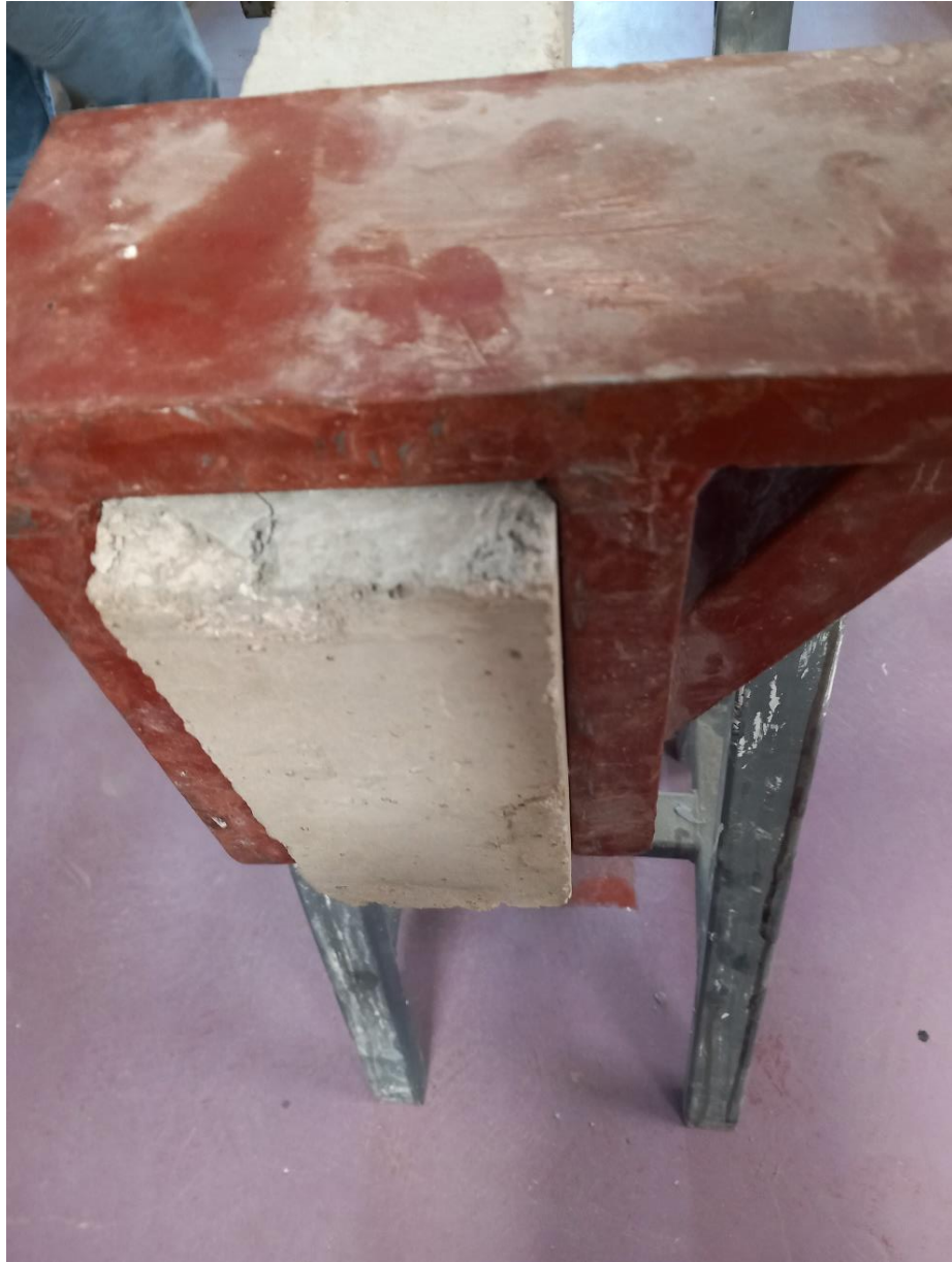
Εικόνα 3.5 Όψη του ενός άκρου της δοκού με το μπράτσο τοποθετημένο σε αυτήν.
