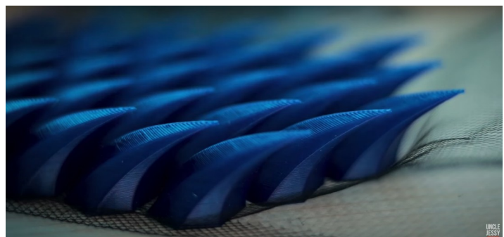
Εικόνα 49: Φανταστικά λέπια δράκου κατασκευασμένα με τρισδιάστατη εκτύπωση με εκτυπωτικό υπόστρωμα διάτρητου υφάσματος
