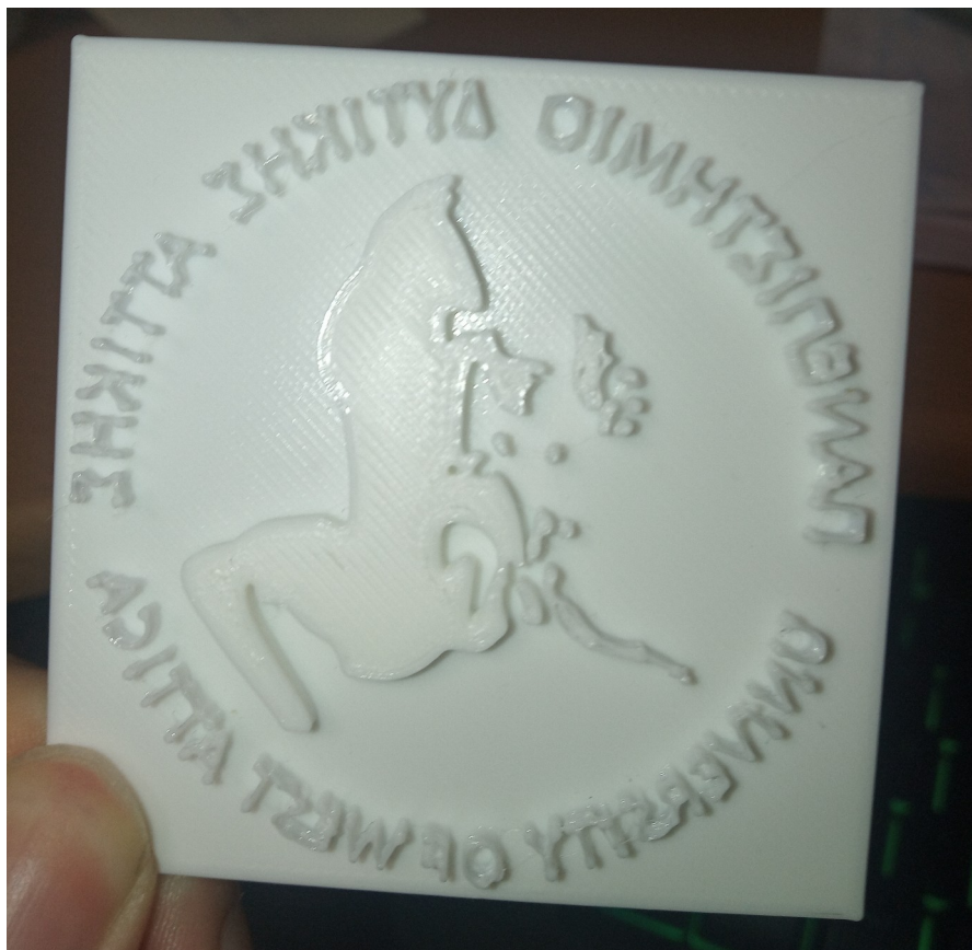
Εικόνα 105: Εκτυπωτική πλάκα από PLA και σχεδιασμένη με τεχνική trace bitmap και με συμπαγής μοντελοποίηση στο πρόγραμμα Tinkercad
