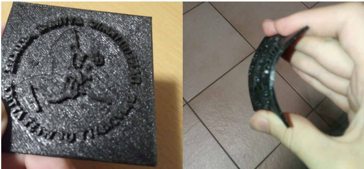
Εικόνα 102: Εκτυπωτική πλάκα από TPU που σχεδιάστηκε με υβριδική τεχνική και με solid modeling στο πρόγραμμα Tinkercad
