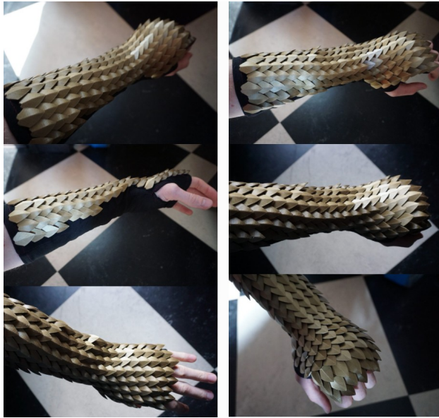
Εικόνα 50: Λέπια δράκου κατασκευασμένα με τρισδιάστατη εκτύπωση σε εκτυπωτικό υπόστρωμα διάτρητου υφάσματος. Εφαρμογή του design
