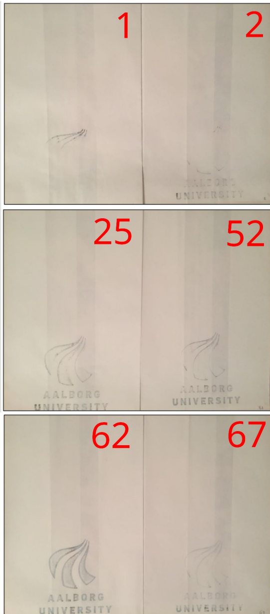
Εικόνα 63: Αποτελέσματα εκτύπωσης με την εκτυπωτική πλάκα φλεξογραφίας κατασκευασμένη με το υλικό PolyMaker της Polyflex . Με κόκκινο σημειώνεται η σειρά εκτύπωσης.
