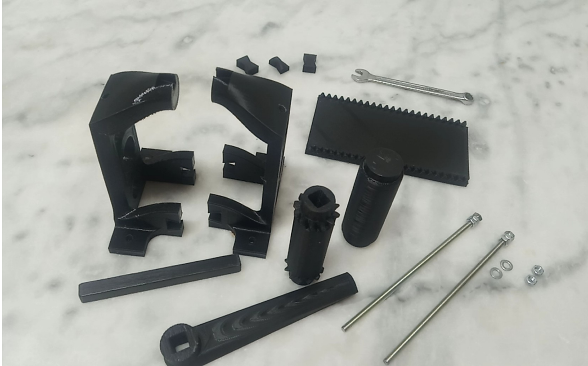
Εικόνα 110: Τα τρισδιάστατα εκτυπωμένα μέρη της πρέσας
