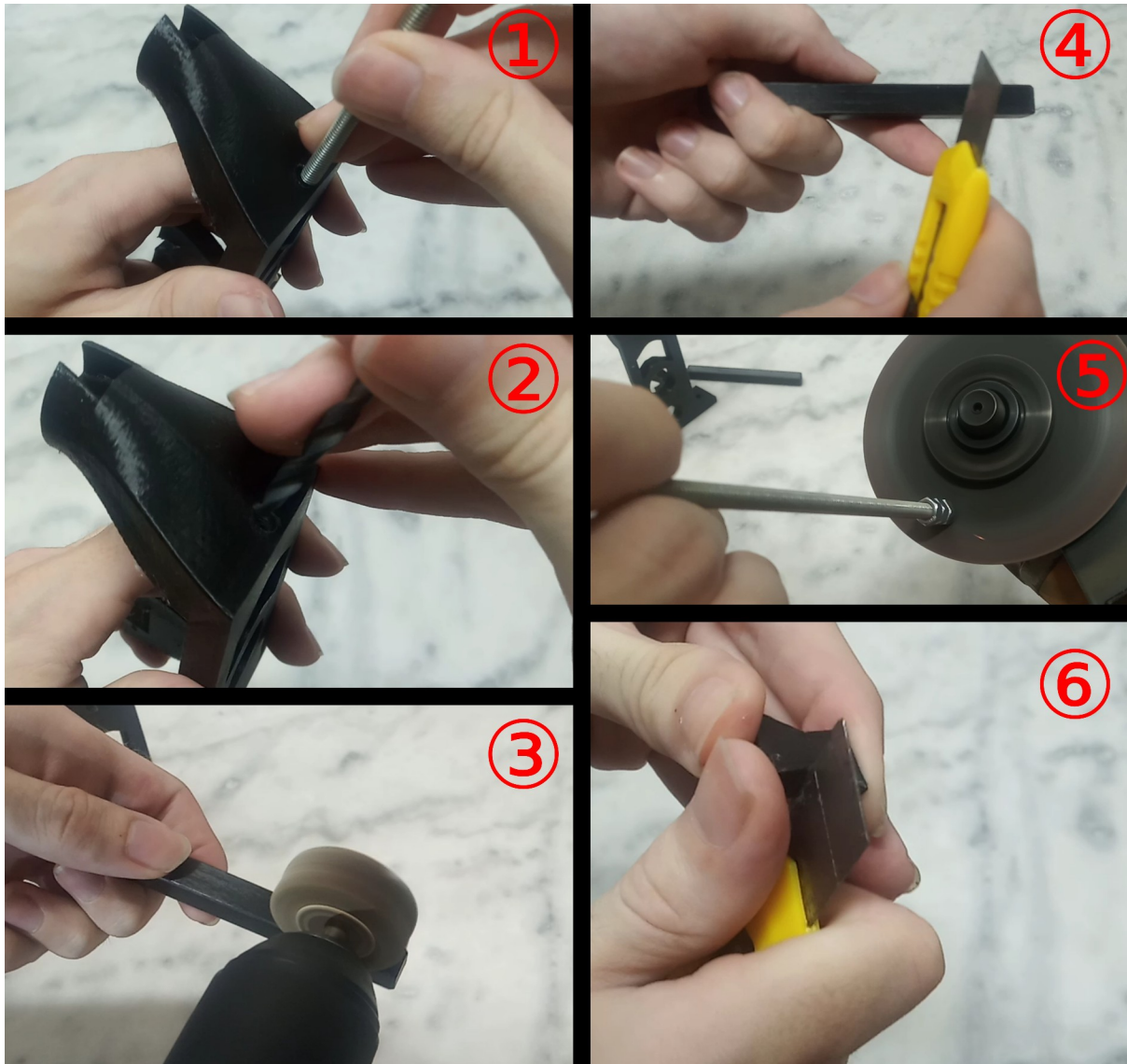
Εικόνα 111: Φινίρισμα των τμημάτων της πρέσας.
