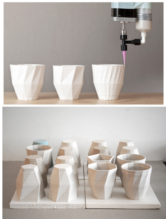
Εικόνα 29: Κούπες κατασκευασμένες με τρισδιάστατη εκτύπωση με τη χρήση κεραμικού υλικού.
