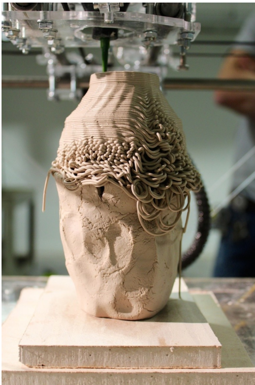
Εικόνα 28: Πειράματα τρισδιάστατης εκτύπωσης κεραμικού υλικού στο Πανεπιστήμιο Alfred
