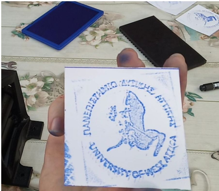
Εικόνα 118: Το καλύτερο αποτέλεσμα με την εκτυπωτική πλάκα από TPU που σχεδιάστηκε με υβριδική τεχνική και με polygonal modeling στο πρόγραμμα blender.
