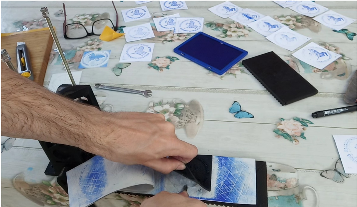
Εικόνα 120: Αφαίρεση εκτυπωτικής πλάκας με λεπτό εργαλείο
