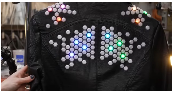
Εικόνα 52: Νιφάδες εκτυπωμένες με τρισδιάστατης εκτύπωσης και εφαρμογή σε ενδυμασία. Design της σχεδιάστριας μόδας Sophy Wong
