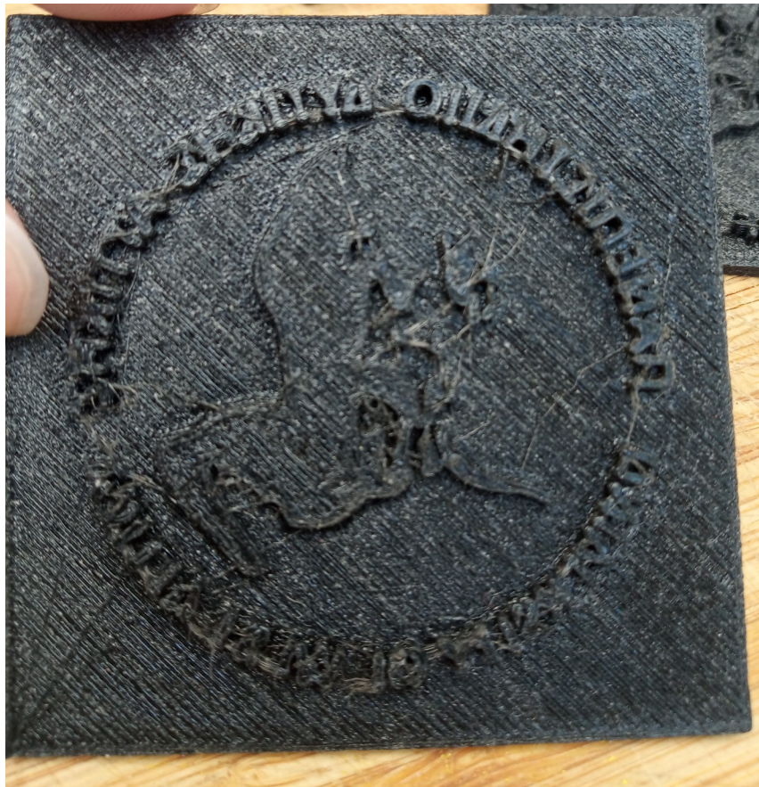
Εικόνα 106: Εκτυπωτική πλάκα από TPU που σχεδιάστηκε με υβριδική τεχνική και με solid modeling στο πρόγραμμα blender
