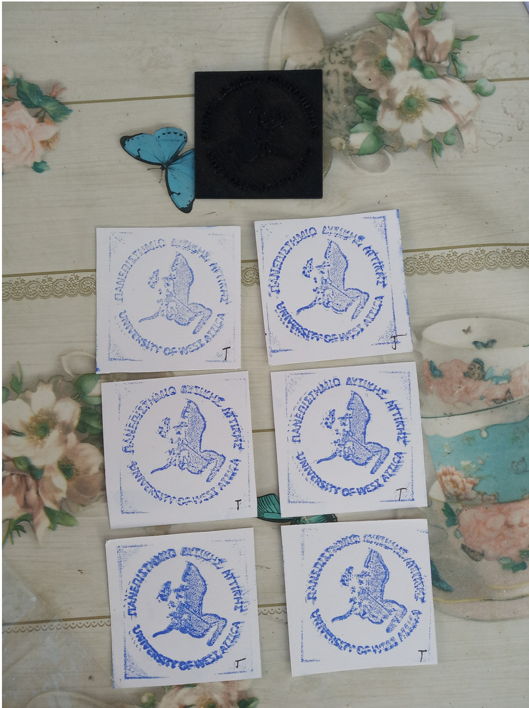
Εικόνα 119: Όλες οι εκτυπώσεις με την εκτυπωτική πλάκα από TPU που σχεδιάστηκε με υβριδική τεχνική και με polygonal modeling στο πρόγραμμα blender
