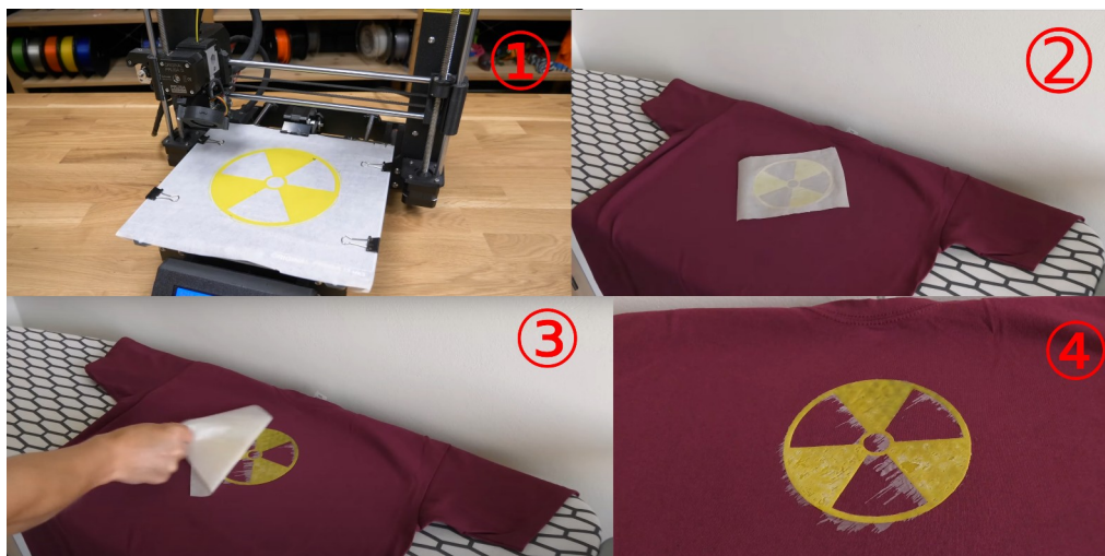
Εικόνα 66: Εκτύπωση επάνω σε ύφασμα με την χρήση τρισδιάστατης εκτύπωσης. Μέθοδος τύπου heat-transfer
