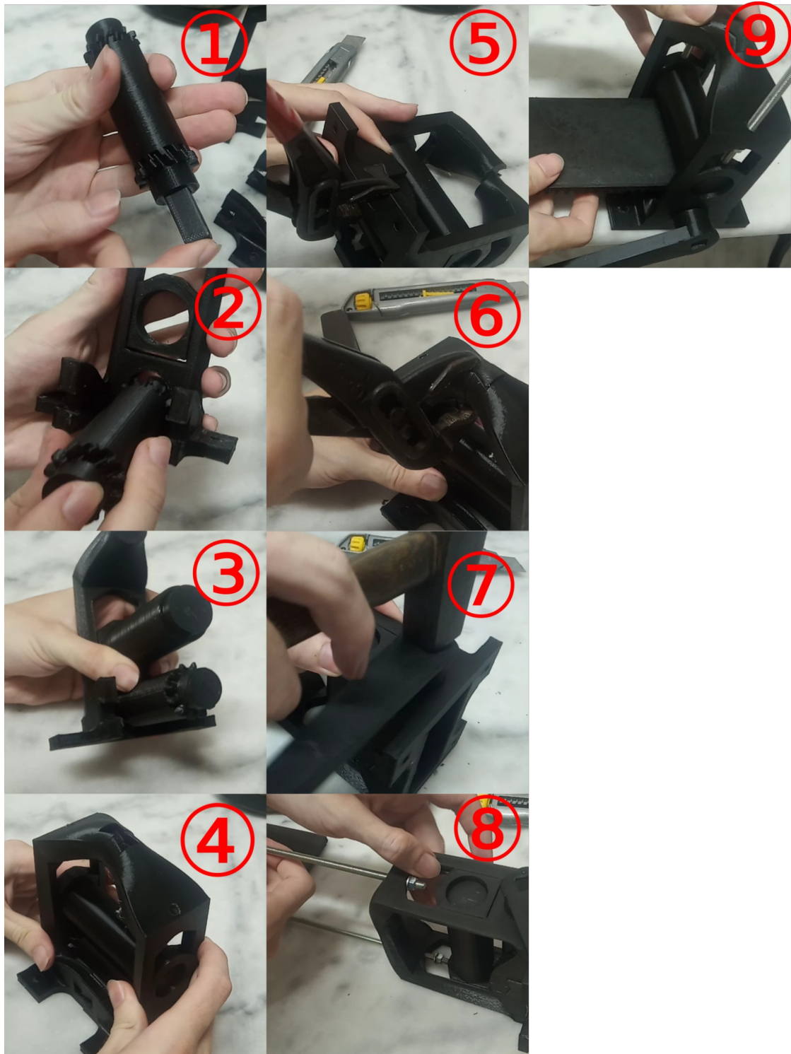
Εικόνα 112: Η διαδικασία συναρμολόγησης των τμημάτων της πρέσας
