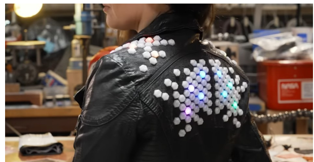
Εικόνα 53: Νιφάδες εκτυπωμένες με τρισδιάστατης εκτύπωσης και εφαρμογή σε ενδυμασία. Design της σχεδιάστριας μόδας Sophy Wong
