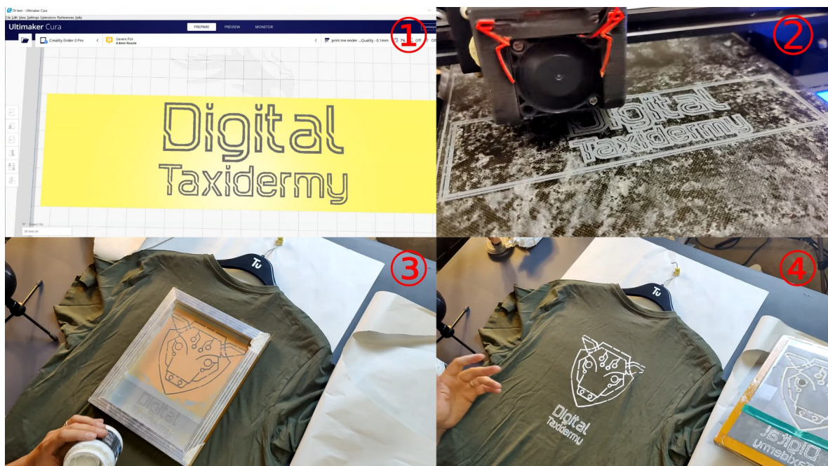
Εικόνα 64: Κατασκευή stencil μεταξοτυπίας και εφαρμογή αυτού για την εκτύπωση επάνω σε ύφασμα
