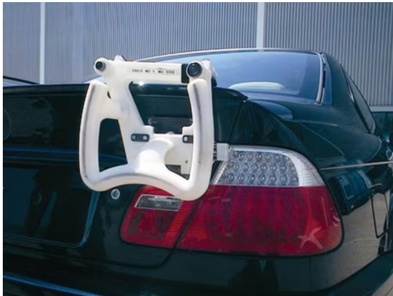
Εικόνα 17: Εργαλείο κατασκευασμένο με τεχνολογία τρισδιάστατης εκτύπωσης για την διευκόλυνση επαναλαμβανόμενων κινήσεων κατά την εγκατάσταση εξαρτημάτων σε αυτοκίνητο
