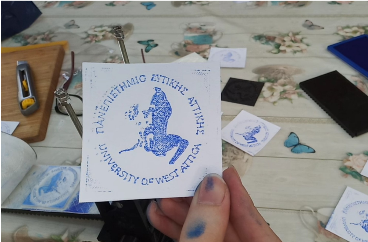
Εικόνα 116: Το καλύτερο αποτέλεσμα με την εκτυπωτική πλάκα από PLA και που σχεδιάστηκε με υβριδική τεχνική και με polygonal modeling + μεταβλητή Boolean στο πρόγραμμα Blender
