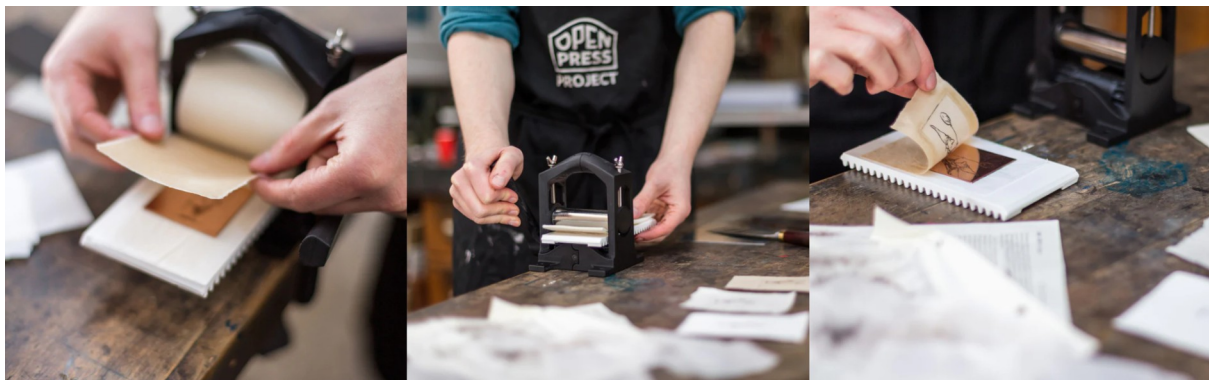
Εικόνα 69: Λειτουργικός εκτυπωτής βαθυτυπίας κατασκευασμένος με τρισδιάστατη εκτύπωση. Design του Open Press Project
