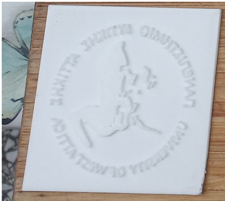
Εικόνα 104: Εκτυπωτική πλάκα από PLA που σχεδιάστηκε με υβριδική τεχνική και με solid modeling στο πρόγραμμα Blender
