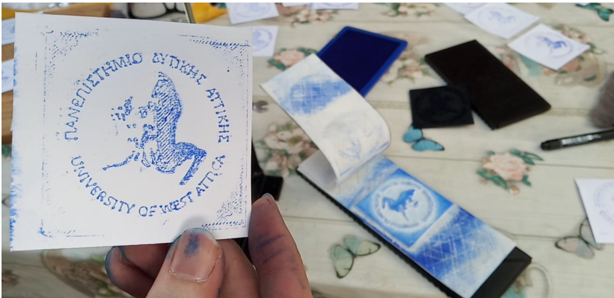
Εικόνα 122: Το καλύτερο αποτέλεσμα με την εκτυπωτική πλάκα από PLA που σχεδιάστηκε με υβριδική τεχνική και με solid modeling στο πρόγραμμα Blender.
