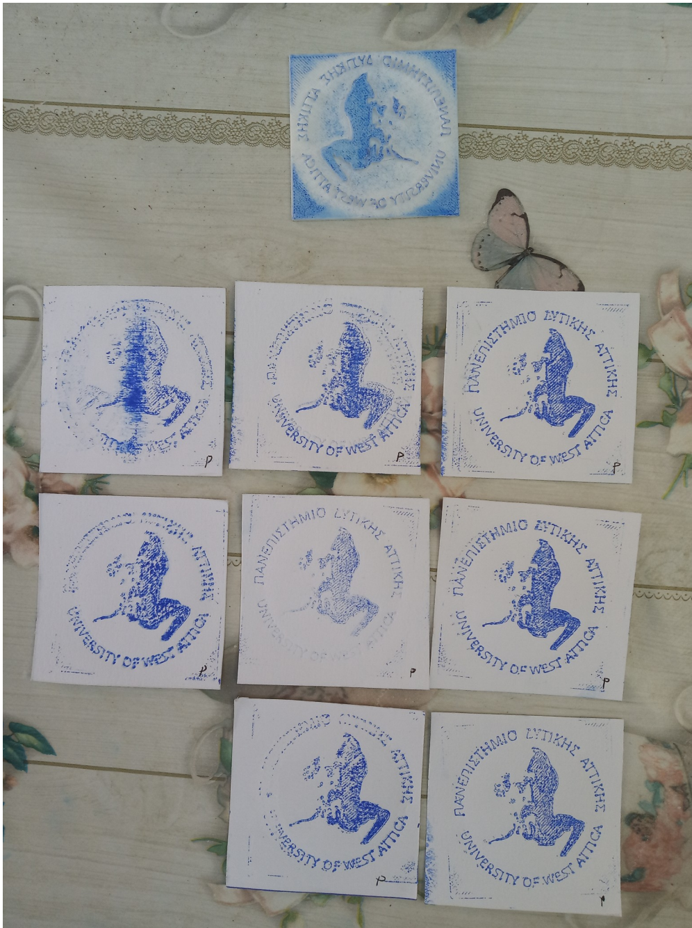
Εικόνα 117: Όλες οι εκτυπώσεις με την εκτυπωτική πλάκα από PLA που σχεδιάστηκε με υβριδική τεχνική και με polygonal modeling + μεταβλητή Boolean στο πρόγραμμα Blender
