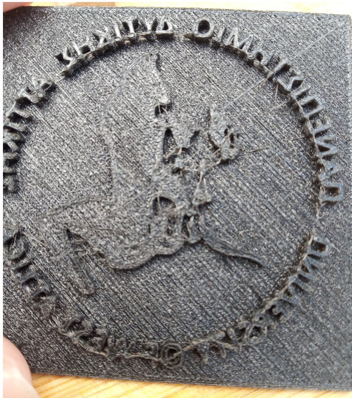
Εικόνα 107: Εκτυπωτική πλάκα από TPU και που σχεδιάστηκε με υβριδική τεχνική και με solid modeling + μεταβλητή Boolean στο πρόγραμμα Blender
