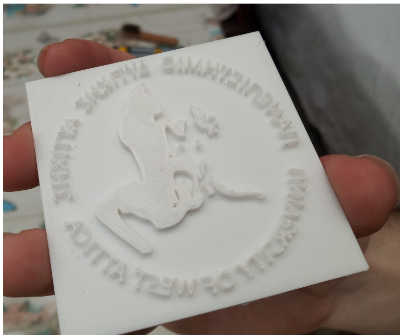
Εικόνα 103: Εκτυπωτική πλάκα από PLA που σχεδιάστηκε με υβριδική τεχνική και polygonal modeling + μεταβλητή Boolean στο πρόγραμμα Blender
