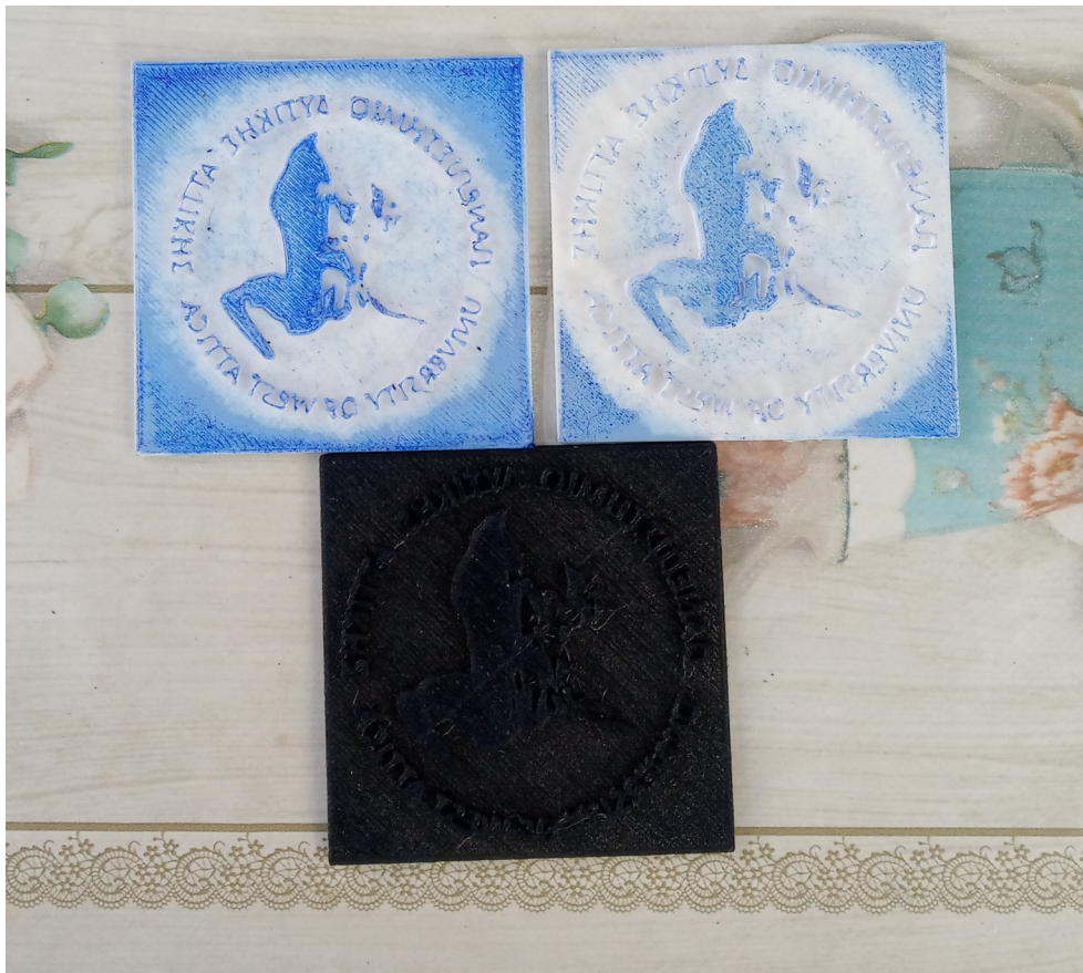
Εικόνα 109: Οι εκτυπωτικές πλάκες που χρησιμοποιήθηκαν για την εκτύπωση του λογοτύπου του Πανεπιστημίου. Η εικόνα ελήφθη μετά τη χρήση των πλακών.
