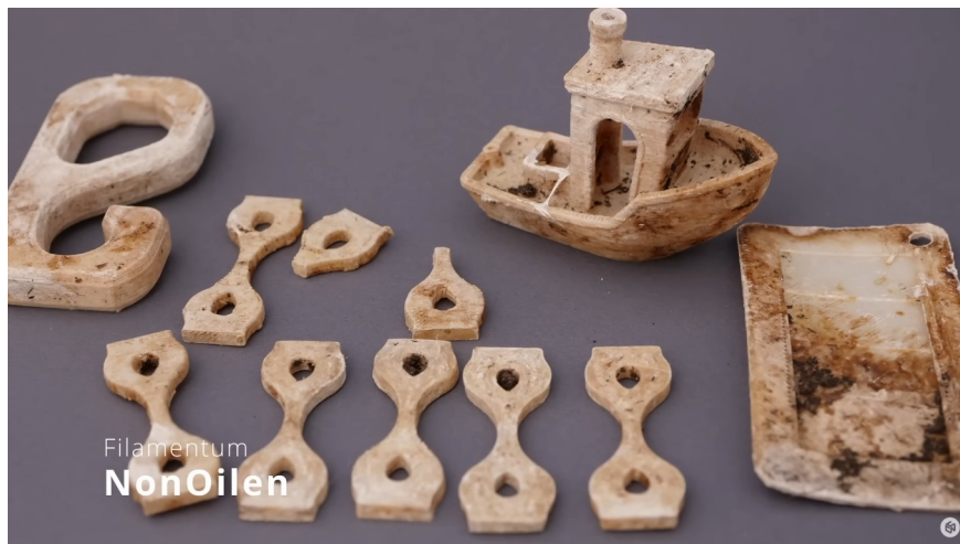
Εικόνα 31: Εξέταση της βιοδιασπασιμότητας του νήματος Nonoilen της Fillamentum μετά από 100 μέρες μέσα σε οικιακό κομποστοποιητή, από το κανάλι CNC kitchen
