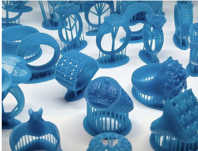
Εικόνα 45: Παραδείγματα χρήσης της τρισδιάστατης εκτυπωτικής κάνοντας χρήση των ρητινών BLUECAST X5 της εταιρίας BlueCast. Το συγκεκριμένο υλικό θα αυξήσει την αποτελεσματικότητα των διαδικασιών της τεχνική χαμένου κεριού.
