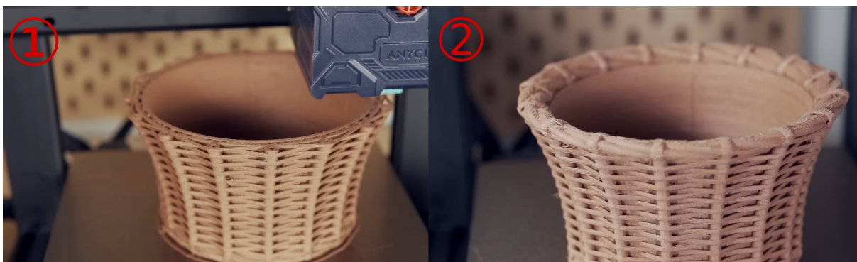
Εικόνα 35: Κατασκευή γλάστρας με νήμα τύπου ξύλου της Filamentum. Νήμα Timberfill.
