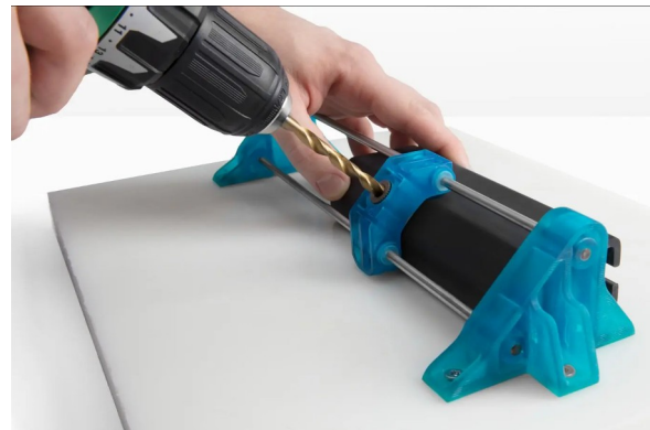
Εικόνα 18: Εργαλείο κατασκευασμένο με τεχνολογία τρισδιάστατης εκτύπωσης για την υποβοήθηση χρήσης τρυπανιού
