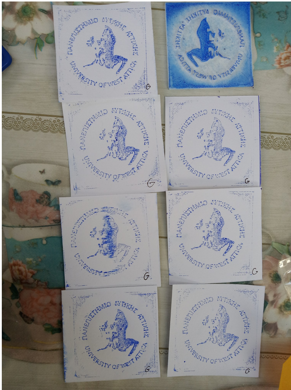
Εικόνα 123: Όλες οι εκτυπώσεις με την εκτυπωτική πλάκα από PLA που σχεδιάστηκε με υβριδική τεχνική και solid modeling στο πρόγραμμα Blender
