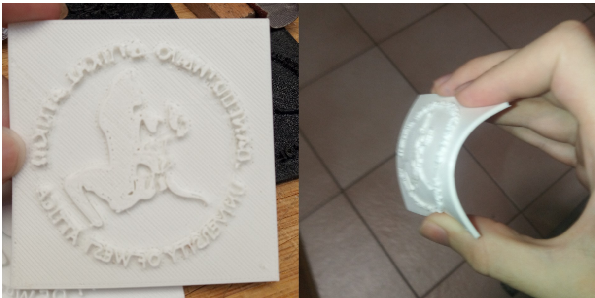
Εικόνα 101: Εκτυπωτική πλάκα από TPU που σχεδιάστηκε με τεχνική trace bitmap και με solid modeling στο πρόγραμμα Blender
