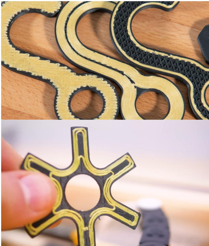
Εικόνα 38: Παράδειγμα τρισδιάστατης εκτύπωσης με ενισχυμένη συνεχόμενη ίνα. Το κίτρινο πέρασμα είναι η ενισχυμένη ίνα ενώ η μαύρη περιοχή είναι η μήτρα (matrix material).
