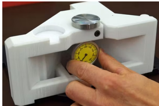
Εικόνα 20: Εργαλείο κατασκευασμένο με τεχνολογία τρισδιάστατης εκτύπωσης για την βαθμονόμηση της θέσης του
