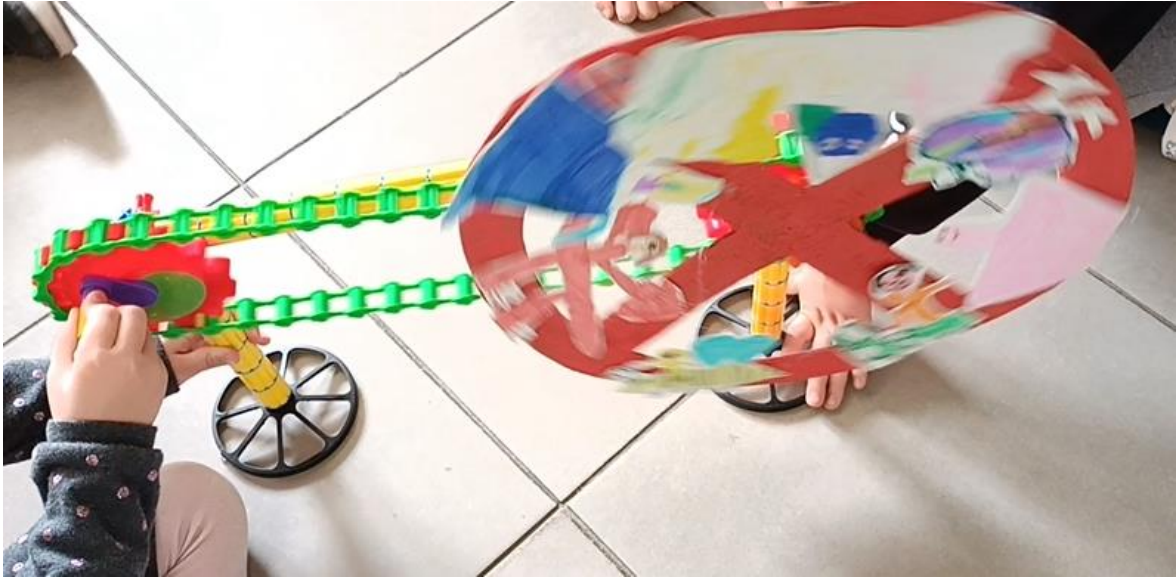
Εικόνα 54. Αντικατάσταση του γραναζιού- οδηγού με μεγαλύτερο γρανάτζι
