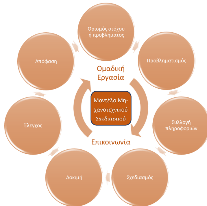
Εικόνα 2: Σχηματική αναπαράσταση του μοντέλου μηχανοτεχνικού σχεδιασμού
