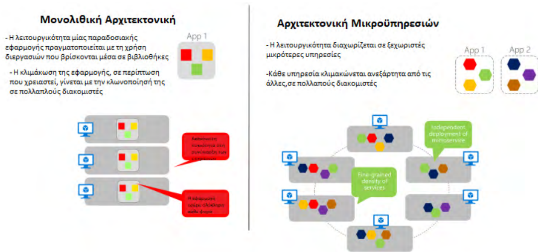
Εικόνα 3 Διαφορές μεταξύ Μονολιθικής αρχιτεκτονικής και Αρχιτεκτονικής Μικροϋπηρεσιών, πηγή: .NET Microservices Architecture for Containerized .NET Applications, Microsoft
