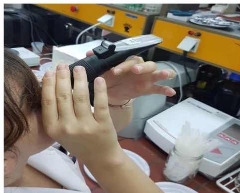
Εικόνα 3.8: Μέτρηση των βαθμών Brix σε καρπό υποφαούς με τη βοήθεια διαθλασίμετρου
