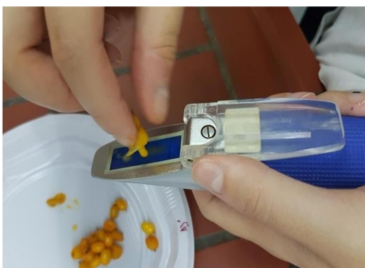
Εικόνα 3.7: προσθήκη σταγόνων υποφαούς στο διαθλασίμετρο για τη μέτρηση των βαθμών Brix
