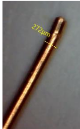
Εικόνα 3.20. Χάλκινος αγωγός διαμέτρου 272μm
