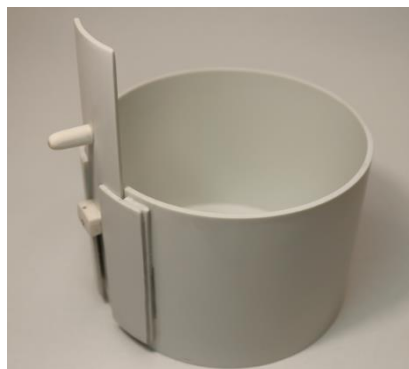
Εικόνα 3.11. Κυλινδρική περιοχή τοποθέτησης των ηλεκτροδίων του εκπομπού
