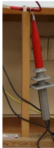
Εικόνα 3.5. Probe Υψηλής Τάσης τύπου Coline HV40B 1000:1
