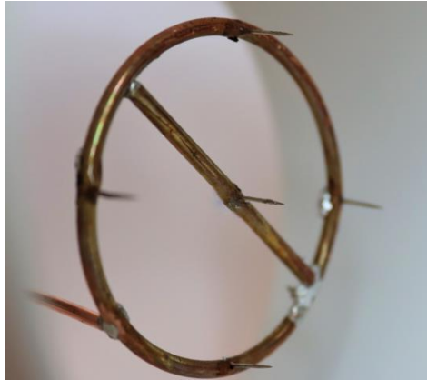
Εικόνα 3.15. Ηλεκτρόδιο με πέντε ακίδες τοποθετημένο στον θάλαμο με διάκενο 20 \text{ mm}
