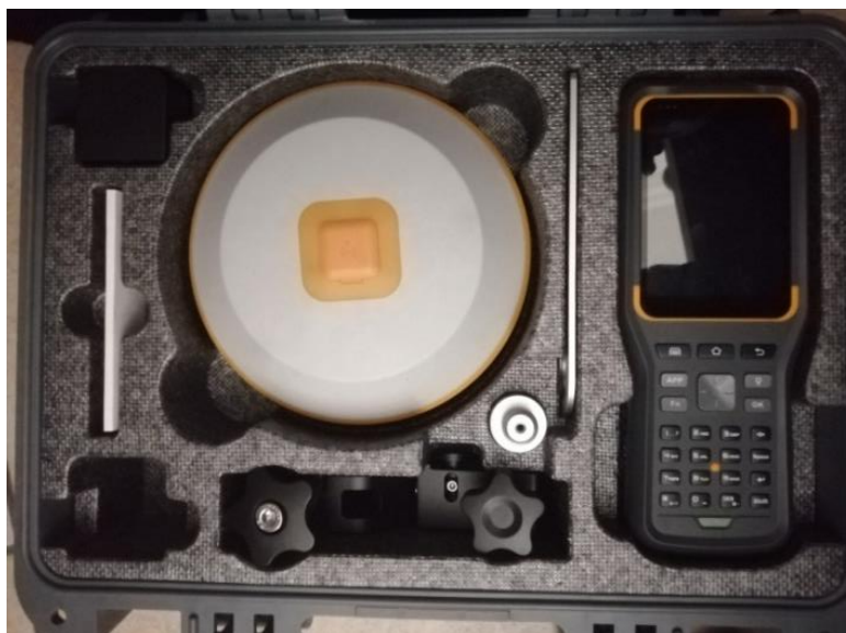
Εικόνα 3.2: Δέκτης-κεραία και χειριστήριο που χρησιμοποιήθηκαν για τις μετρήσεις.
