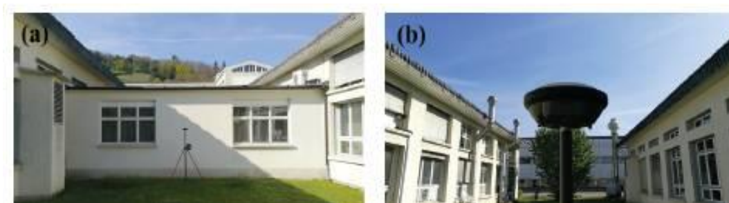
Εικόνα 2.12 : Το περιβάλλον μετρήσεων με επίδραση multipath (Πηγή: https://www.gpsworld.com/how-galileo-benefits-high-precision-rtk/ )
