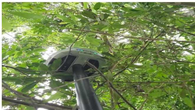
Εικόνα 2.10 : Δέκτης GNSS κάτω από πυκνές φυλλωσιές (Πηγή: https://www.gpsworld.com/how-galileo-benefits-high-precision-rtk/ )
