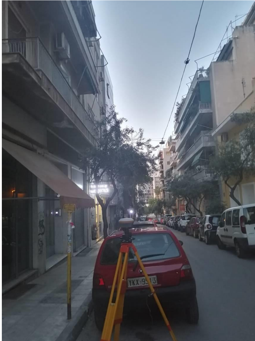
Εικόνα 6.1: Δέκτης ανάμεσα σε κτίρια (Περιοχή Αμπελοκήπων)
