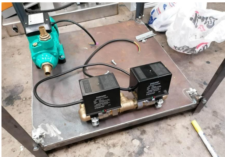
Εικόνα 36: Τοποθέτηση ηλεκτροβανών και αντλίας στο πάτωμα.
