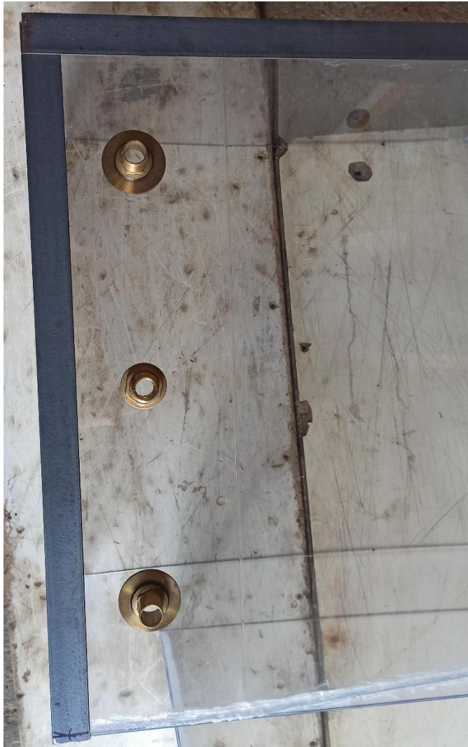
Εικόνα 11:Κατασκευή περιγραμμάτων των δεξαμενών.
