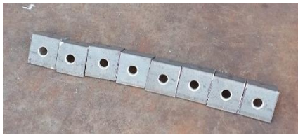
Εικόνα 20 : Κατασκευή γωνιών ένωσης περιγραμμάτων με τα πόδια.
