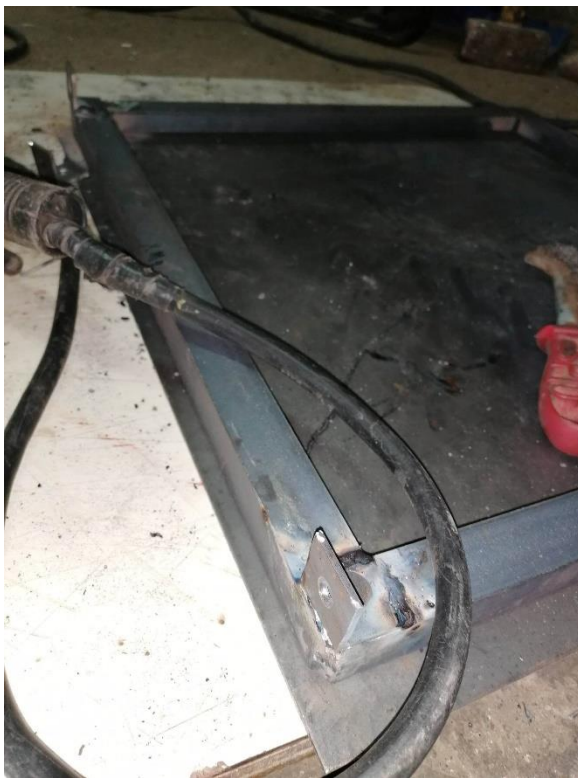
Εικόνα 21 : Κόλληση γωνιών στα περιγράμματα.
