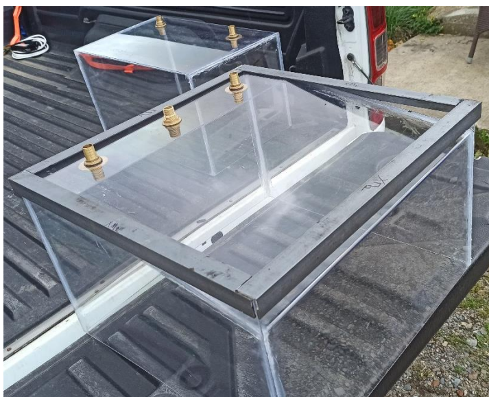
Εικόνα 14: Δοκιμή εφαρμογής περιγράμματος στη δεξαμενή.
