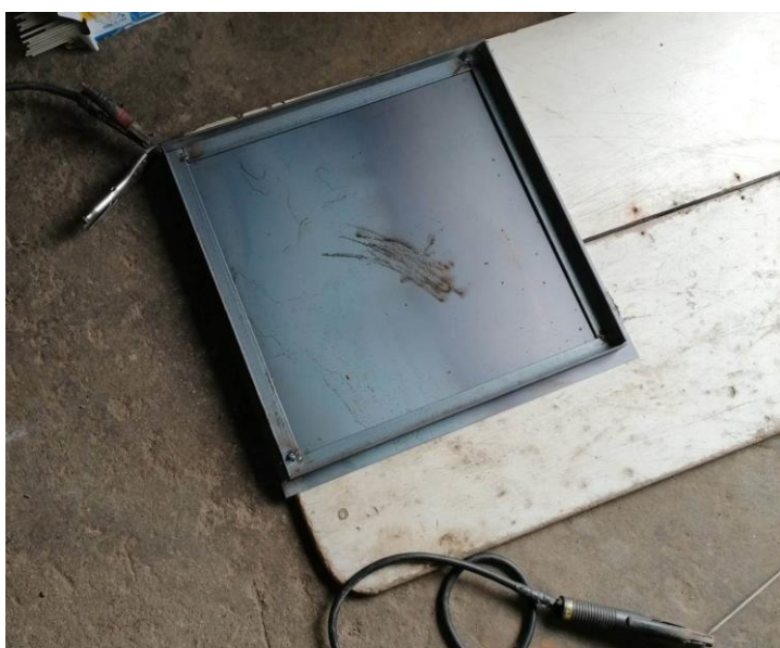
Εικόνα 15: Διαδικασία κόλλησης περιγραμμάτων των δεξαμενών.
