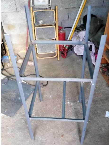
Εικόνα 22 : Συναρμολόγηση των επιπέδων των δεξαμενών με τα πόδια στήριξης.
