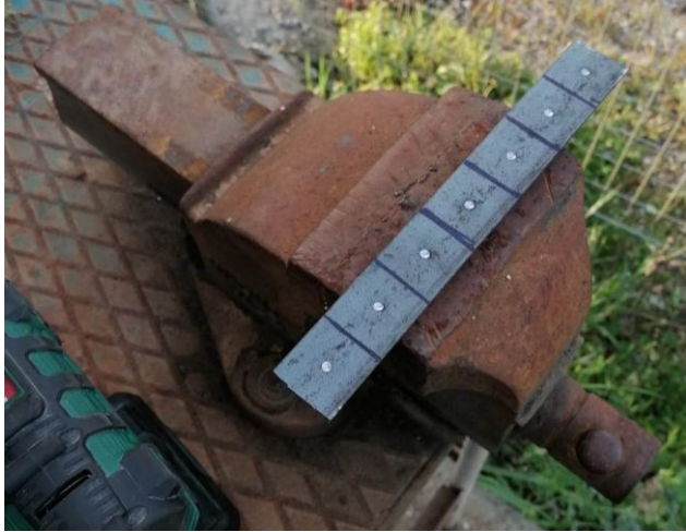
Εικόνα 20 : Κατασκευή γωνιών ένωσης περιγραμμάτων με τα πόδια.
