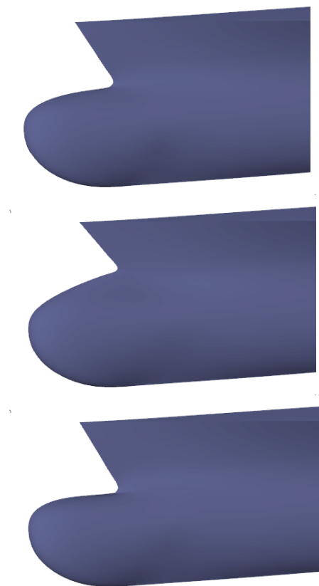
Εικόνα 88: Πλώρη μοντέλου με αρχική τιμή παραμέτρου H_{top} (πάνω), μεγαλύτερη τιμή (μέση) και μικρότερη τιμή (κάτω).
