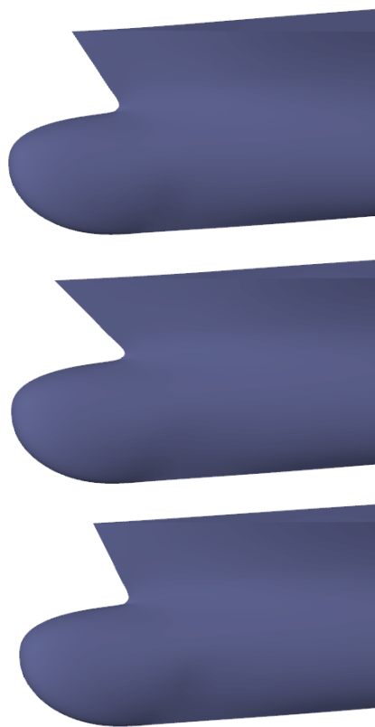
Εικόνα 87: Πλώρη μοντέλου με αρχική τιμή παραμέτρου L_{bo} (πάνω), μεγαλύτερη τιμή (μέση) και μικρότερη τιμή (κάτω).
