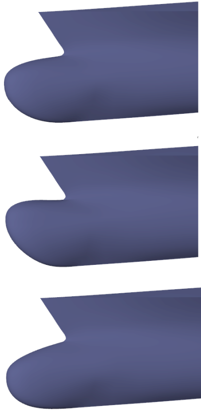
Εικόνα 89: Πλώρη μοντέλου με αρχική τιμή παραμέτρου H_{tip} (πάνω), μεγαλύτερη τιμή (μέση) και μικρότερη τιμή (κάτω).
