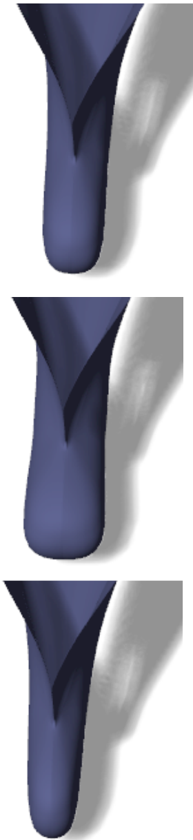
Εικόνα 90: Πλώρη μοντέλου με αρχική τιμή παραμέτρου B_w (πάνω), μεγαλύτερη τιμή (μέση) και μικρότερη τιμή (κάτω).
