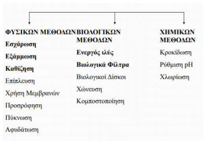
Figure 3 Κατηγορίες επεξεργασίας και επιμέρους μέθοδοι για κάθε επιμέρους κατηγορία (Metcalf, Eddy et al, 2018)
